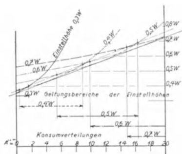
Fig. 10. Werte von X für die Konsumverteilungen A' = 0 bis A' = 20 bei verschiedenen Einstellhöhen ( 0,3 \cdot W - 0,4 \cdot W - 0,5 \cdot W - 0,6 \cdot W - 0,7 \cdot W ). Bei einer Verteilung der Gebühr zu 1/4 auf die Einstellhöhe und 3/4 auf den nach der Formel X = Y/Bst berechneten Wert X . Ordinate: X . Abszisse: Konsumverteilung.
