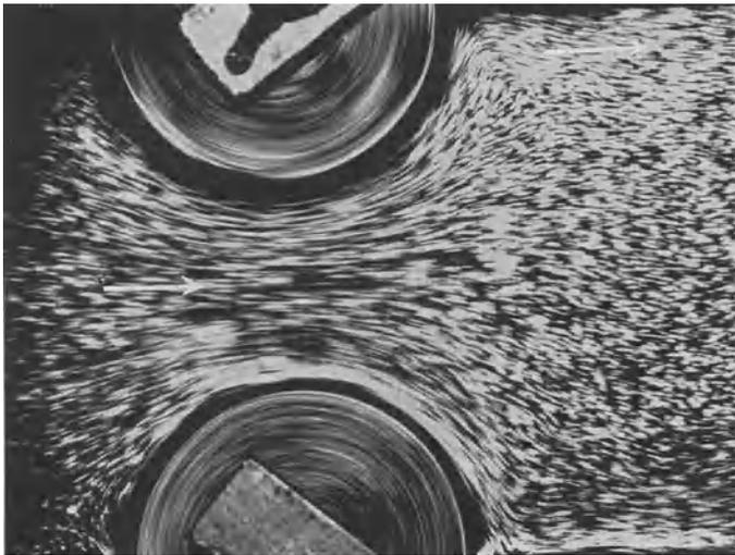
Abb. 239. Walzen drehen sich in Richtung der Strömung. Strömung liegt überall an.
