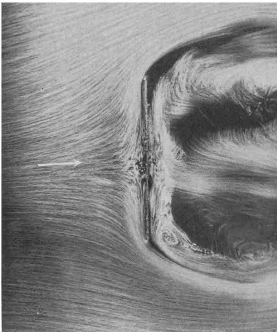
Abb. 243. Strömung um eine senkrecht angestellte Platte.
