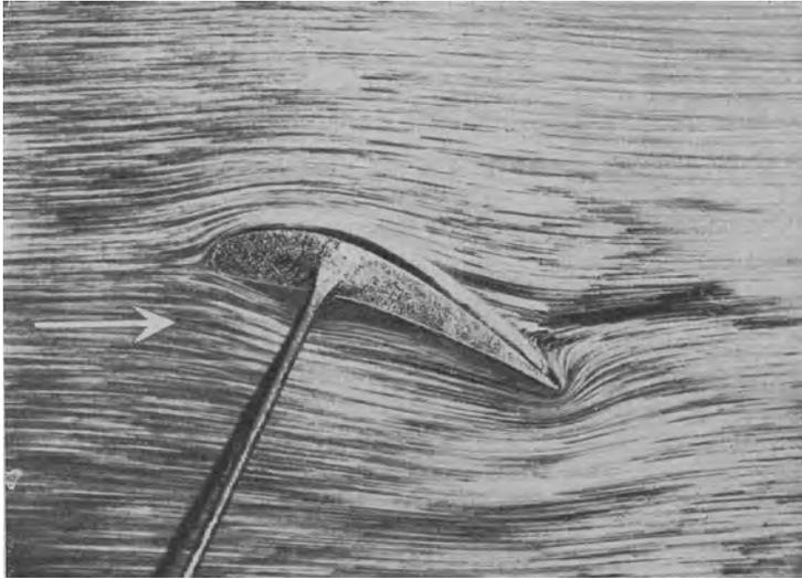
Abb. 207. Reibungsfreie Umströmung eines Tragflügels.
