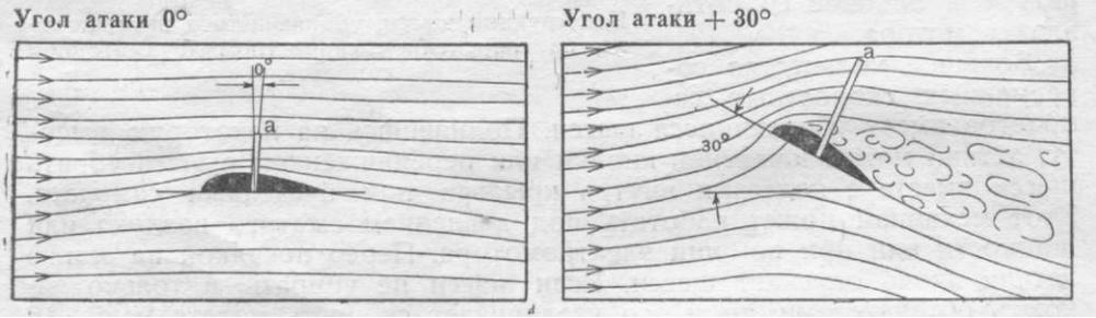
Наиболее плотное обтекание потоком воздуха. Подъемная сила имеется, несмотря на нулевой угол атаки
