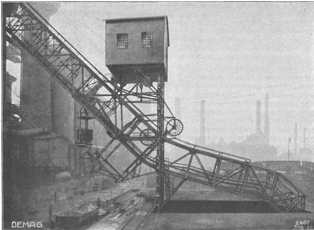
Fig. 33. Sicherheitswagen beim Schrägaufzug „Stähler-Benrath“. (Deutsche Maschinenfabrik A.-G., Duisburg.)
