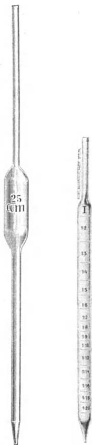
Abb. 49 u. 50. Voll- und Meßpipetten.
