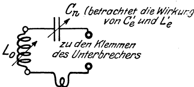
äquivalenter geschlossener Antennenkreis
