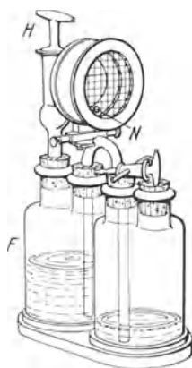
Abb. 21. Gerät zum Sichtbarmachen der Bahnen der einzelnen Alphateilchen nach Wilson.
