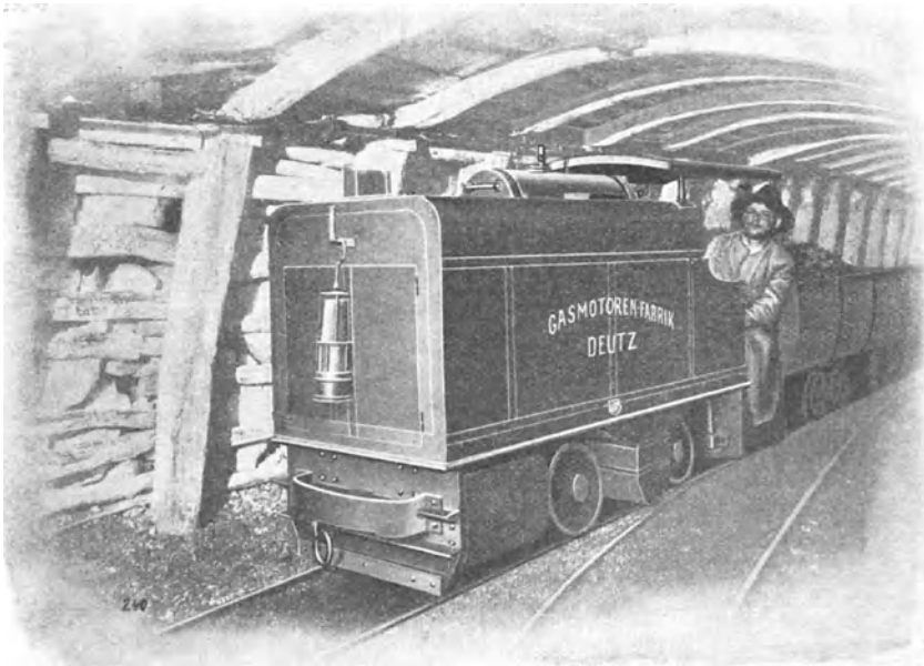
Fig. 111. 8pferdige Benzinlokomotive der Gasmotorenfabrik Deutz.
