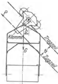
Fig. 195. Anbringung des Kuppelapparates am Laufwerk bei untenliegendem Seil.
