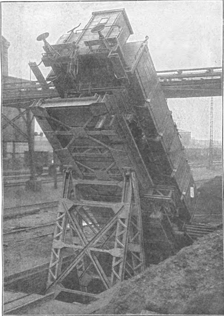
Fig. 81. Niveaukipper mit Kniehebelantrieb. Maschinenfabrik Augsburg-Nürnberg.
