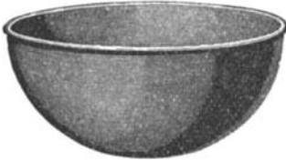
Abb. 1. Säurebeständig über den Rand emaillierte Laboratoriumschale.
