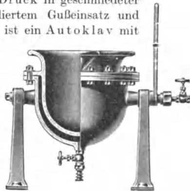
Abb. 31. Gußeisernes Doppelkesselchen mit Hand-Kippvorrichtung; der Innenkessel säurebeständig emailliert.
