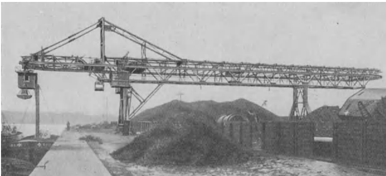
Abb. 225. Verladebrücke mit ringförmiger Bahn für zwei Führerstand-Greiferkatzen (Demag).
