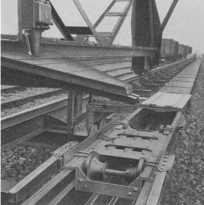
Abb. 189. Stromabnehmer-Wagen für unterirdische Zuleitung (Bauart Elektrotechnische Industrie Duisburg).
