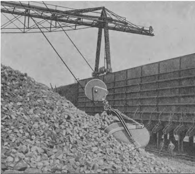
Abb. 9. Materialaufnahme mit Schürfkübel.
