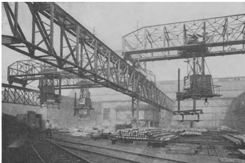
Abb. 219. Hochbahnkrane mit drehbarem Pratzengehänge (Demag).
