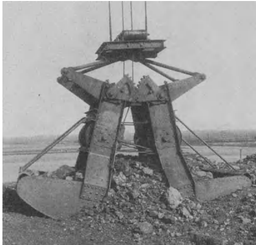
Abb. 48. Greifer von Weigner, Bauart Simmering, Wien.
