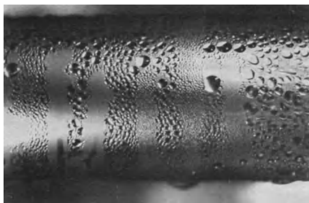
Abb. 6. Reine Tropfenkondensation an einem verchromten und polierten Stahlrohr [Maßstab etwa 2:1].
