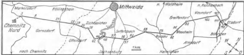
Abb. 101. Kartenskizze der Freileitung Chemnitz-Nord—Etdorf (Maßstab 1:250 000).
