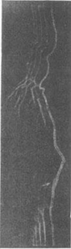
Abb. 76. Überschlag am Funkeninduktor, Aufnahme von Walter mit rotierender Kamera.
