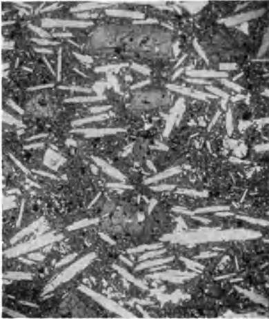
Abb. 332. Basalt aus Puy-de-Dôme, Frankreich. Einsprenglinge von Augit (mit Spaltrissen), Olivin und Labrador in einer dichten Grundmasse. Alle Einsprenglinge sind vollkommen idiomorph. Vergrößerung  $20\times$ . I. Nicol.
