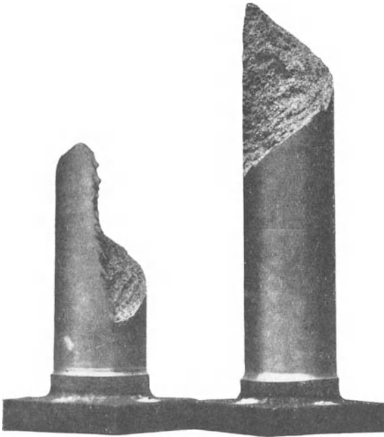
Abb. 128. Bruchform einer spröden Drehprobe.
