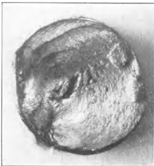
Abb. 129. Bruchform einer zähen Drehprobe.
