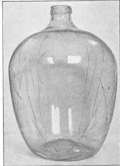
Abb. 171. Auf Wasserdruck beanspruchtes Gefäß mit Längsrissen.
