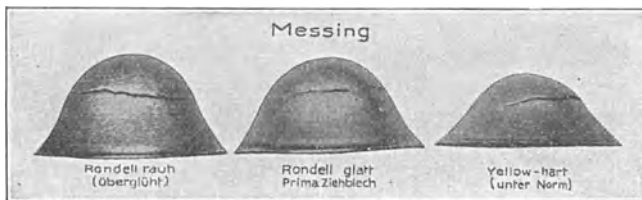
Abb. 165. Mit Erichsen-Apparat geprüfte Bleche.
