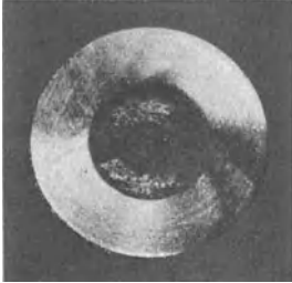
Abb. 71. Bruchfläche eines eingedrehten Stabes.
