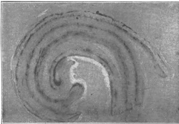
Abb. 202. Baummannscher Schwefelabdruck von Schweißeisen.
