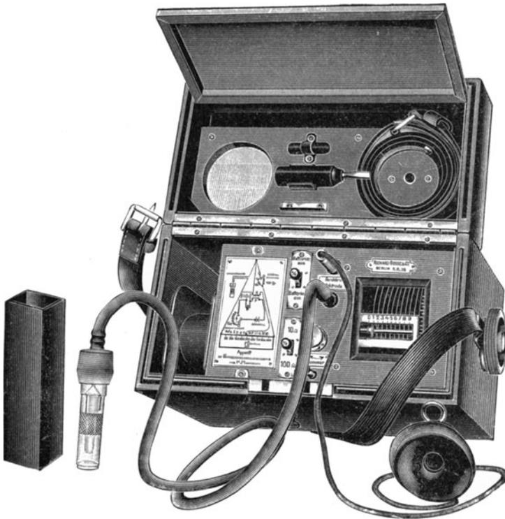
Abb. 123. Handlicher Apparat zur Messung des elektrischen Leitvermögens von Wässern. (Nach Pleißner.)
