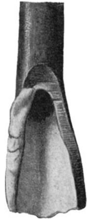
Abb. 165. Bleirohr, in dem sich eine Schutzschicht von Kalziumkarbonat gebildet hat.
