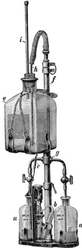
Abb. 190. Entnahmeapparat für Wasserproben zwecks Bestimmung des gelösten Sauerstoffs.
