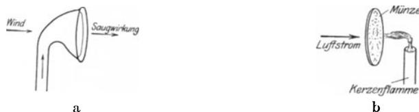
Abb. 77. Wirkung der Luftströme auf Sauger. (Nach Wolpert.)
