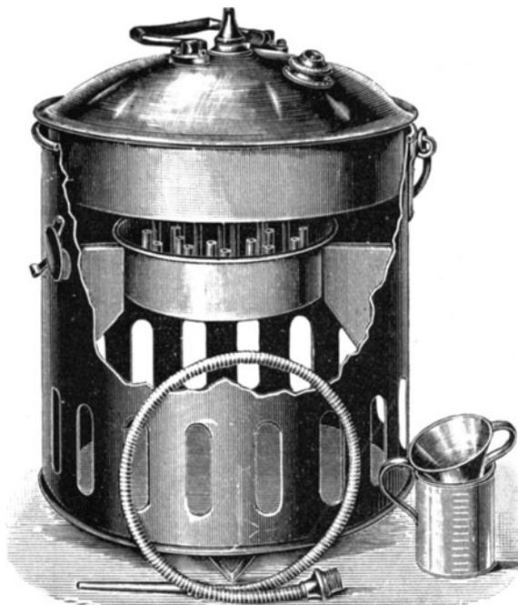
Abb. 63. Breslauer Formaldehyd-Apparat nach Flügge. (Deutsche Desinfektions-Zentrale.)
