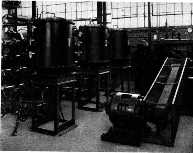
Abb. 11. Wasserstofftrocknungsanlage der Silica Gel Corporation.
