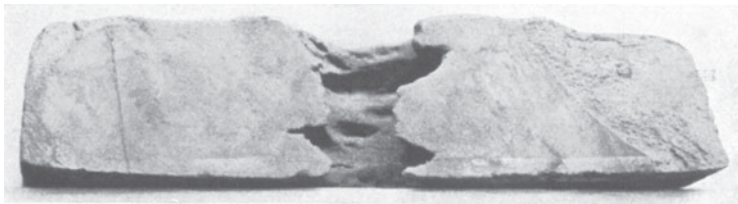
Abb. 252. Zerfressenes Gewinde einer Anode.
