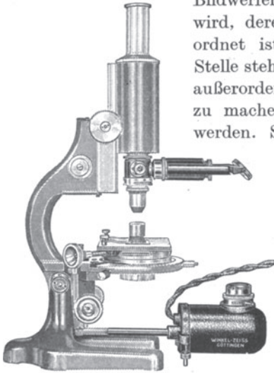
Abb. 173. Beleuchtung mit Glühlämpchen von Winkel-Zeiss.
