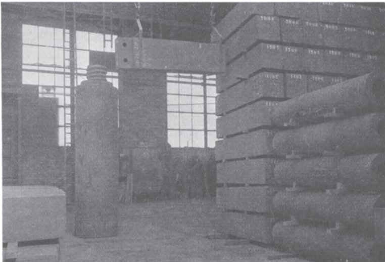
Abb. 121. Abfahren einer Elektrode vom Lager.
