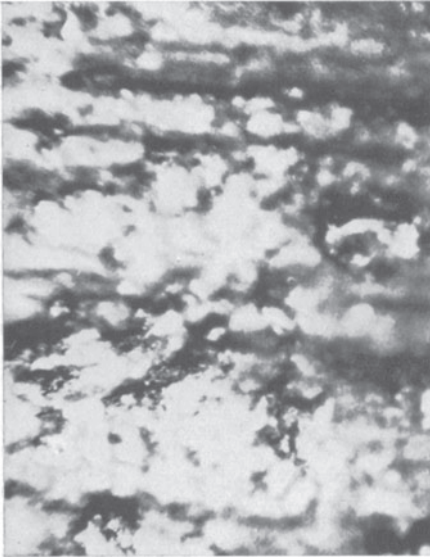
Abb. 305. Kupferbürste CuI (Gebr. Siemens). V = 88 .
