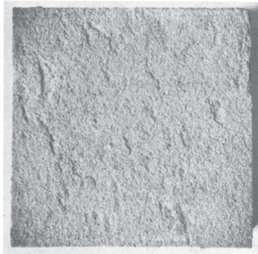
Abb. 254. Ungetränkte Graphitanode nach 151 Ah bei 60°.
