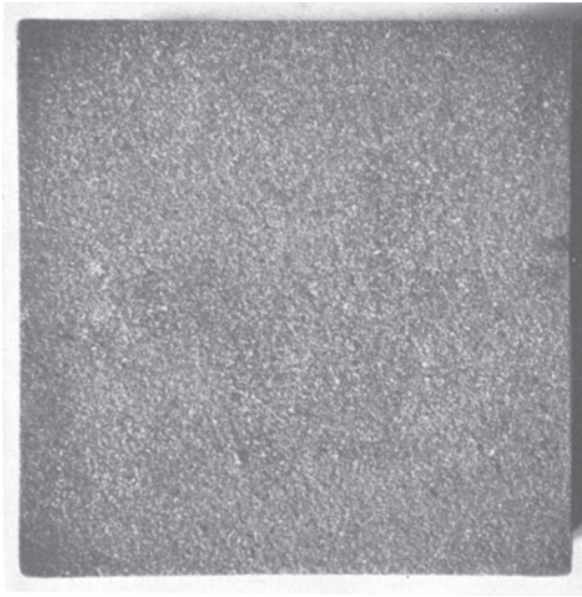
Abb. 253. Mit Panmex getränkte Graphitanode nach 151 Ah bei 60°.
