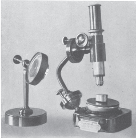
Abb. 160. Mikroskop mit Kugelgelenk; Gegenstand auf Kugelschale.
