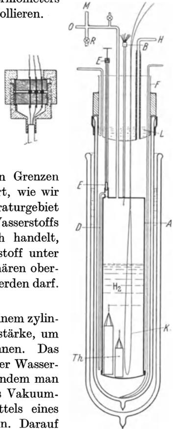
Abb. 109. Wasserstoffdruckkryostat (nach KEESOM und LISMAN).
