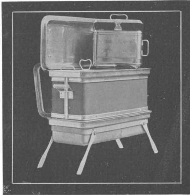
Fig. 79. Kleiner Sterilisator für Verbandzeug. Der Apparat wird mit Gas, Petroleum, Spiritus, auf einem Kochofen usw. erhitzt. Der unterste Teil enthält das kochende Wasser, welches den Dampf zum Desinfizieren des Verbandzeugs liefert. Dieser Teil ist getrennt zum Kochen von Instrumenten verwendbar. Der Verschlußdeckel ist teilweise sichtbar. Der obere Teil enthält zwei viereckige Verbandbüchsen mit Schiebern und Gittern. Der Boden ist perforiert, um Dampf durchzulassen. Ist genügend Dampf durchgelassen worden, so wird die Dampfzufuhr abgeschlossen (durch Verschluß der Öffnungen), und das Verbandzeug kann durch weitere Überhitzung zum Trocknen gebracht werden.
