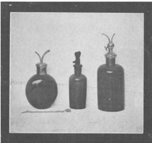
Fig. 173. Tropffläschchen, alle drei aus braunem Glas bestehend, da Chloroform und Äther durch Tageslicht zersetzt werden.
