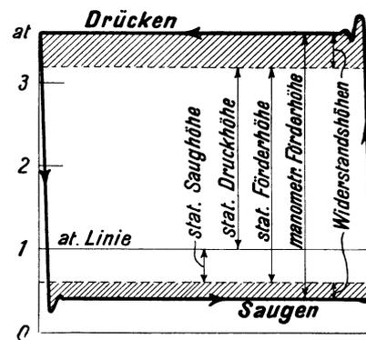
Abb. 280. Diagramm der in Abb. 278 dargestellten Pumpe.
