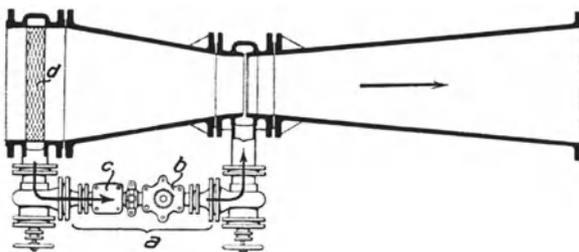
Abb. 503. Wassermessung nach dem Partial- und Teilstromverfahren.
