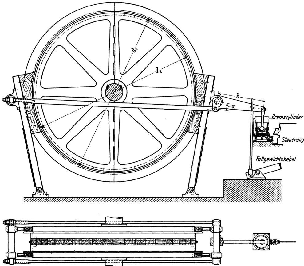
Abb. 252. Dampfbremse mit besonderem Fallgewicht.
