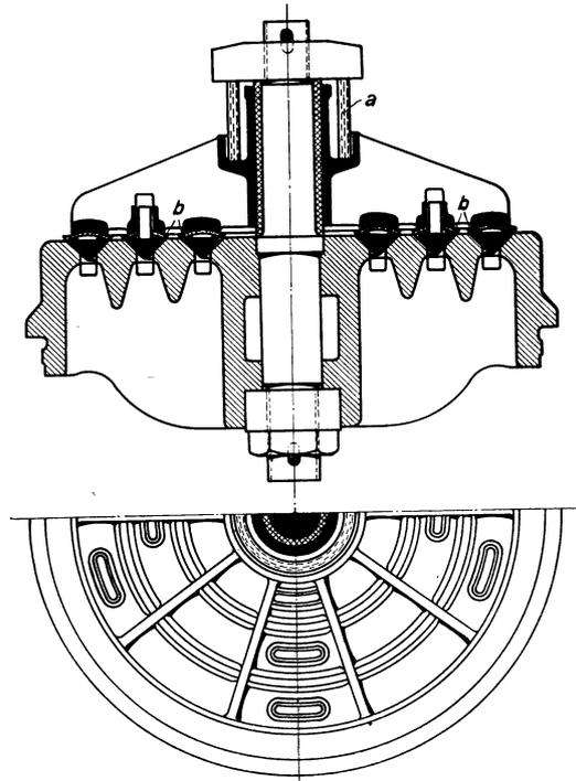
Abb. 288. Dreifaches Ringventil.
