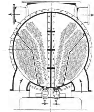
Abb. 143. Dauerbetriebskondensator der BBC.
