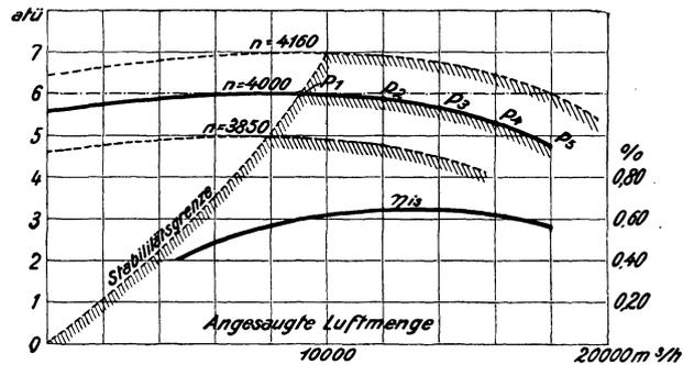
Abb. 362. Kennlinien eines Turbokompressors.
