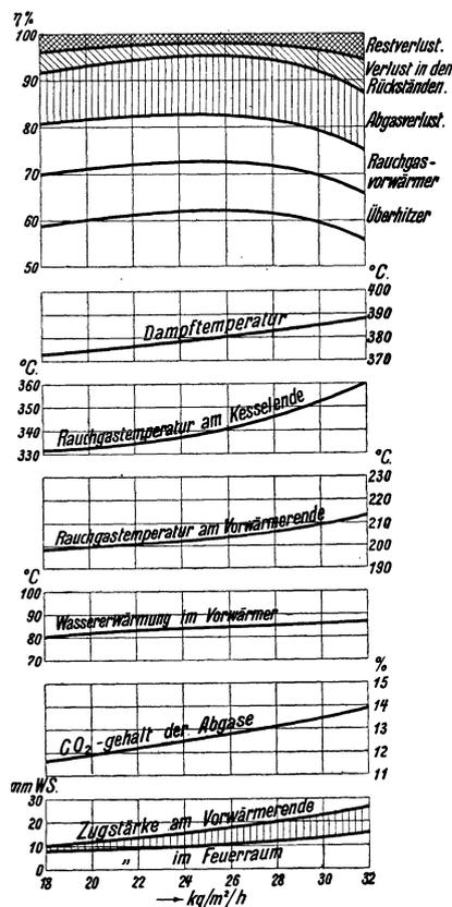
Abb. 25. Kesselwertungsgrad in Abhängigkeit von der Belastung.
