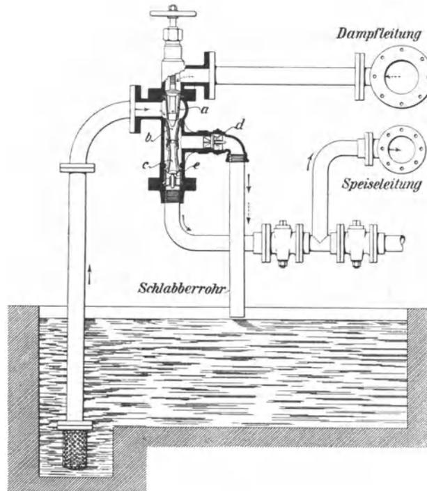
Abb. 69. Anordnung eines Injektors.
