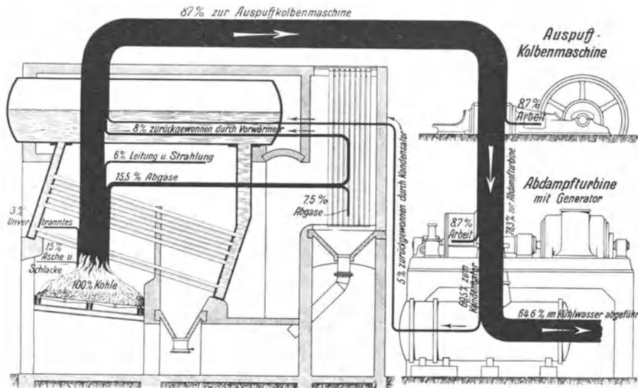
Abb. 204. Wärmestromdiagramm einer Dampfkraftanlage mit Abdampfturbine.
