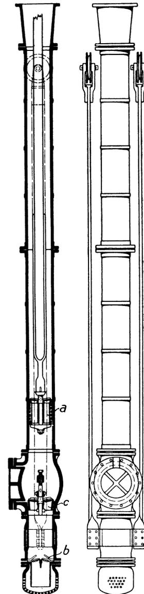
Abb. 294. Hubpumpe einer Gestängewasserhaltung.
