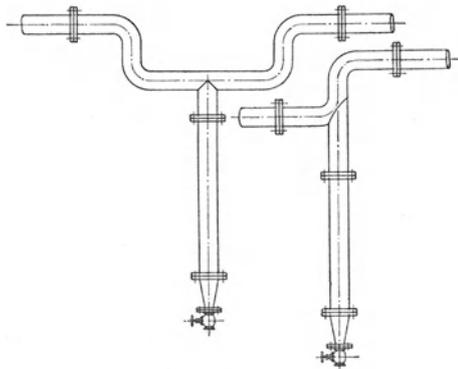
Abb. 367. Entwässerung von Druckluftleitungen.
