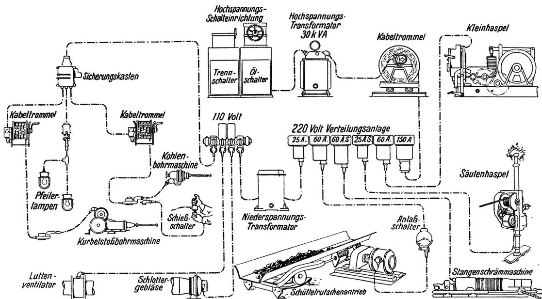
Abb. 485. Überblick über die vor Ort anwendbaren elektrischen Antriebe.
