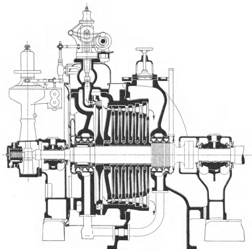
Abb. 174. Dampfturbine der AEG.
