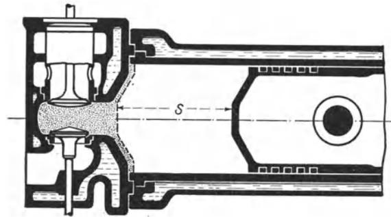
Abb. 85. Verdichtungsraum eines Gasmaschinenzylinders.
