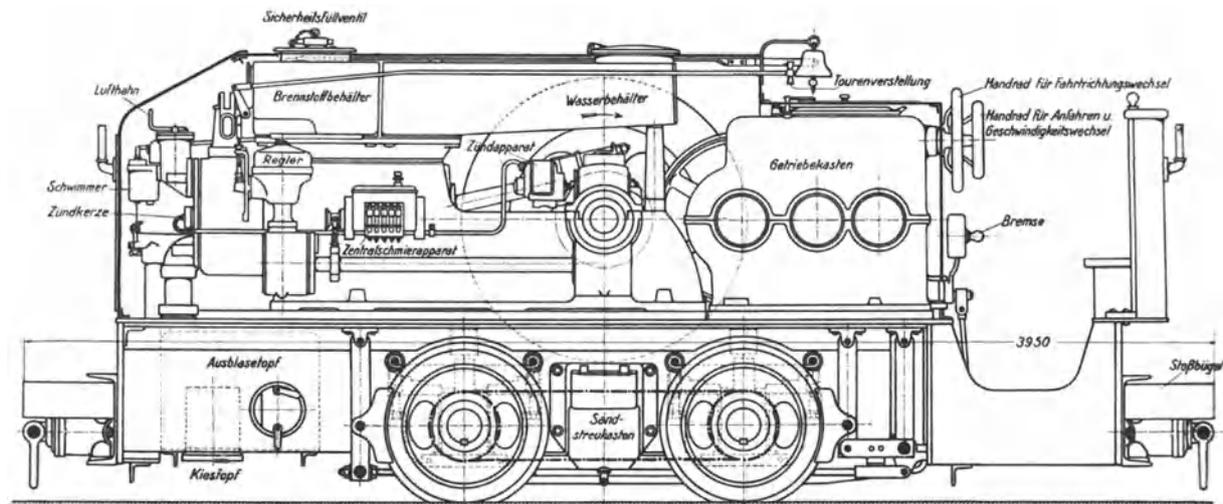
Abb. 464. Deutzer Benzolgrubenlokomotive.
