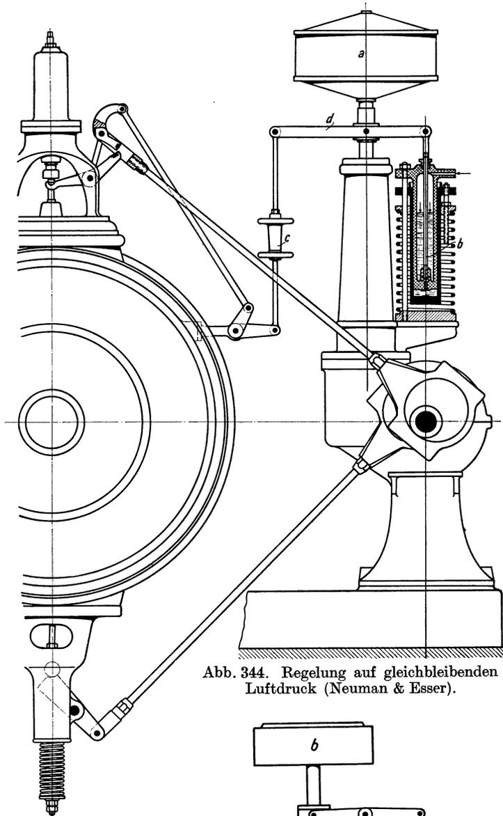
Abb. 344. Regelung auf gleichbleibenden Luftdruck (Neuman & Esser).
