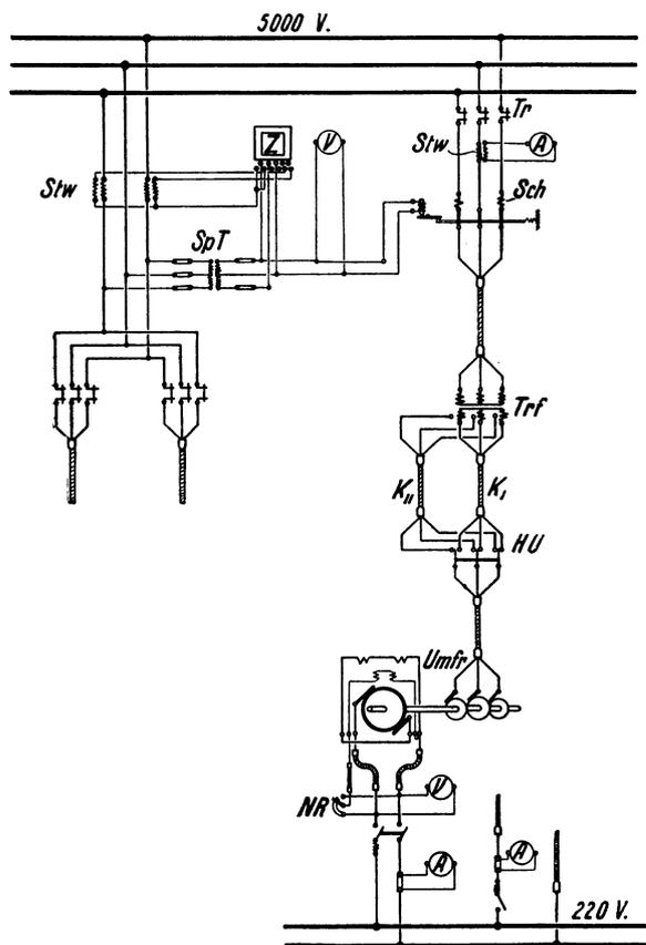
Abb. 481. Schaltplan einer Einankerumformeranlage.
