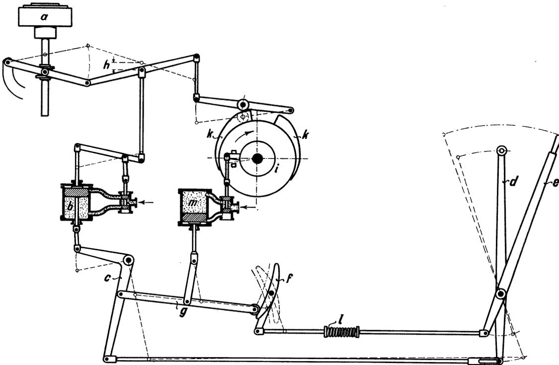
Abb. 264. Schema eines statischen Fahrtreglers.
