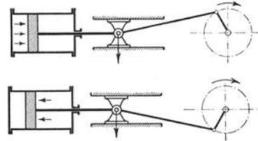
Abb. 93. Rechtslaufende Dampfmaschine.
