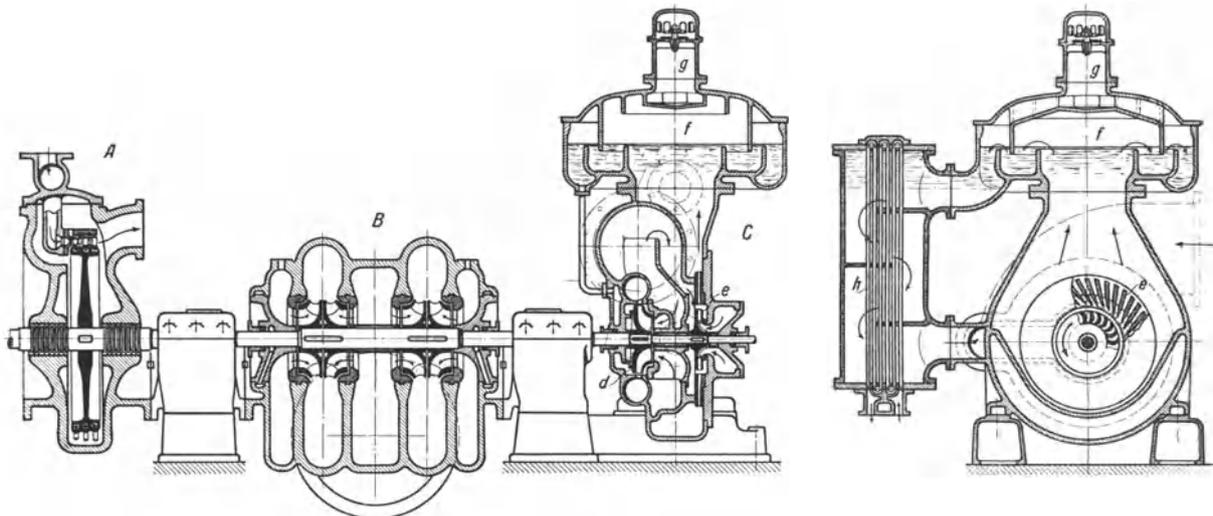
Abb. 147. Kondensationspumpen mit Antrieb durch eine Hilfsdampfturbine (AEG.).
