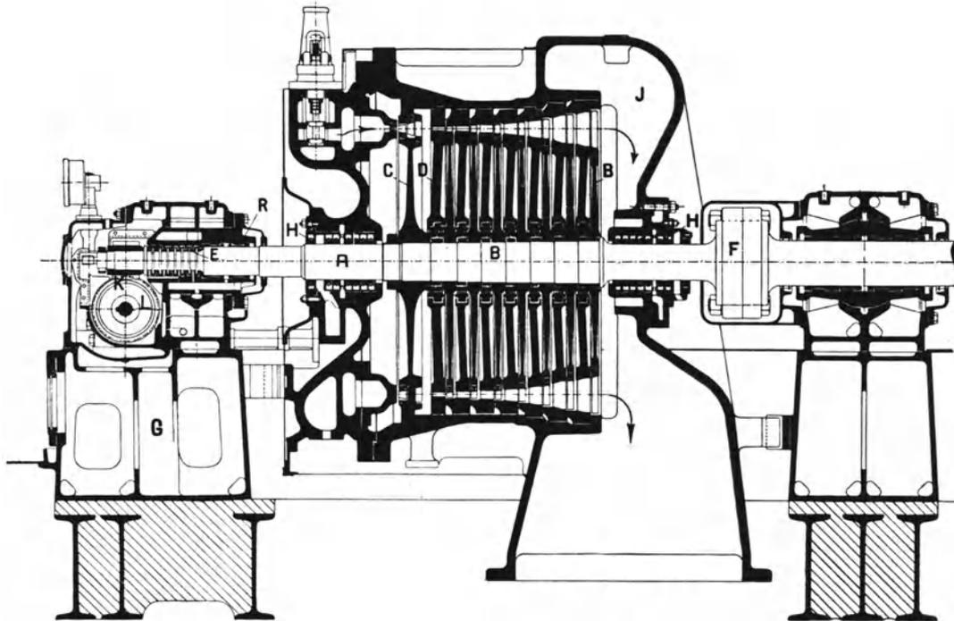
Abb. 181. MAN-Dampfturbine mit Düsenreglung.
