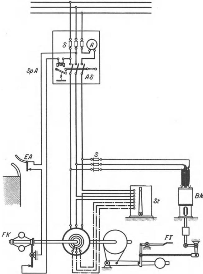
Abb. 470. Schaltplan eines Drehstromhaspels.
