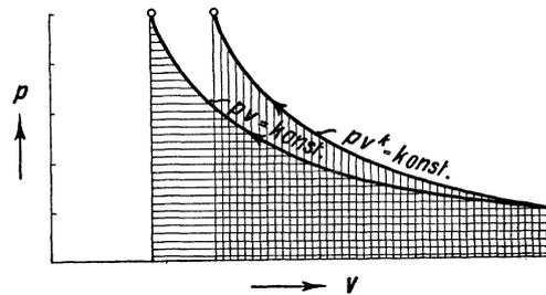
Abb. 7. Vergleich zwischen isothermischer und adiabatischer Kompression.
