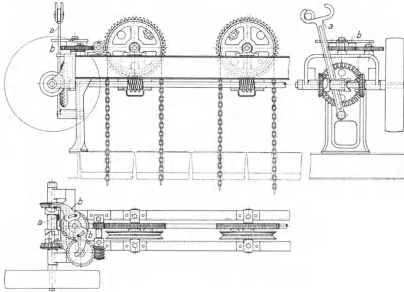
Abb. 75. Antrieb der Schaber eines Rauchgasvorwärmers.
