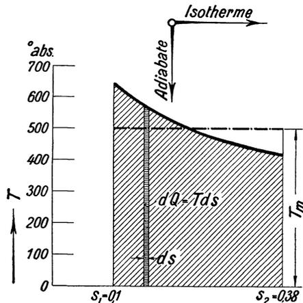
Abb. 12. Wärmediagramm oder *T*-*s*-Diagramm.
