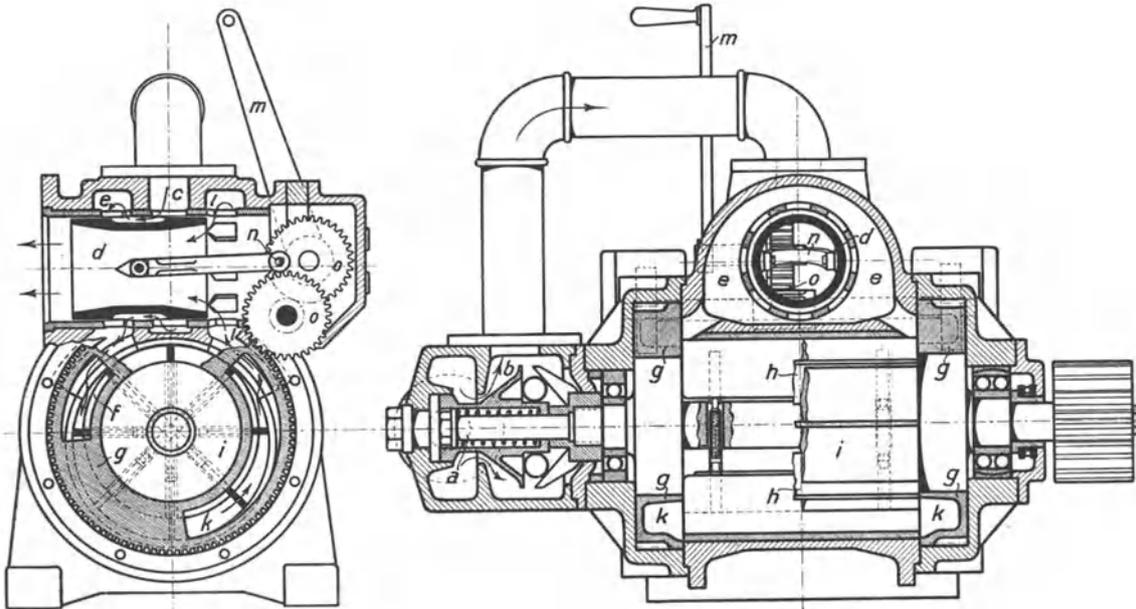
Abb. 380. Umsteuerbarer Drehkolbenmotor mit Expansion von Axmann & Co., Bochum.
