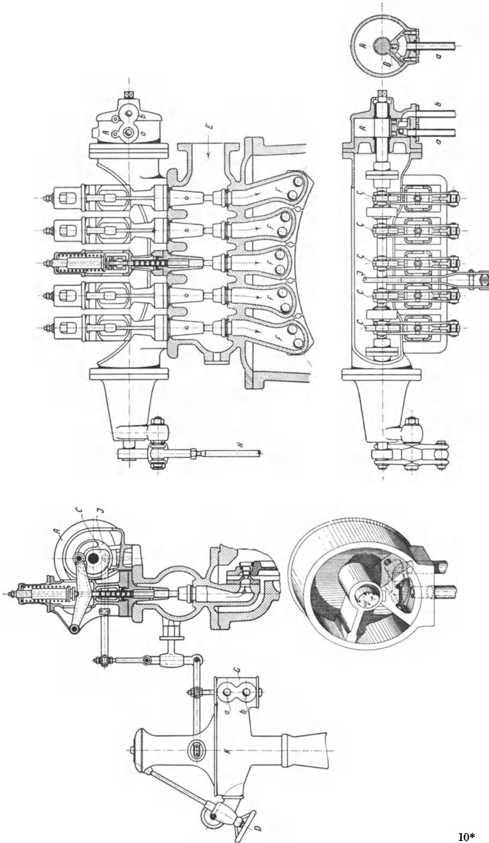
Abb. 184. Steuerung der AEG-Dampfturbine.
