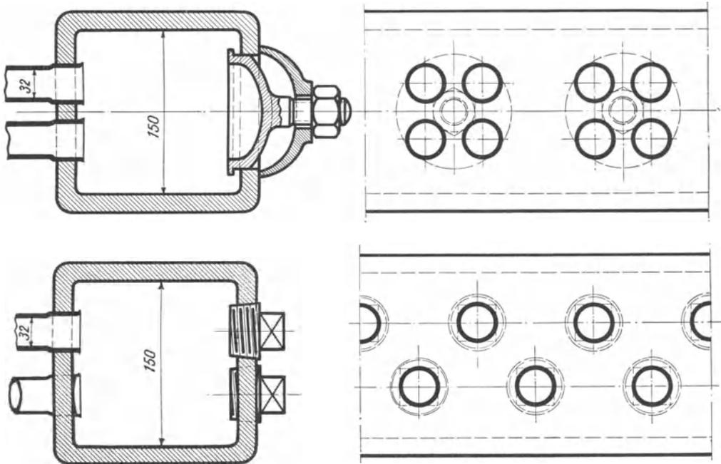
Abb. 73. Überhitzerkammern.
