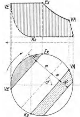
Abb. 113. Schieberdiagramm.
