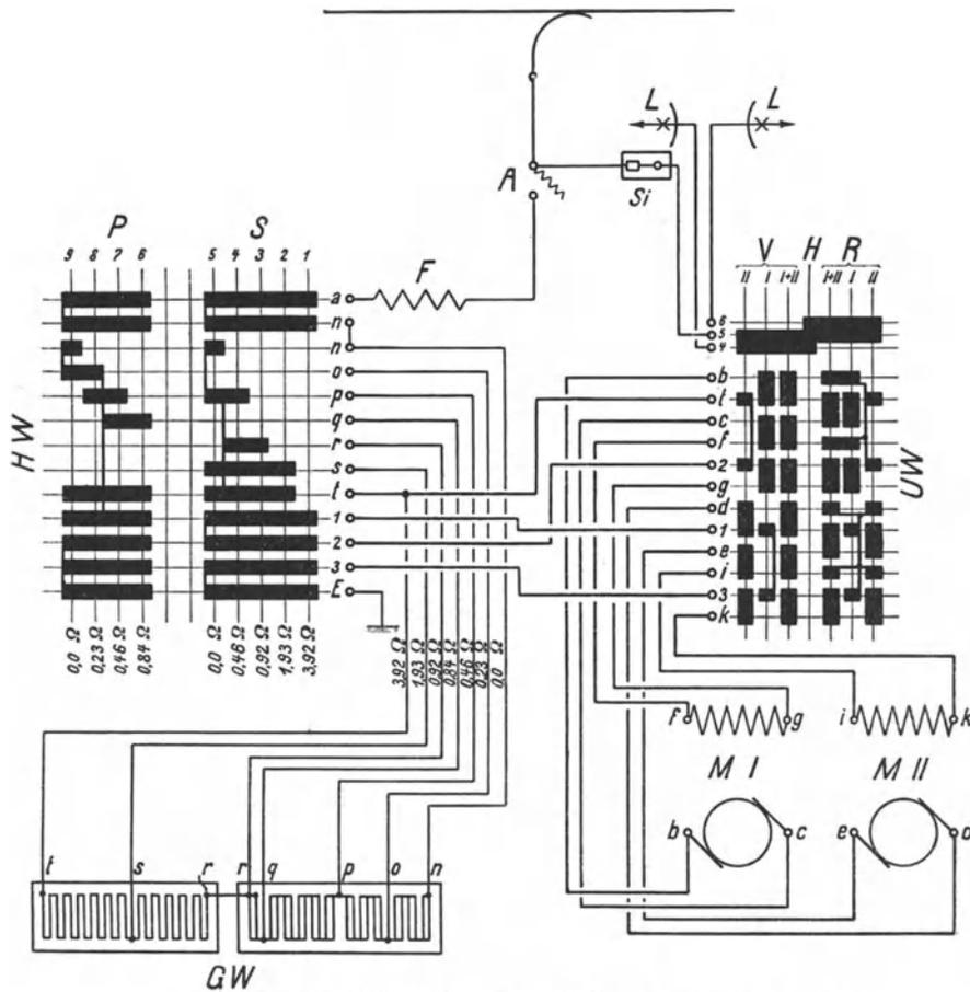
Abb. 479. Fahrwechsler einer Fahrdrabtgrubenlokomotive.
