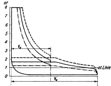
Abb. 129. Verhalten einer Verbunddampfmaschine bei veränderlicher Belastung.
