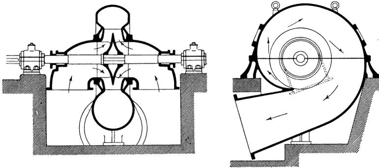
Abb. 314. Niederdruckkreiselpumpe mit 2seitigem Einlauf.
