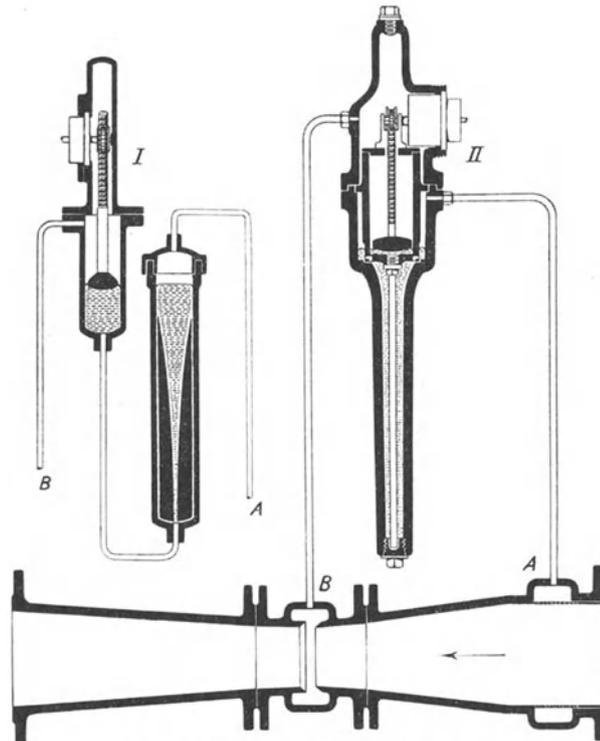
Abb. 513. Venturi-Wassermesser von Siemens & Halske, A.-G.
