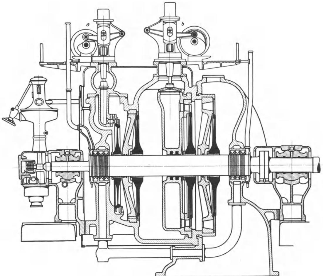
Abb. 192. Zweidruckturbine der AEG.
