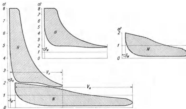
Abb. 128. Diagramme einer Verbunddampfmaschine, vergleichbar umgezeichnet.
