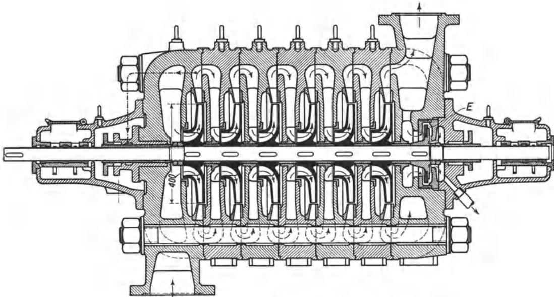
Abb. 317. 6stufige Hochdruckkreiselpumpe (Jaeger).
