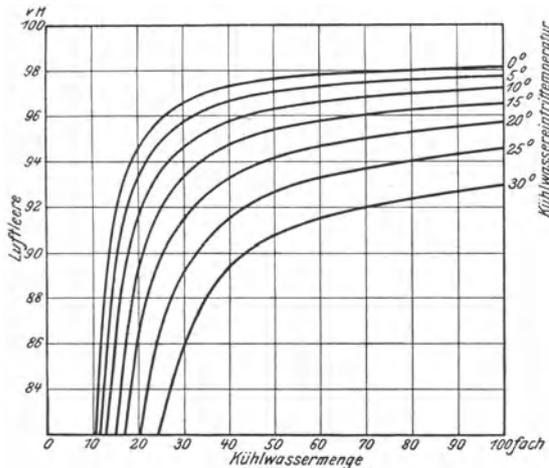
Abb. 133. Erzeugte Luftleere in Abhängigkeit von der Kühlwassermenge und -Eintrittstemperatur.
