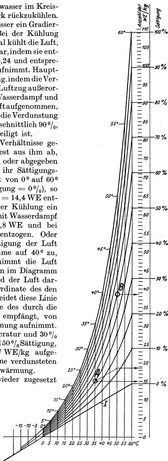
Abb. 151. Von der Luft aufgenommene oder abgegebene Wärme, in WE/kg, wenn sich Temperatur und Sättigungszustand der Luft ändern.
