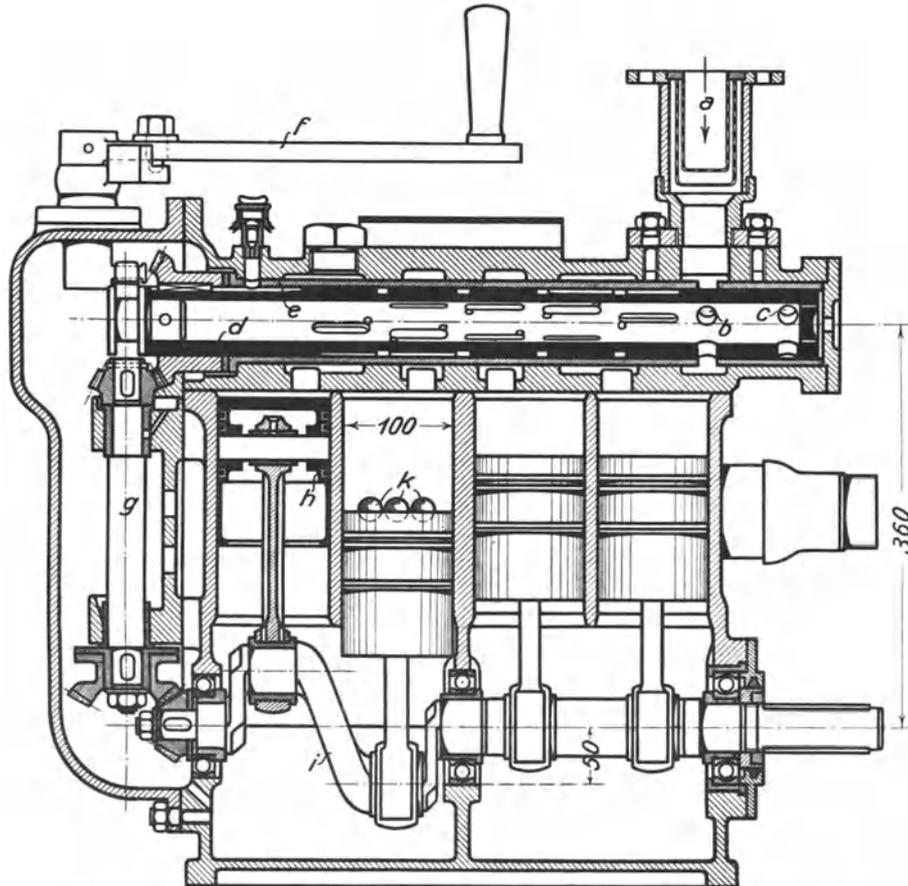
Abb. 374. Umsteuerbarer Blockmotor der Frankfurter Maschinenbau-A.-G.
