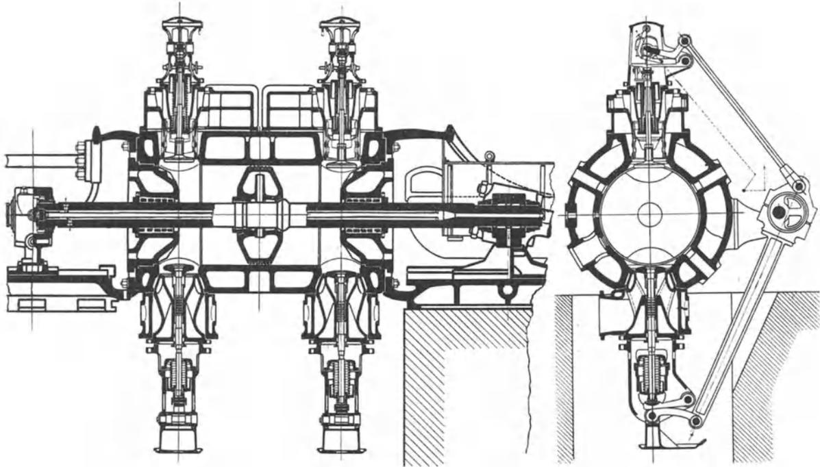
Abb. 445. Zylinder der Viertaktgroßgasmaschine der MAN.
