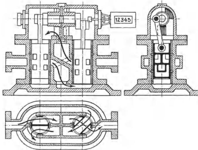
Abb. 498. Schmidtscher Kolbenwassermesser.
