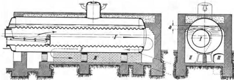
Abb. 44. Einflammrohrkessel.
