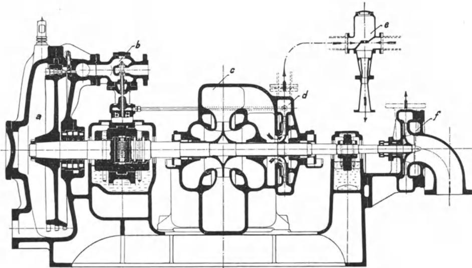
Abb. 148. Kondensationspumpenanlage (BBC.).
