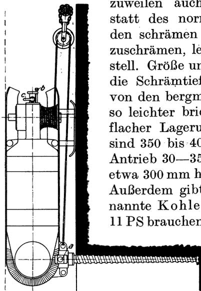
Abb. 390. Schrämmaschine mit einseitig aufgesetzter, umsteckbarer Windentrommel (Flottmann).
