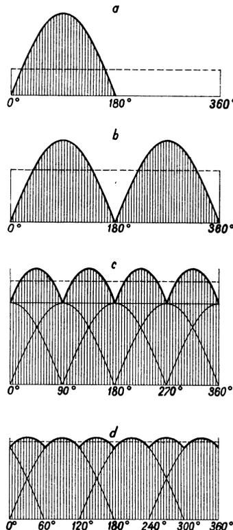
Abb. 296. Linien der Wasserförderung von Kurbelpumpen.
