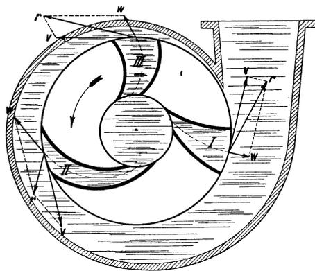
Abb. 308. Schema der Kreiselpumpe.
