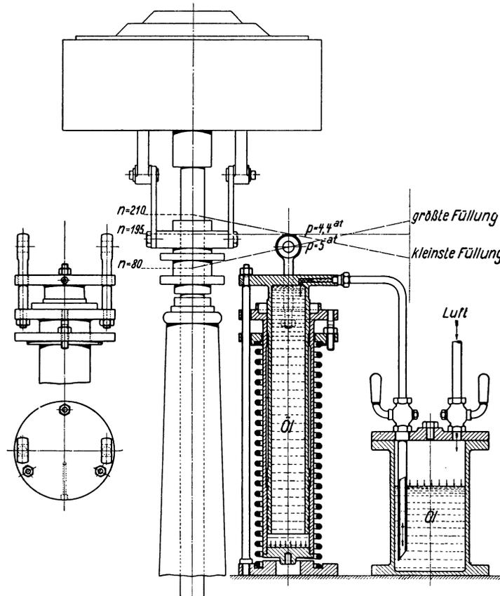
Abb. 343. Regelung auf gleichbleibenden Luftdruck.
