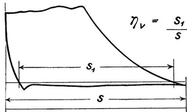
Abb. 325. Bestimmung des volumetrischen Wirkungsgrades.
