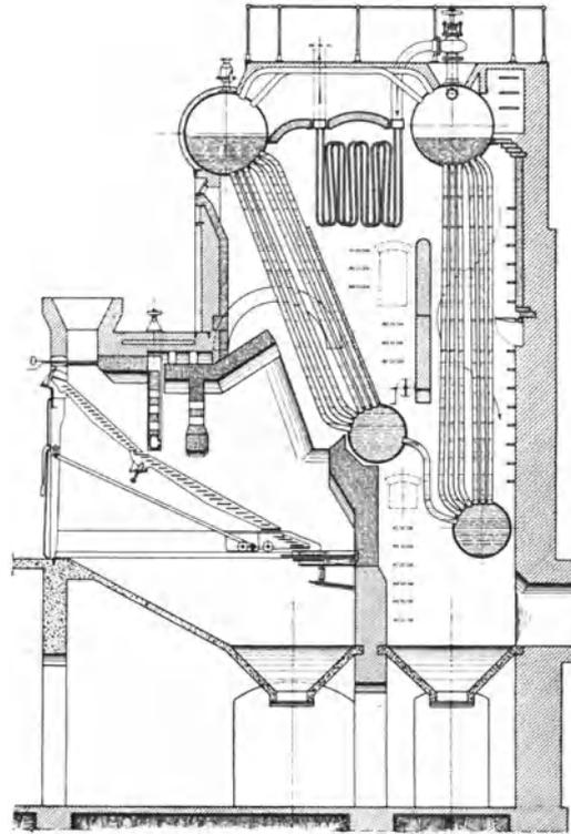
Abb. 58. Steilrohrkessel von L. & C. Steinmüller.
