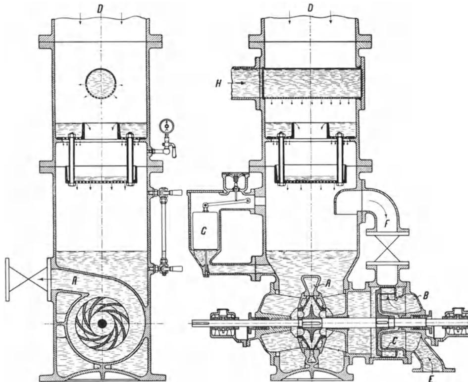
Abb. 136. Mischkondensation mit rotierenden Pumpen.
