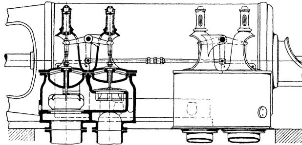
Abb. 239. Kulissensteuerung mit Ventilen.
