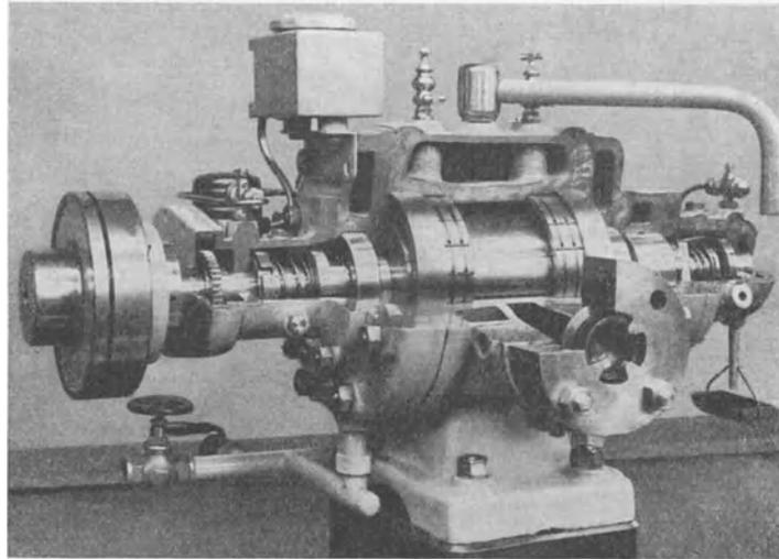
Abb. 353. Drehkolbenkompressor der Demag.
