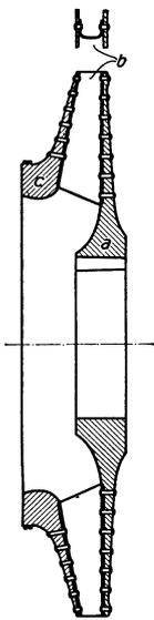
Abb. 356. Laufrad eines Turbokompressors.
