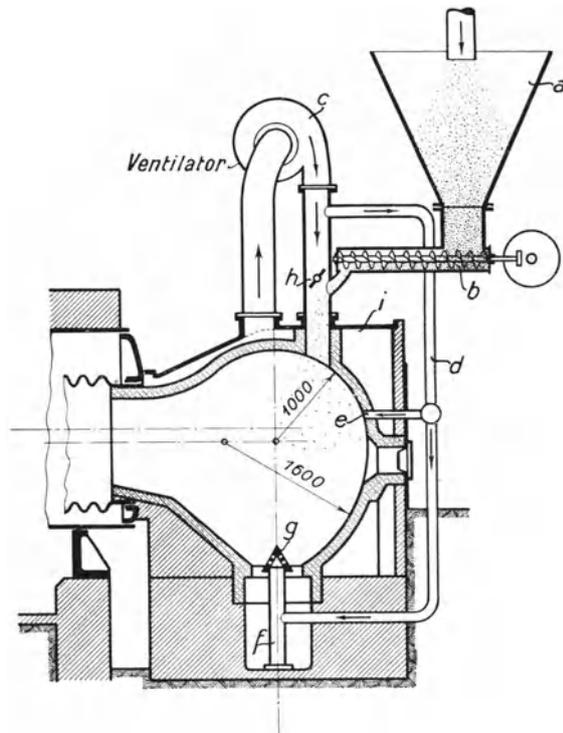
Abb. 39. Verbrennungsraum eines Einflamrohrkessels mit Kohlenstaubfeuerung.
