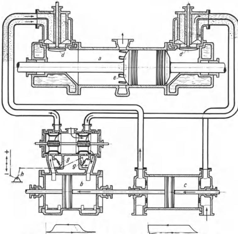
Abb. 450. Zweitaktmaschine der Gebr. Klein, Dahlbruch.
