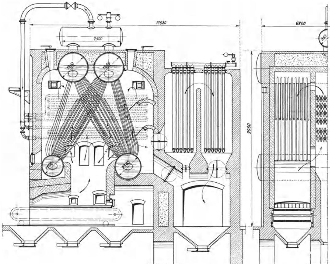
Abb. 59. Steilrohrkessel nach Burkhardt von Petry-Dereux.
