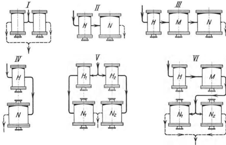
Abb. 83. Zylinderanordnungen von Kolbenmaschinen.
