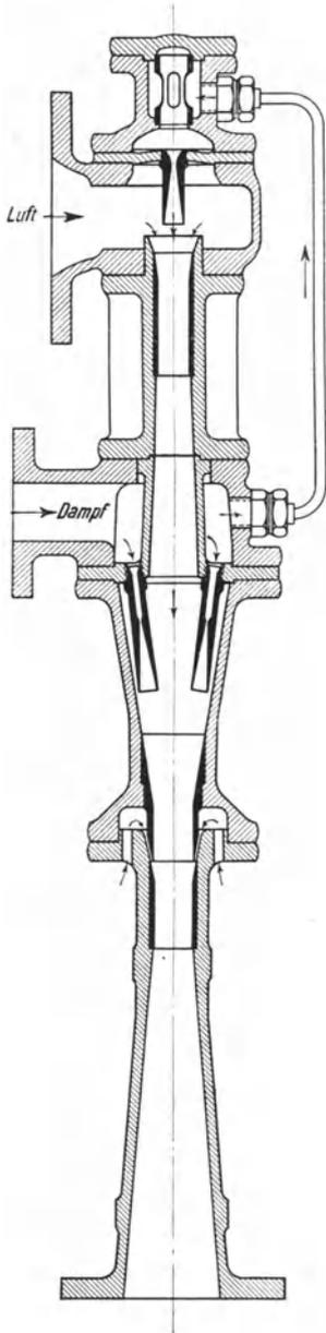
Abb. 149. Dampfstrahl-Luftpumpe von Leblanc.
