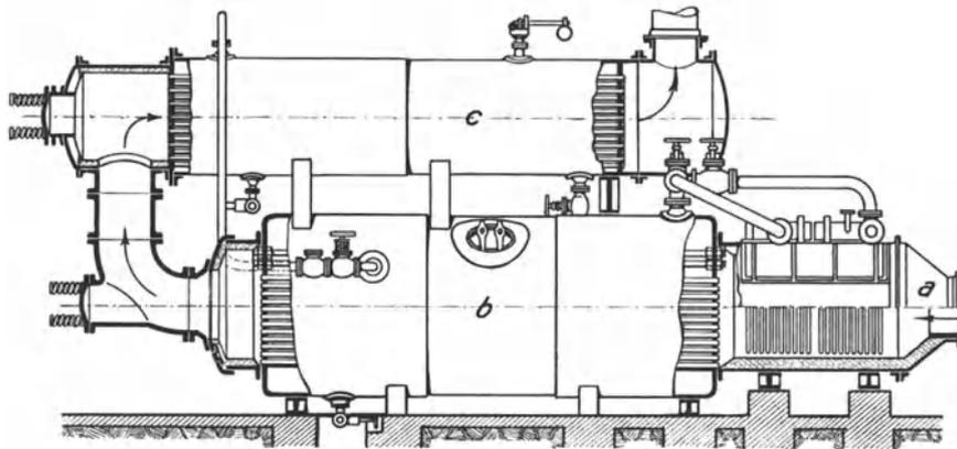
Abb. 453. Abwärmekessel von Thyssen & Co.
