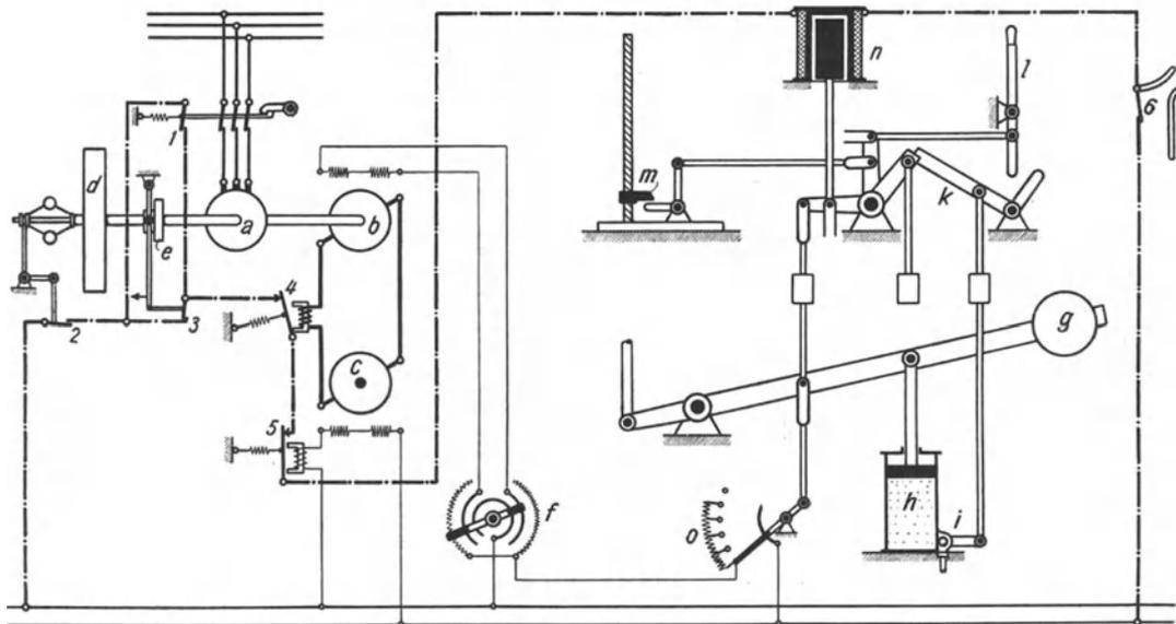
Abb. 474. Anordnung des Bremsmagnetstromkreises.
