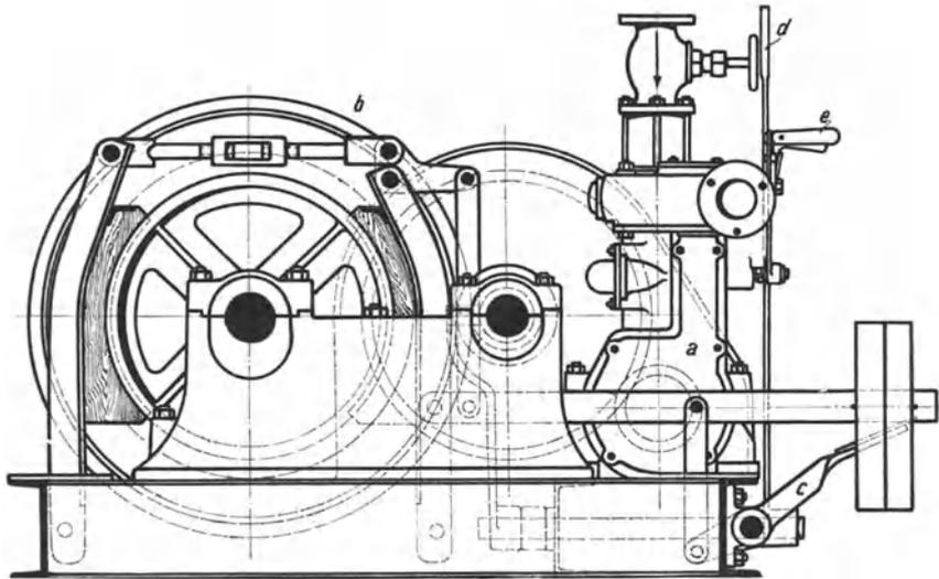
Abb. 385. Drucklufthaspel mit Blockmotor (Knapp).
