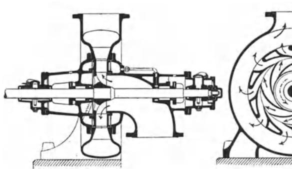
Abb. 316. Niederdruckkreiselpumpe mit Leitrad.
