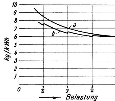
Abb. 198. Vergleich zwischen Drossel- und Düsenreglung.
