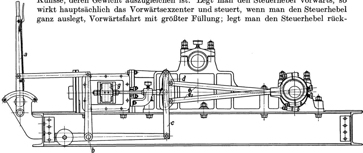
Abb. 369. Stephenson'sche Kulissensteuerung mit gekreuzten Stangen.
