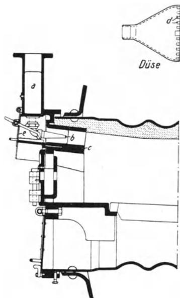
Abb. 36. Rostfeuerung mit zusätzlicher Gasfeuerung.
