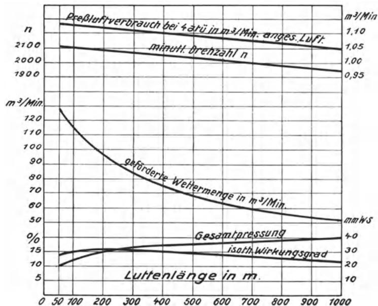
Abb. 432. Kennlinien eines Luttenventilators von 500 mm Durchm.
