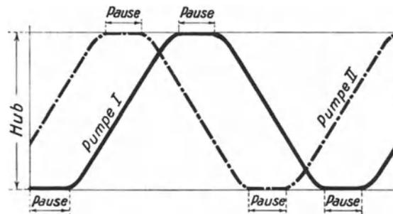
Abb. 302. Zusammenhang der Kolbenbewegungen bei Duplexpumpen.
