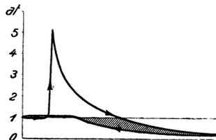
Abb. 434. Diagramm der atmosphärischen Gasmaschine von Otto und Langen.
