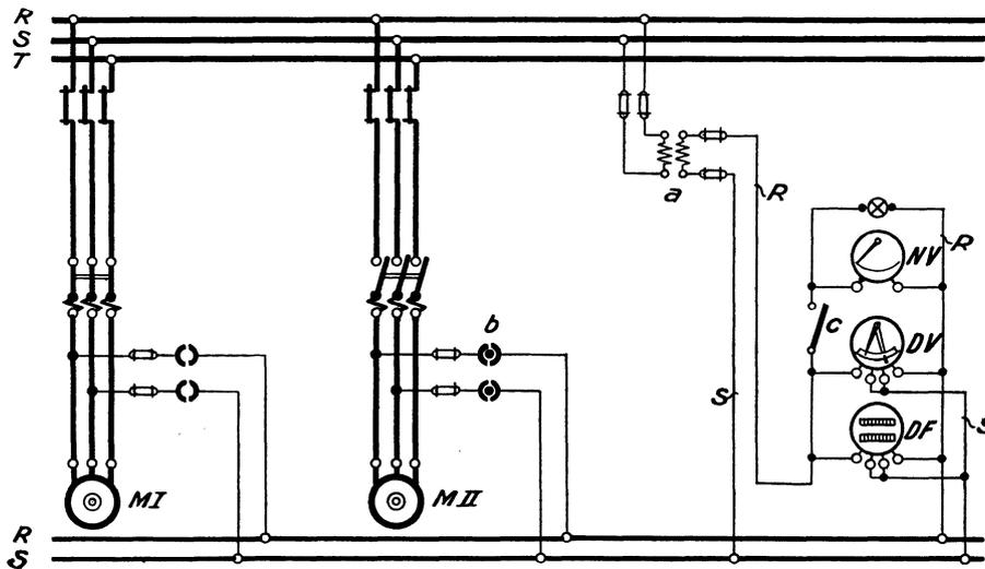
Abb. 468. Parallelschaltung von Drehstromgeneratoren bei einer Niederspannungsanlage.
