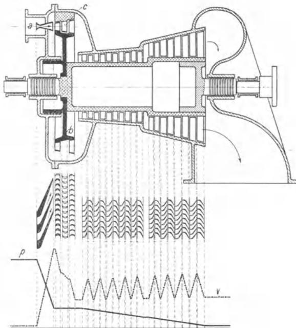
Abb. 175. Überdruckturbine mit vorgeschaltetem Curtisrade.
