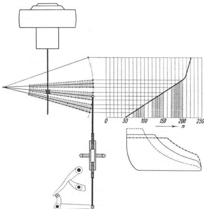
Abb. 103. Wirkungsweise eines Leistungsreglers.
