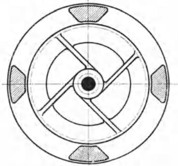
Abb. 120. Rohrventil.
