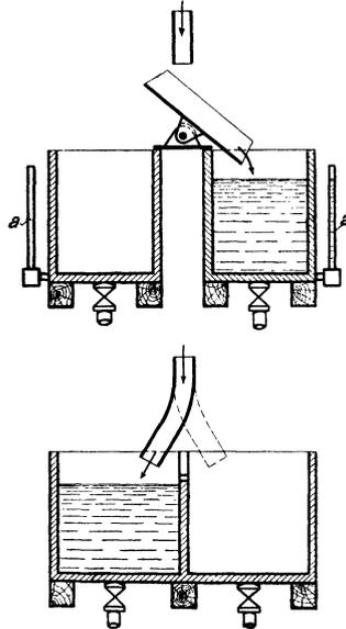
Abb. 496. Wassermessung mittels Meßgefäße.
