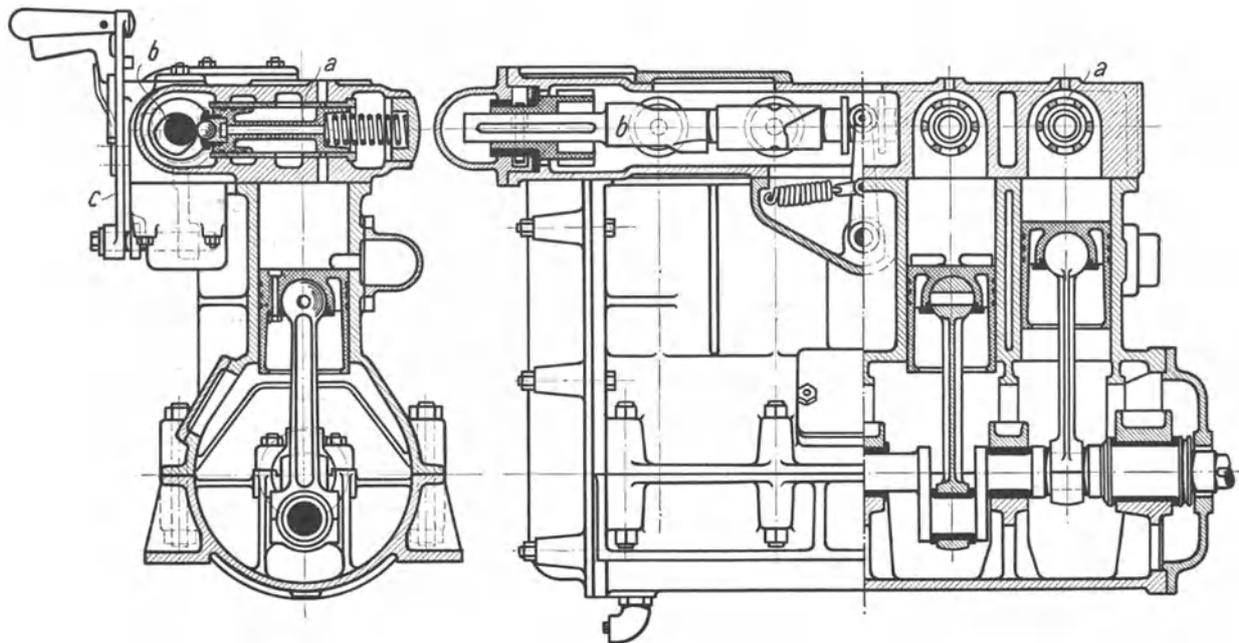
Abb. 376. Umsteuerbarer Blockmotor der Maschinenfabrik W. Knapp, Eickel.
