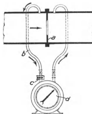
Abb. 519. Teilstrommessung von
