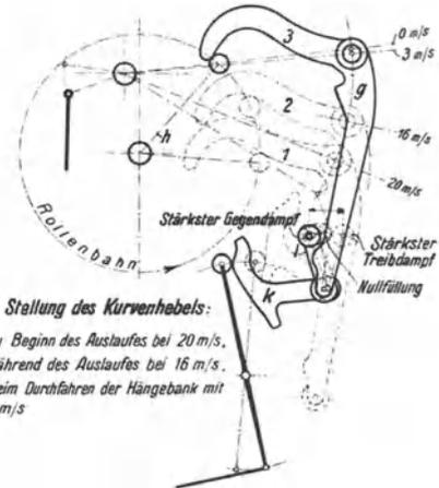
Abb. 273. Einwirkung auf die Steuerung.
