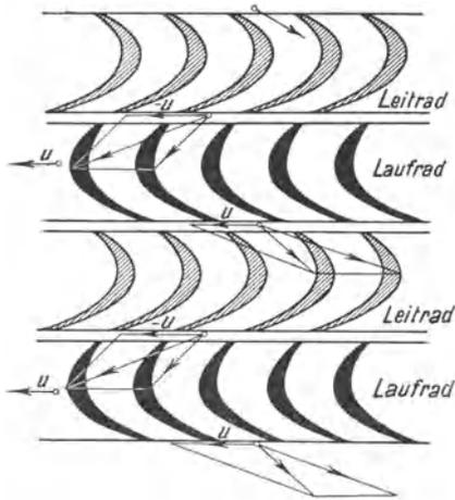
Abb. 170. Mehrstufige Überdruckschaufelung.
