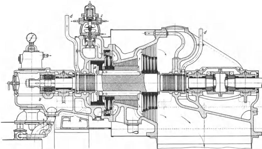
Abb. 188. Dampfturbine von Brown, Boveri & Co.
