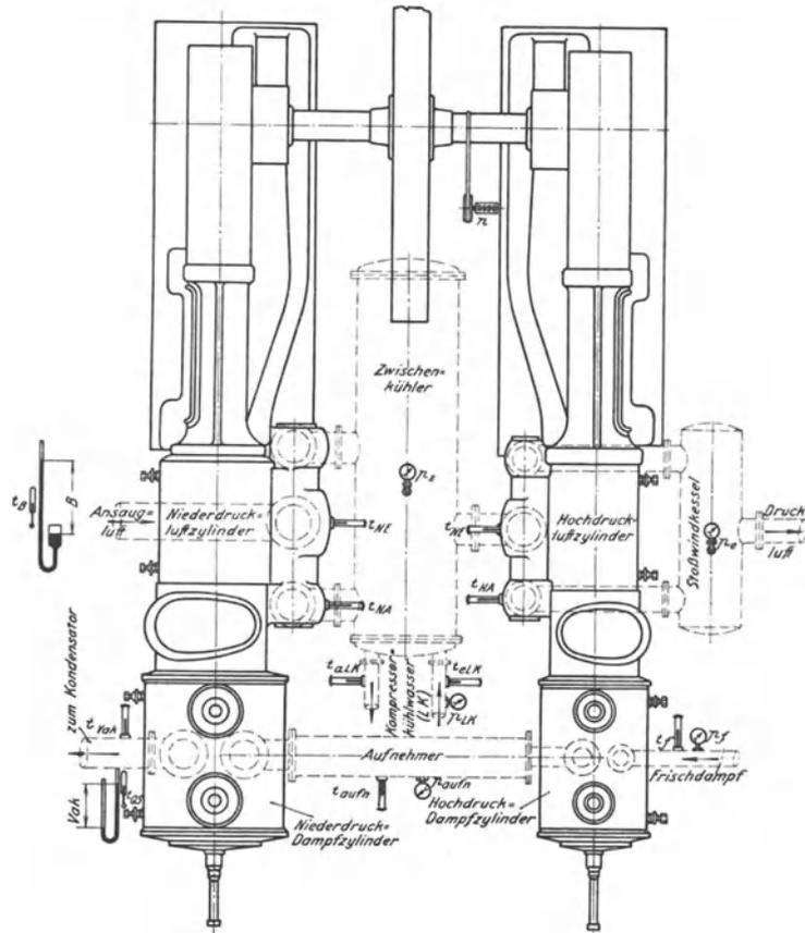
Abb. 354. Meßanordnung für Kolbenkompressoren.
