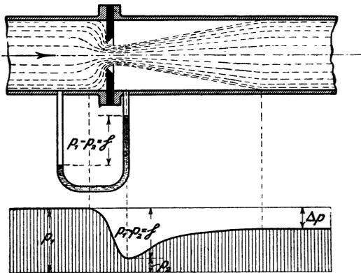
Abb. 510. Messung mittels Staurandes.
