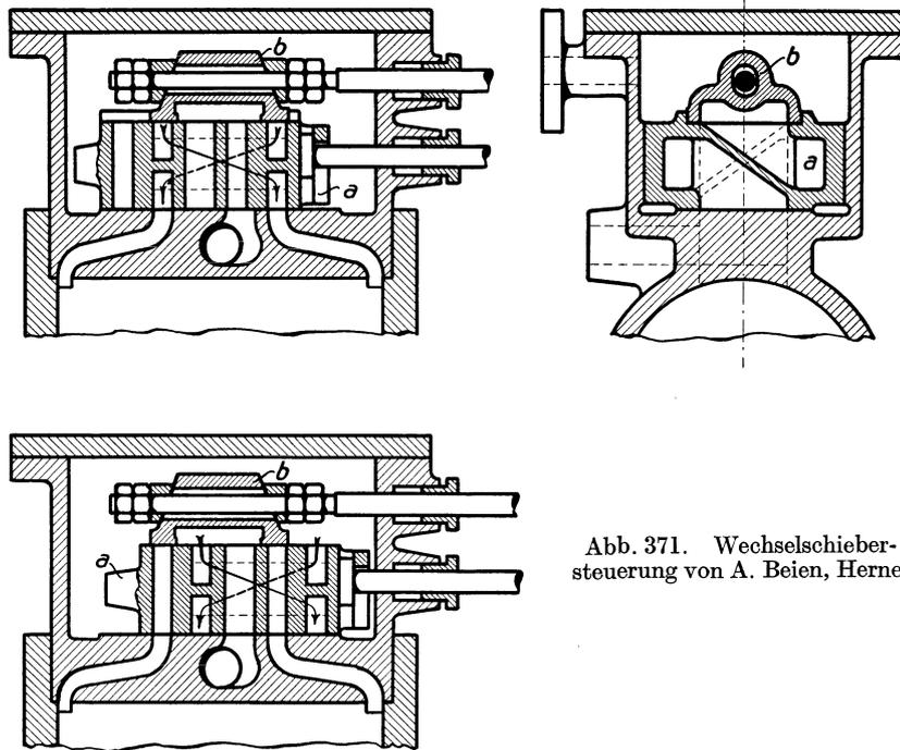
Abb. 371. Wechselschiebersteuerung von A. Beien, Herne.
