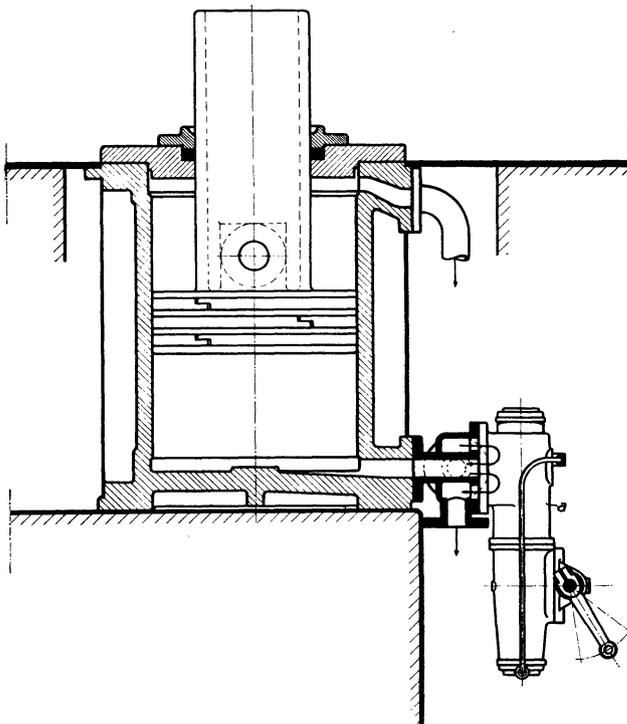
Abb. 254. Einlaßbremse mit Bremsdruckregler.
