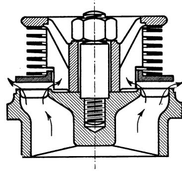
Abb. 286. Einfaches Ringventil.
