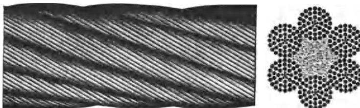
Abb. 231. Längsschlagseil.
