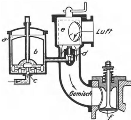
Abb. 437. Anordnung eines Vergasers.
