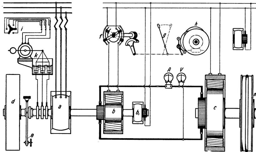
Abb. 473. Schaltplan einer Gleichstromfördermaschine mit Leonardscher Schaltung und Schwungradausgleich nach Ilgner.
