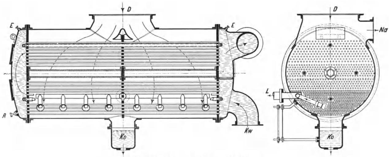
Abb. 139. Liegender Querstromkondensator.
