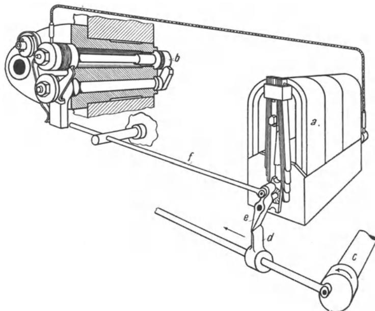
Abb. 443. Elektromagnetische Zündeinrichtung.
