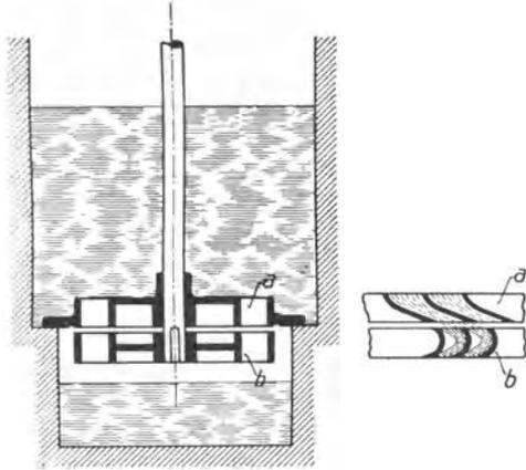
Abb. 159. Axiale Gleichdruckturbine.
