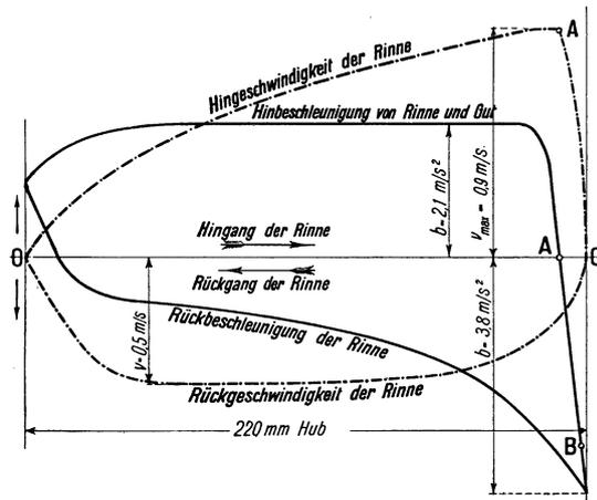
Abb. 411. Beschleunigungs- und Geschwindigkeitsverhältnisse einer Schüttelrutsche.
