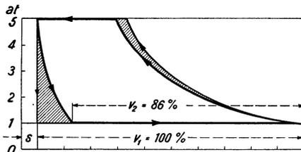
Abb. 327. Vergleich der Kompressorleistung bei  $\eta_v = 100\%$  und  $\eta_v = 86\%$ .
