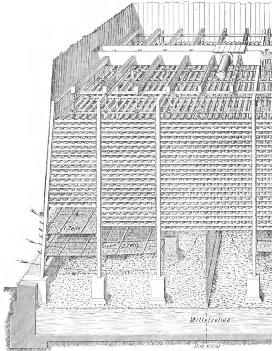
Abb. 156. Inneres eines Zellenkühlers.
