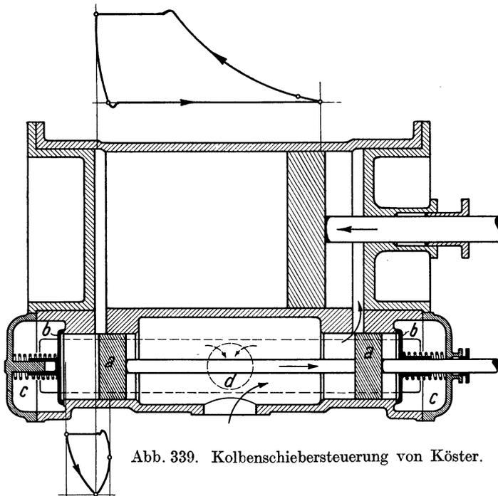
Abb. 339. Kolbenschiebersteuerung von Köster.
