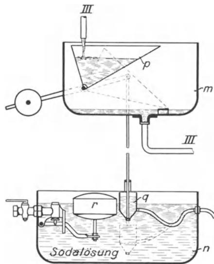
Abb. 71. Zumessung der Sodalösung beim Steinmüllerschen Wasserreiniger.
