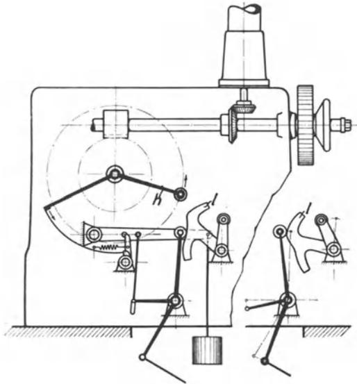
Abb. 272. Einwirkung auf die Bremse.
