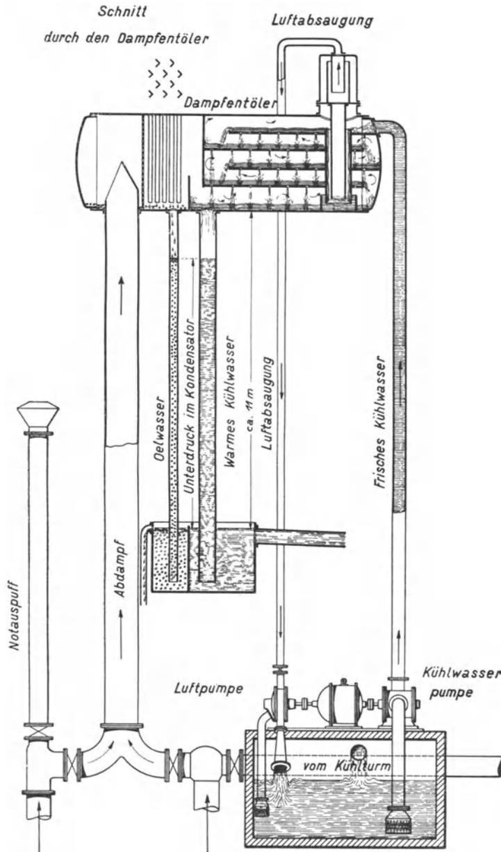
Abb. 138. Gegenstrommischkondensation mit hochliegendem Kondensator.
