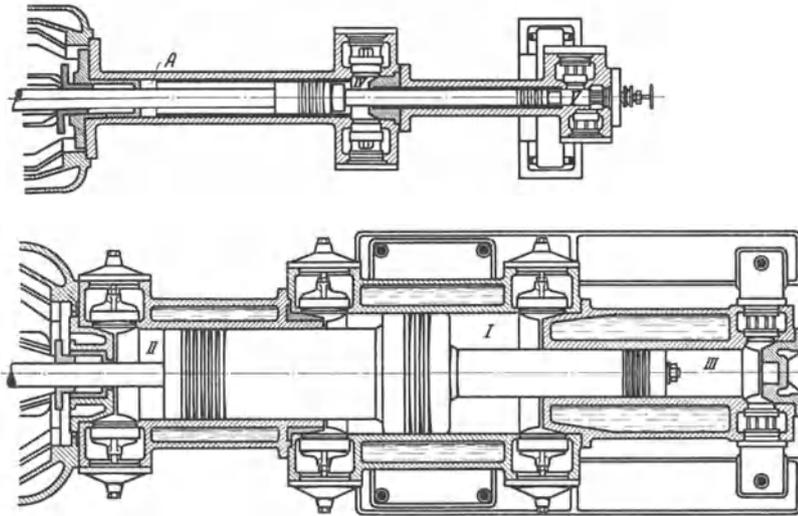
Abb. 415. Zweiachsiger, fünfstufiger Hochdruckkompressor (Demag).
