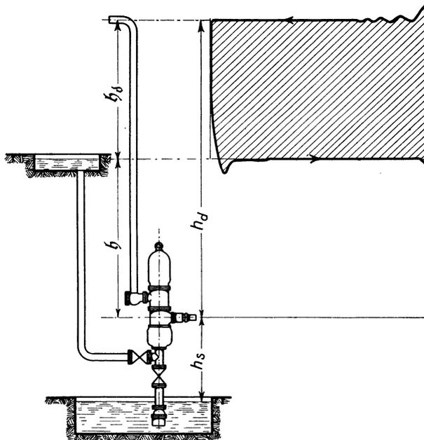
Abb. 281. Betrieb einer Kolbenpumpe mit Abfallwasser einer höheren Sohle.
