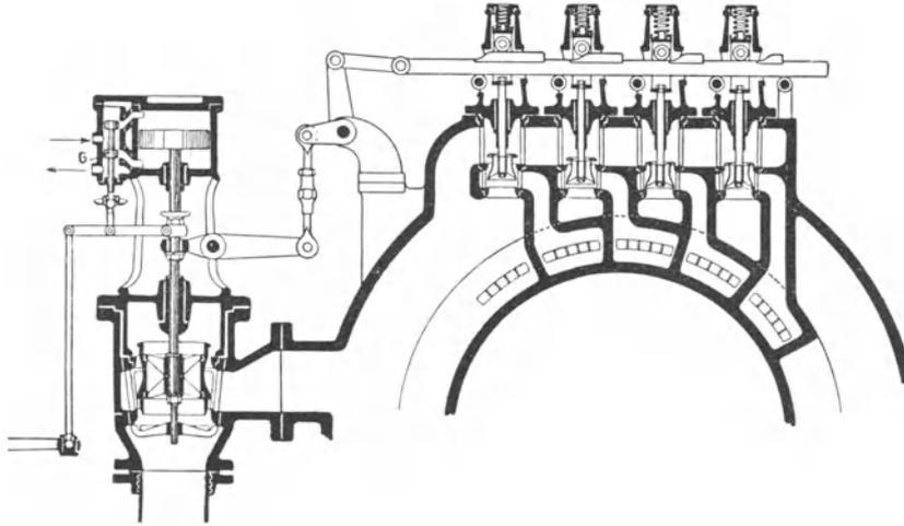
Abb. 182. Steuerung der MAN-Dampfturbine mit Düsenreglung.
