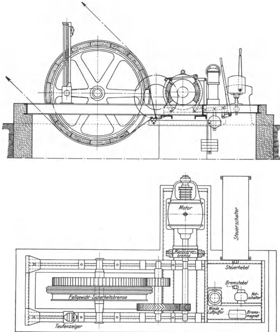
Abb. 471. Drehstromhaspel für Seilfahrt (Gebr. Eickhoff).
