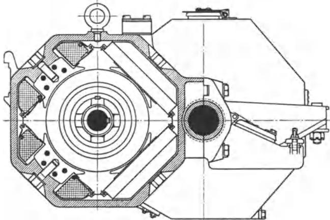
Abb. 477. Elektromotor nebst eingekapseltem Rädervorgelege.
