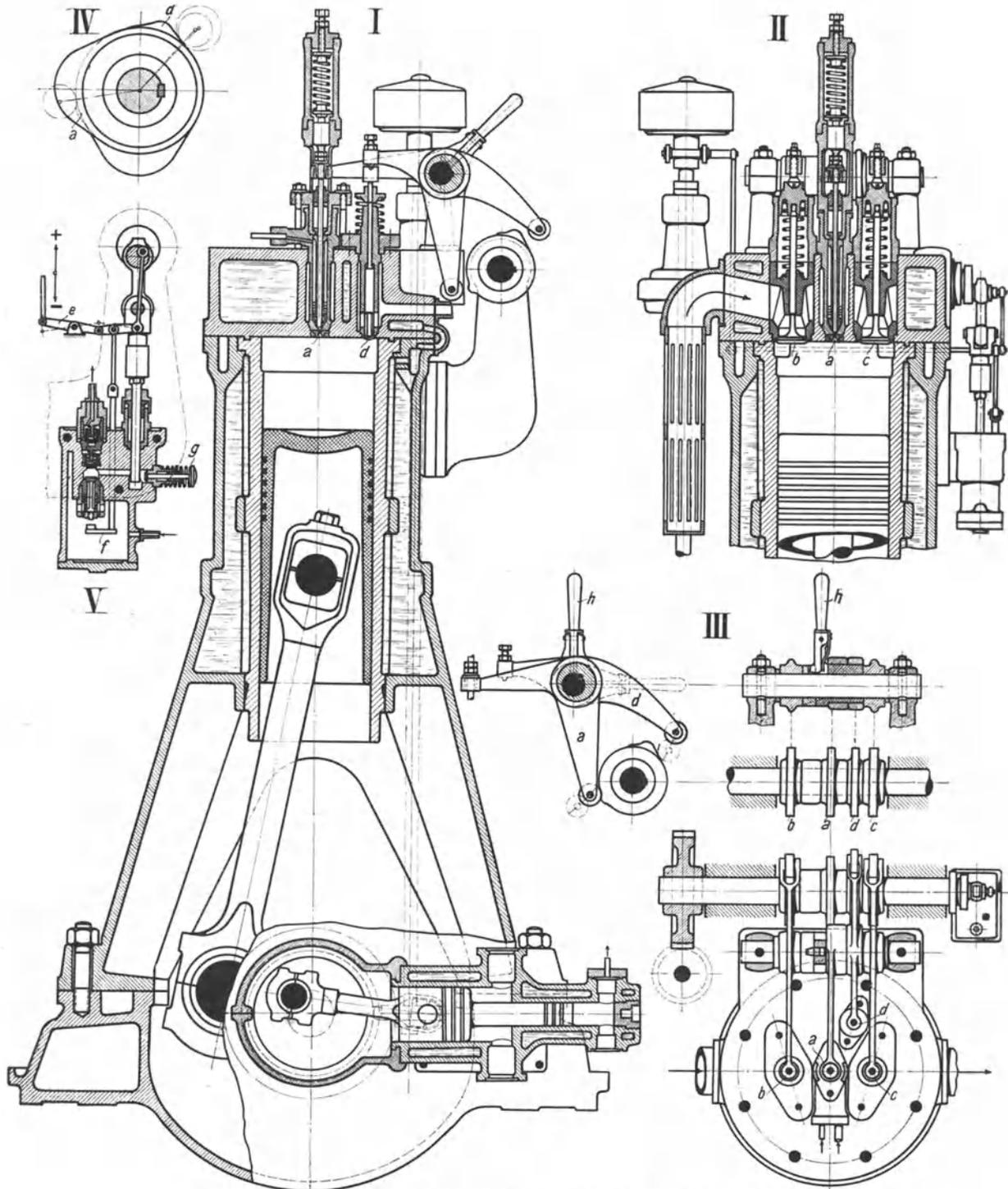
Abb. 456. Stehender Viertakt-Dieselmotor der Motorenfabrik Deutz.
