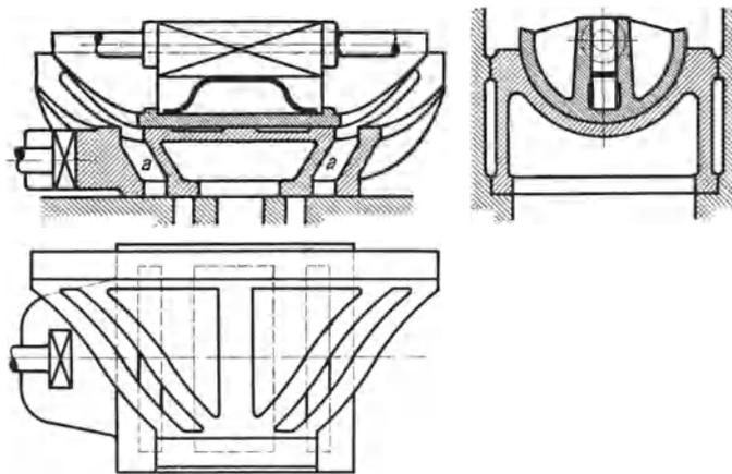
Abb. 117. Doppelschiebersteuerung von Rider.
