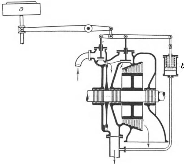
Abb. 191. Entnahmeturbine.
