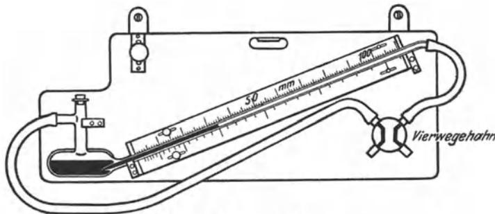
Abb. 492. Differenzdruckmesser.
