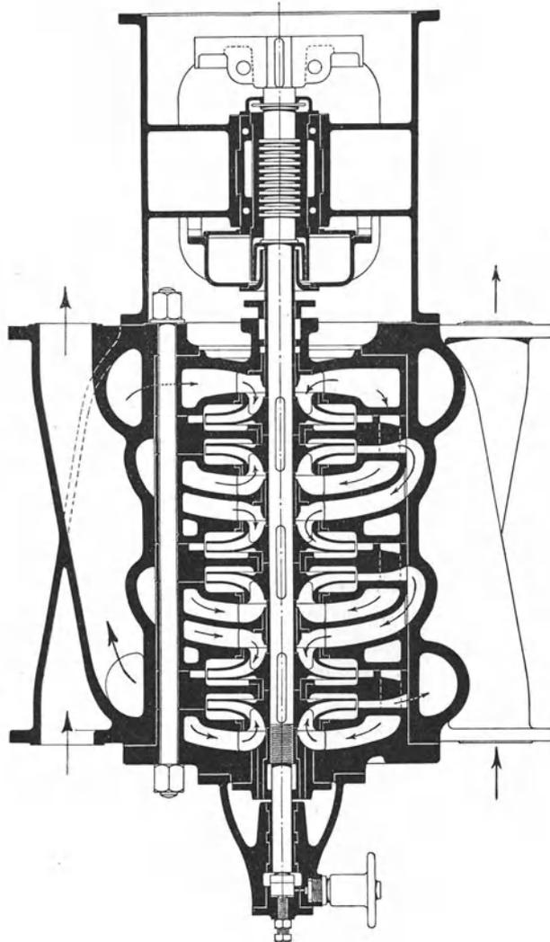
Abb. 323. Abteufkreislumpumpe (Sulzer).
