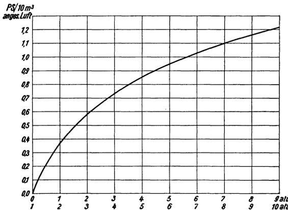
Abb. 366. Kraftbedarf eines Kompressors bei  $\eta_{is} = 70\%$ .
