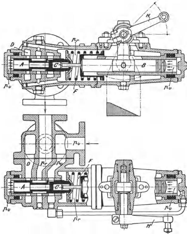
Abb. 257. Bremsdruckregler von Iversen.
