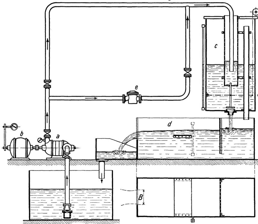
Abb. 309. Meßstand für Kreiselpumpen.
