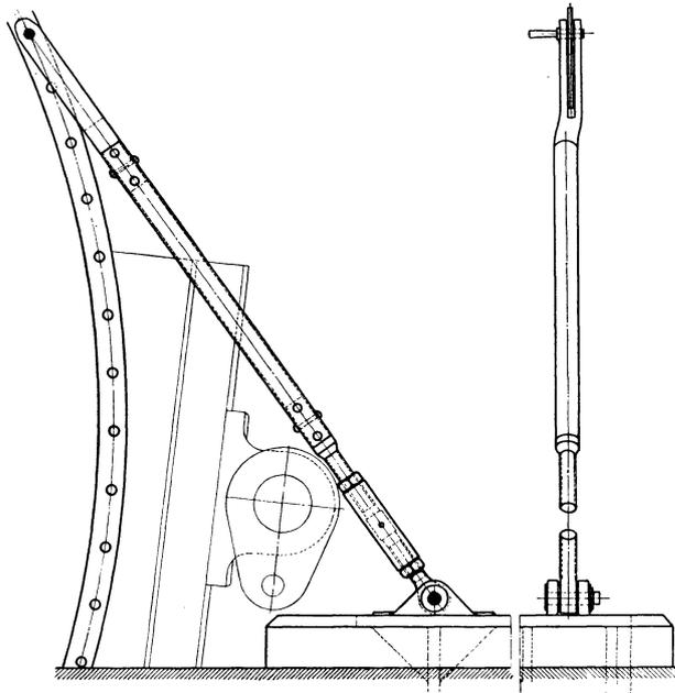
Abb. 218. Haltestange zum Festlegen der umsteckbaren Trommel.
