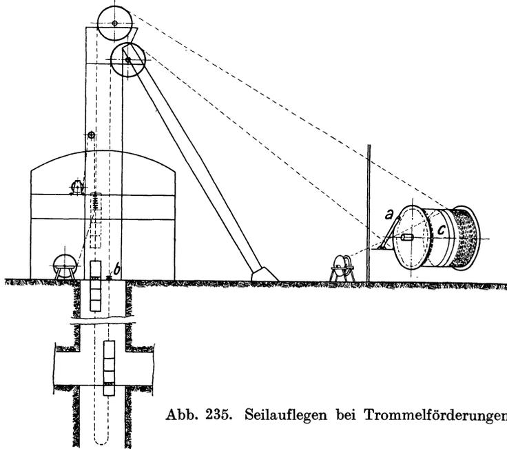
Abb. 235. Seilauflegen bei Trommelförderungen.
