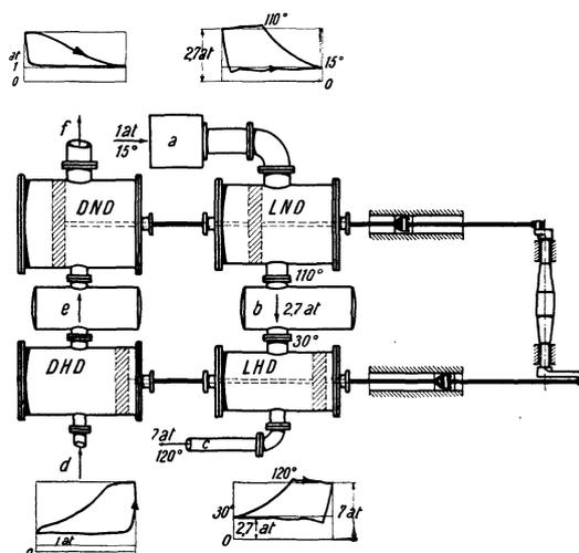
Abb. 331. Gesamtanordnung eines zweistufigen Luftkompressors mit Dampftrieb.
