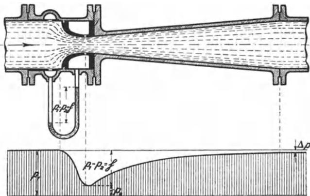
Abb. 512. Messung mittels Venturirohres.
