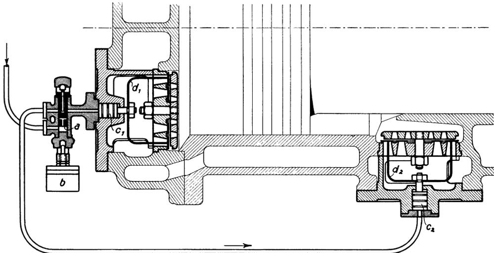
Abb. 346. Aussetzerregelung für Ventilkompressoren (Flottmann).
