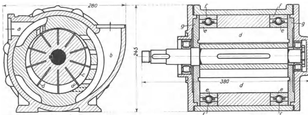
Abb. 378. Drehkolbenmotor von 11 PSe bei  $n = 1650$  (Westfalia, Gelsenkirchen).
