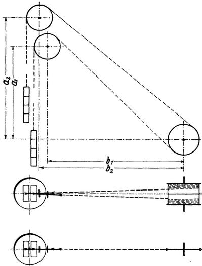
Abb. 212. Fördermaschine liegt quer zur Durchschubrichtung der Förderwagen.
