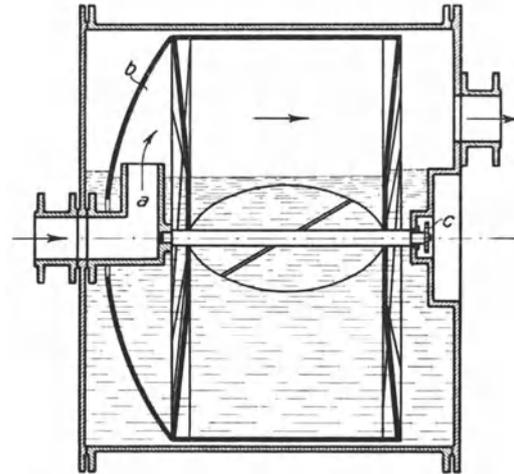
Abb. 505. Gasmesser mit Crossley-Trommel.
