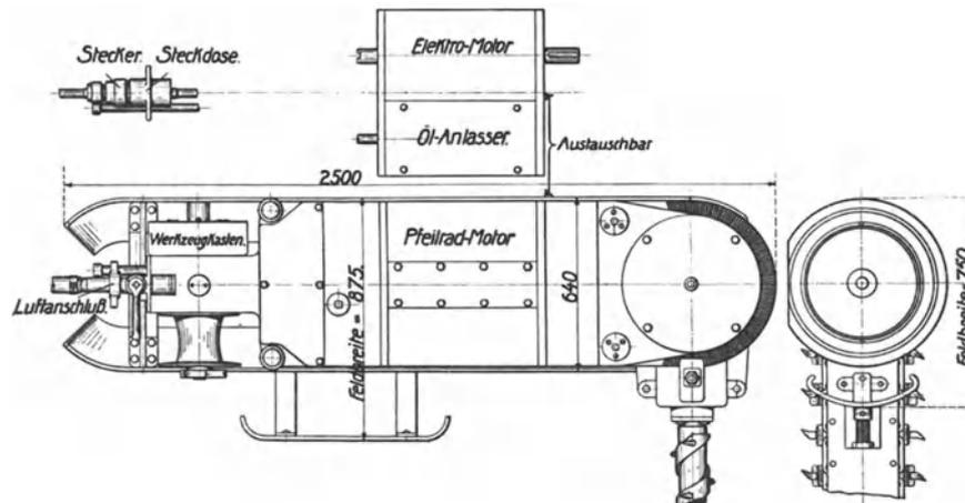
Abb. 395. Schrämmaschine von Flottmann & Co.
