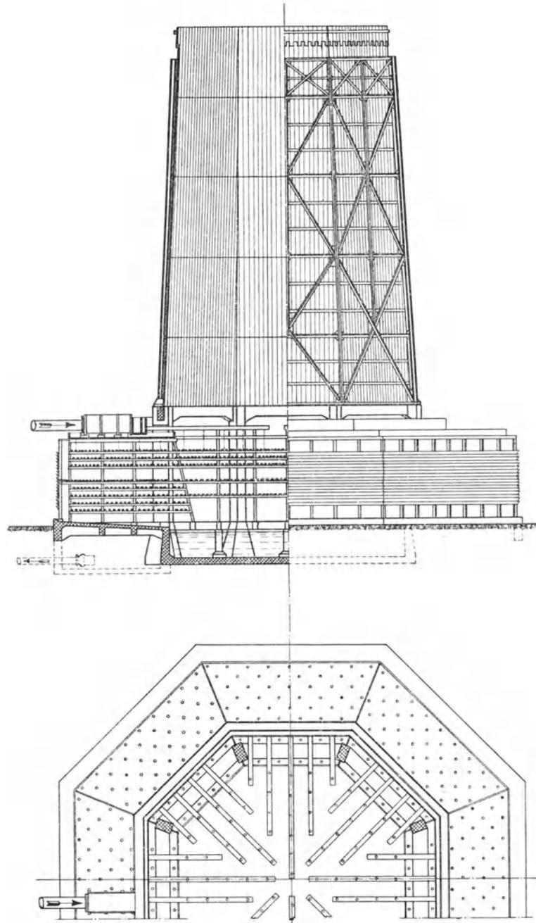
Abb. 157. Querstromgegenstromkühler (Balcke).
