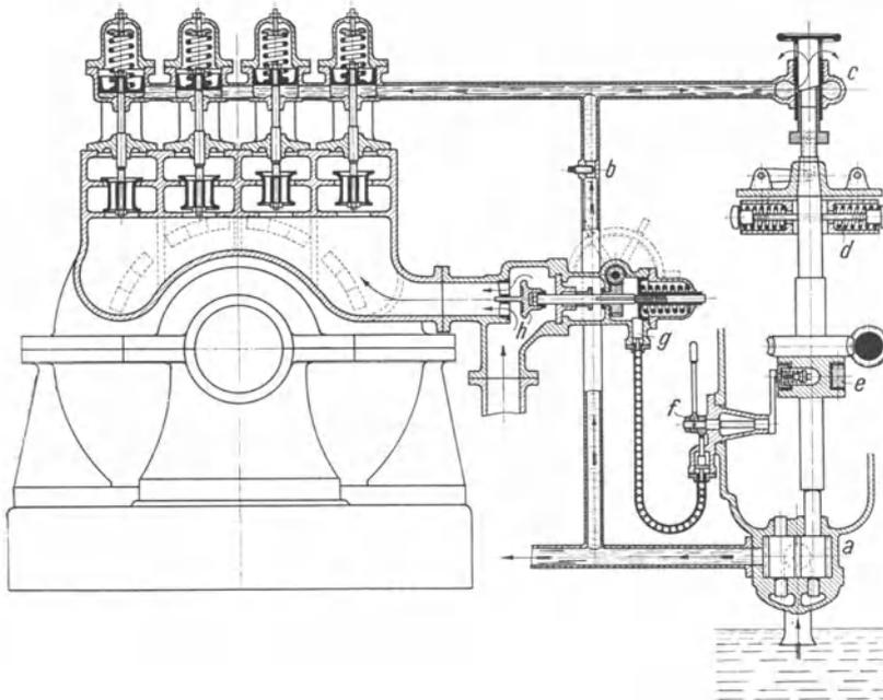
Abb. 189. Durchflußreglung der BBC-Dampfturbine.
