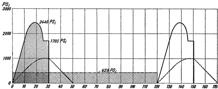
Abb. 229. Geschwindigkeits- und Leistungsverhältnisse einer Förderanlage.
