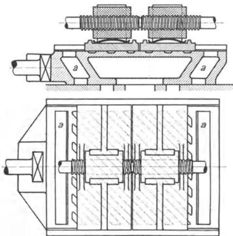
Abb. 116. Doppelschiebersteuerung von Meyer.
