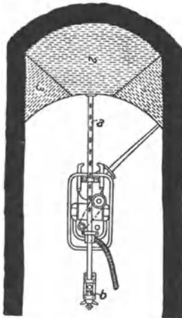
Abb. 398. Streckenvortriebsmaschine von W. Knapp, Eickel.
