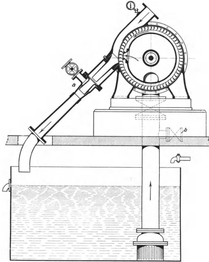
Abb. 146. Schleuderluftpumpe nach Westinghouse-Leblanc.
