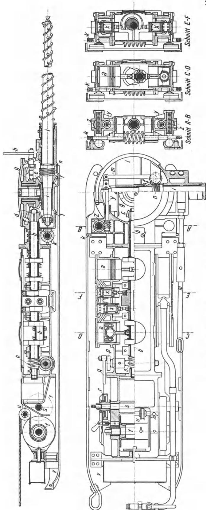
Abb. 391. Schwere Schrämmaschine der Maschinenfabrik W. Knapp, Eickel.
