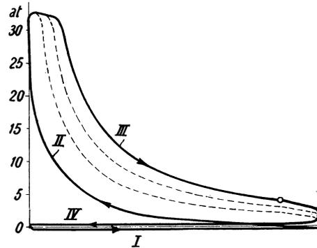
Abb. 457. Regulierdiagramm der Viertakt-Dieselmotore.
