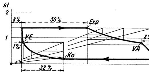
Abb. 105. Kondensationsdampfdiagramm.
