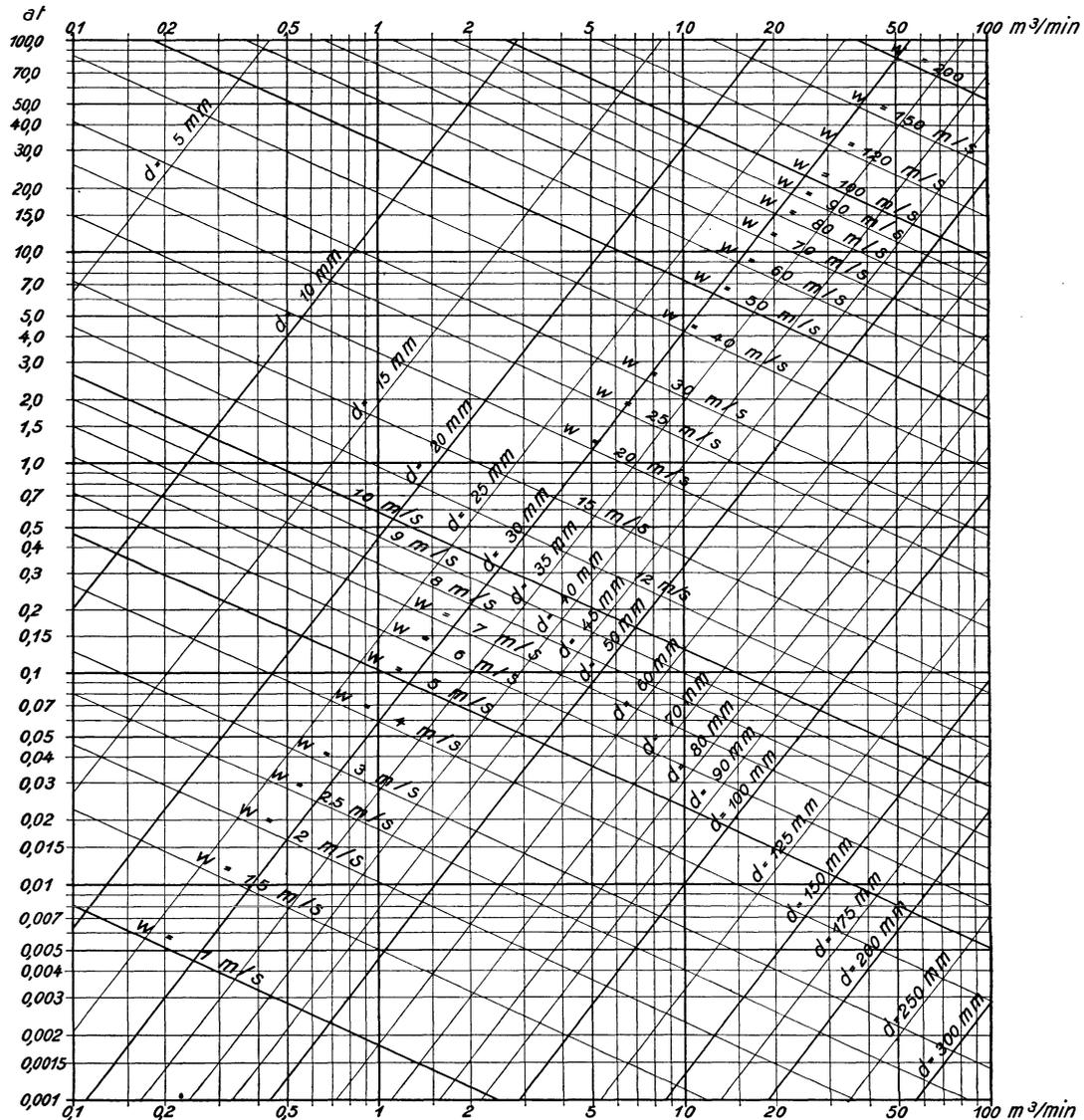
Abb. 81. Zusammenhang zwischen Druckverlust  $\Delta p$  in at, Strömungsgeschwindigkeit  $w$  in m/s, Rohrweite  $d$  in mm, minutlicher Ansaugmenge in  $\text{m}^3$  bezogen auf 1 at für Druckluft von 5 at mittlerem Überdruck und  $7,2 \text{ kg/m}^3$  spez. Gewicht. Die Zahlen für den Druckverlust gelten für 100 m glatter, gerader Rohrlänge.
