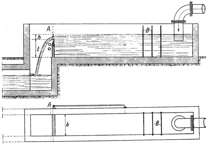
Abb. 507. Gemauertes Meßwehr.
