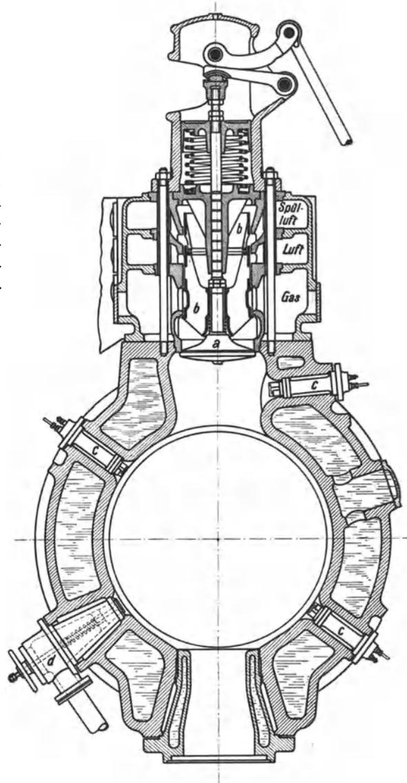
Abb. 448. Zylinderquerschnitt der Thyssenschen Großgasmaschine mit Leistungssteigerung.
