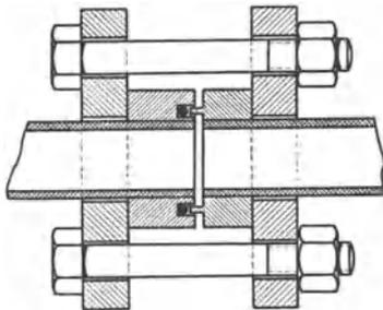
Abb. 417. Flanschverbindung einer Preßluftleitung.
