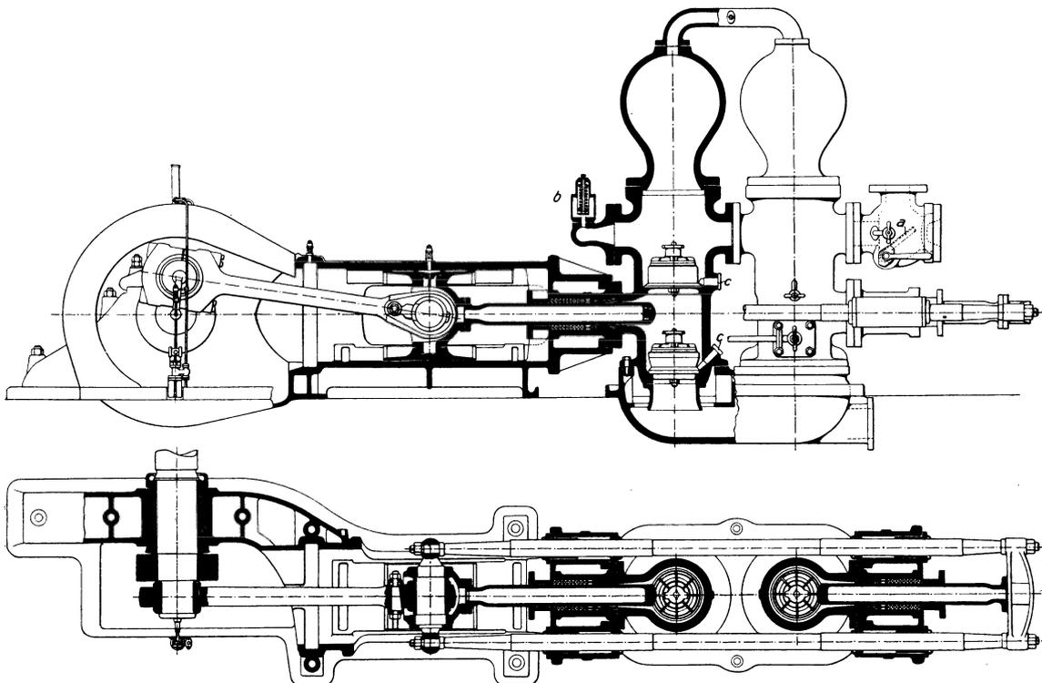
Abb. 306. Elektrisch angetriebene Wasserhaltungspumpe von Ehrhardt & Seher.  $n = 145$ .
