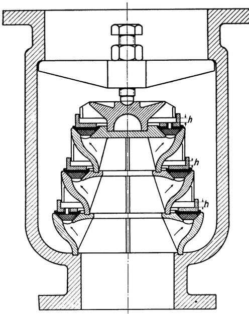
Abb. 287. Dreiringiges Stufenventil.
