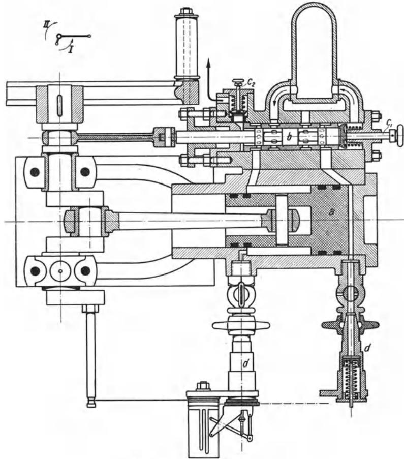
Abb. 349. Versuchskompressor.
