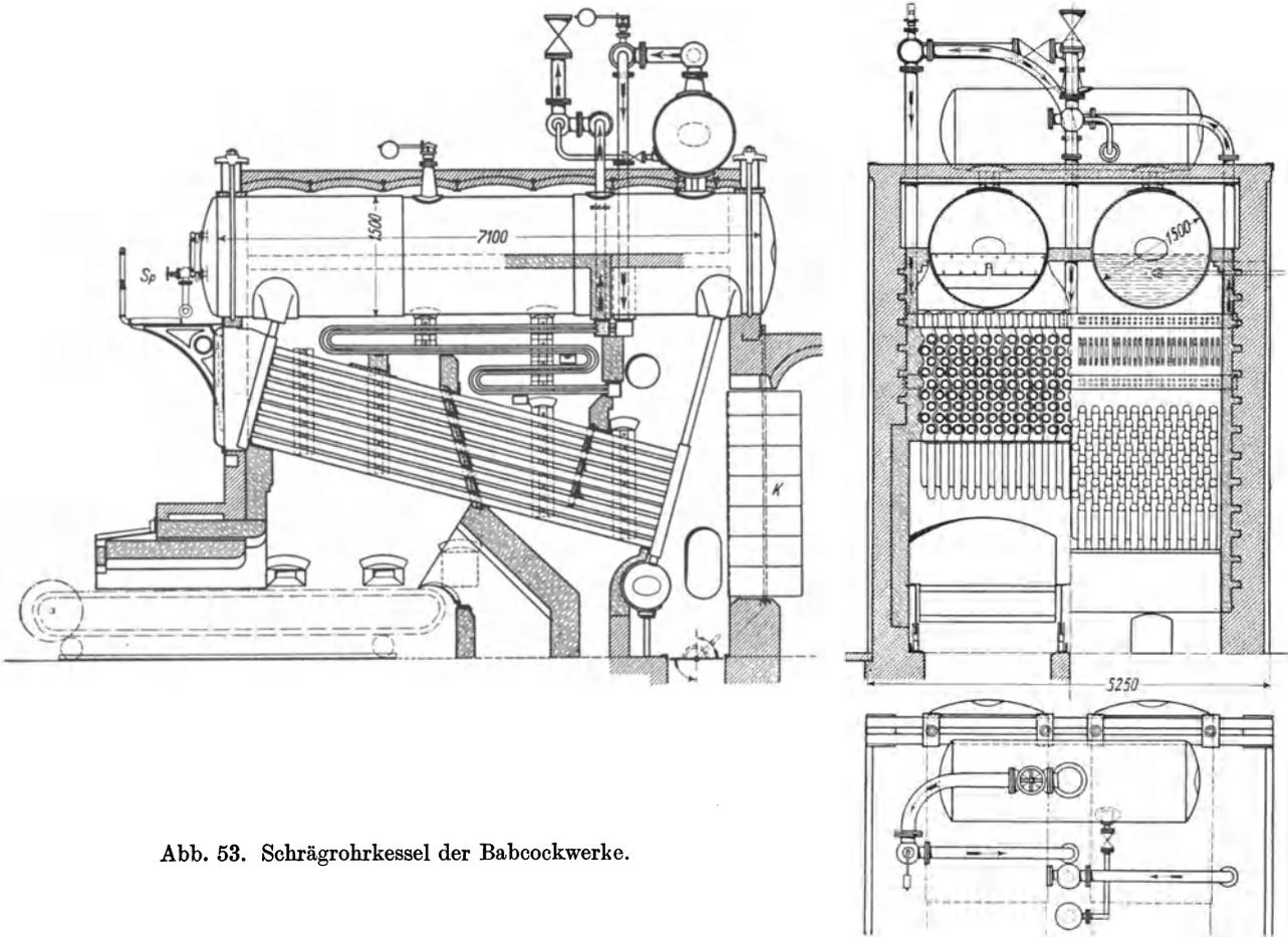
Abb. 53. Schrägröhrenkessel der Babcockwerke.
