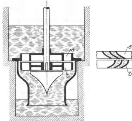
Abb. 160. Axiale Überdruckturbine.
