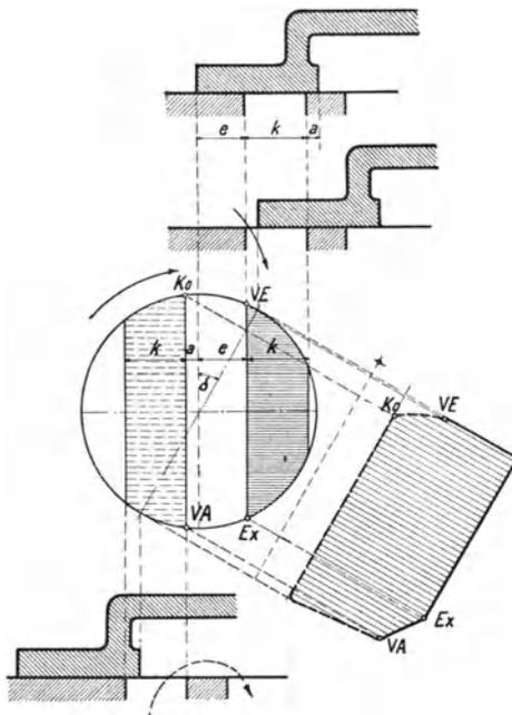
Abb. 111. Schieberdiagramm von Müller.
