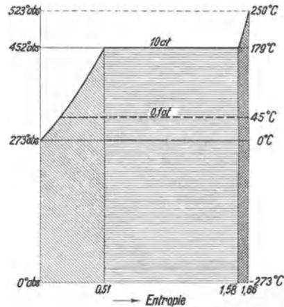
Abb. 14.  $Ts$ -Diagramm für die Erzeugung von Wasserdampf von 10 at und  $250^\circ$ .
