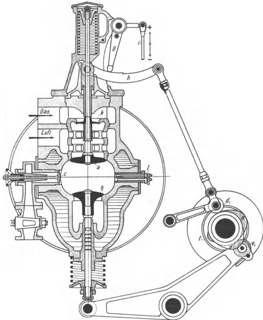
Abb. 442. Querschnitt eines Deutzer Gasmotors.
