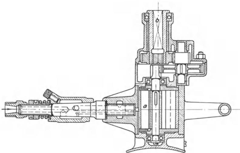
Abb. 405. Druckluftdrehbohrmaschine der Demag.
