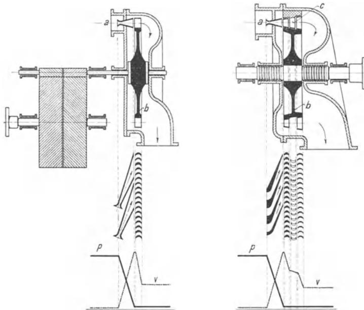
Abb. 167. Dampfturbine von de Laval (links) und Curtis (rechts).
