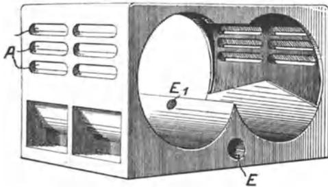
Abb. 382. Gehäuse eines englischen Pfeilradmotors.
