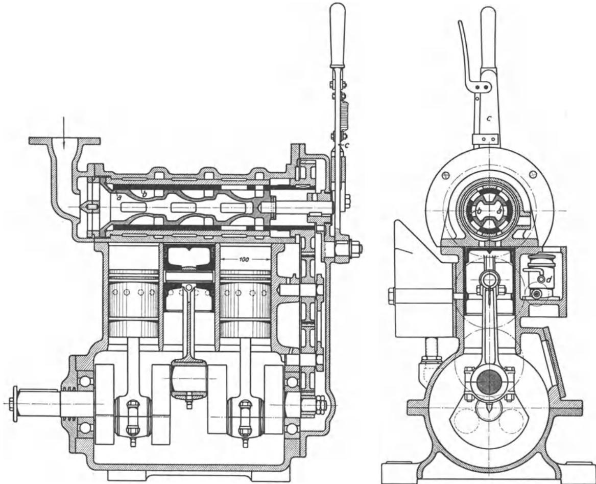
Abb. 375. Umsteuerbarer Blockmotor von Gebr. Eickhoff, Bochum.
