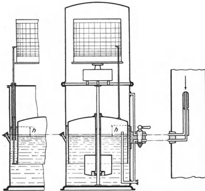
Abb. 493. Differenzdruckmesser mit Tauchglocke und zylindrischem Schwimmer. (de Bruyn.)
