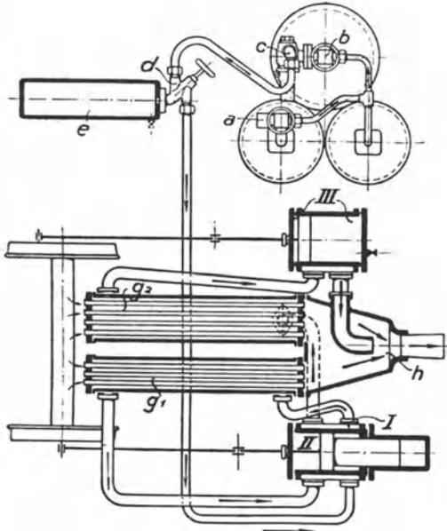
Abb. 419. Druckluftlokomotive mit dreistufiger Expansion (Schwartzkopff).
