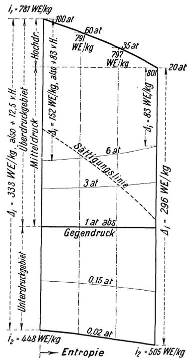
Abb. 18.  $is$ -Diagramm für sehr hohe Dampfdrucke.
