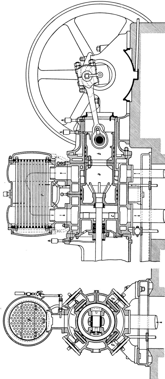
Abb. 334. Einzylindriger Stufenkompressor für Dampfantrieb.
