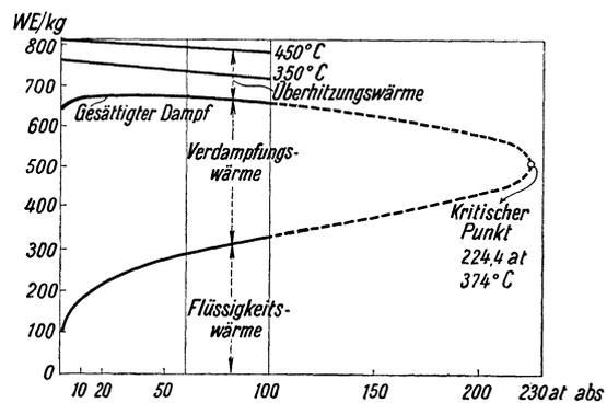
Abb. 11. Erzeugungswärme des Wasserdampfes in Abhängigkeit vom Druck.
