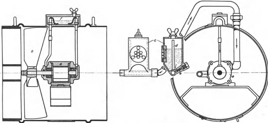
Abb. 431. Anordnung eines Luttenventilators nebst Schmierung.
