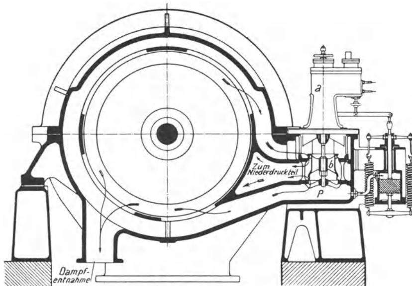
Abb. 201. Entnahmeturbine der MAN.
