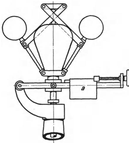
Abb. 99. Regler, dessen Drehzahl durch Verschieben eines Laufgewichtes verändert wird.
