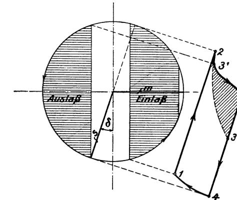
Abb. 338. Schieberdiagramm einer Kompressorsteuerung.
