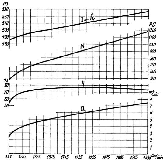
Abb. 311. Kennlinien einer Kreiselpumpe in Abhängigkeit von der Drehzahl.
