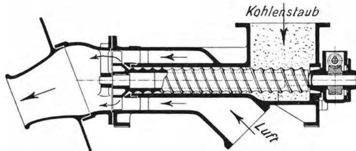
Abb. 38. Kohlenstaubbrenner der AEG.
