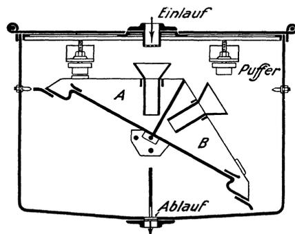
Abb. 497. Kippwassermesser von J. C. Eckardt.
