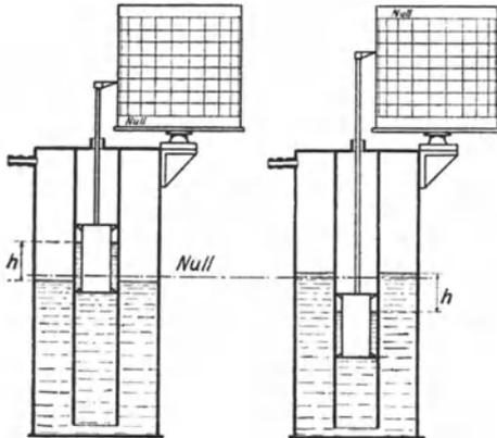
Abb. 490. Schreibendes Flüssigkeitsmanometer in Gefäßform.
