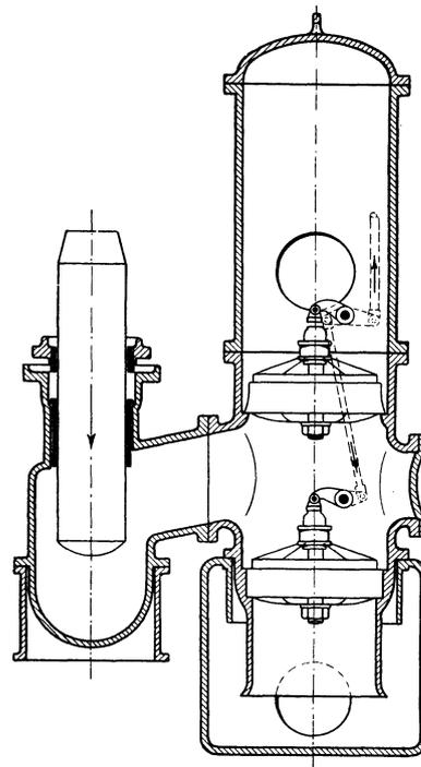
Abb. 291. Gesteuerte Pumpenventile.
