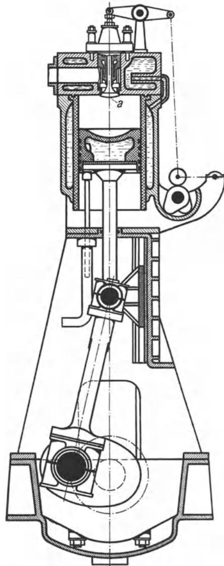
Abb. 461. Große Dieselmachine mit Kreuzkopf.
