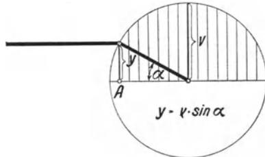
Abb. 92. Zusammenhang zwischen Kurbelzapfen und Kolbengeschwindigkeit.
