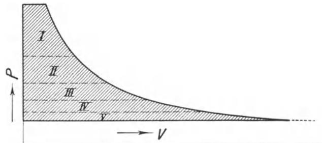
Abb. 165. Mehrstufige Ausnützung des Dampfes.
