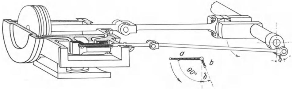
Abb. 108. Muschelschiebersteuerung.
