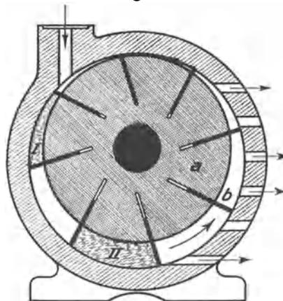
Abb. 377. Schema des Drehkolbenmotors.
