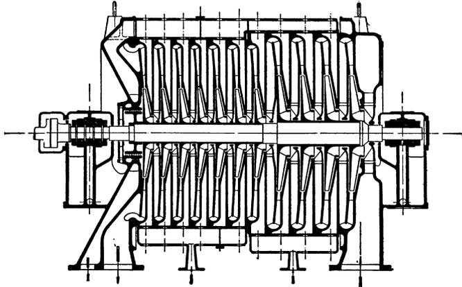
Abb. 358. Turbokompressor mit Mantelkühlung.
