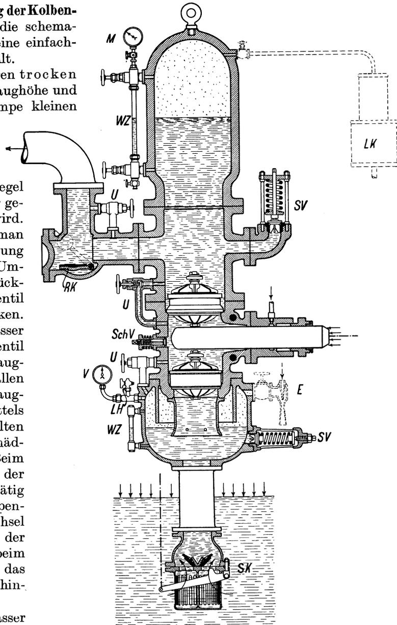
Abb. 282. Plungerpumpe nebst Ausrüstung.
