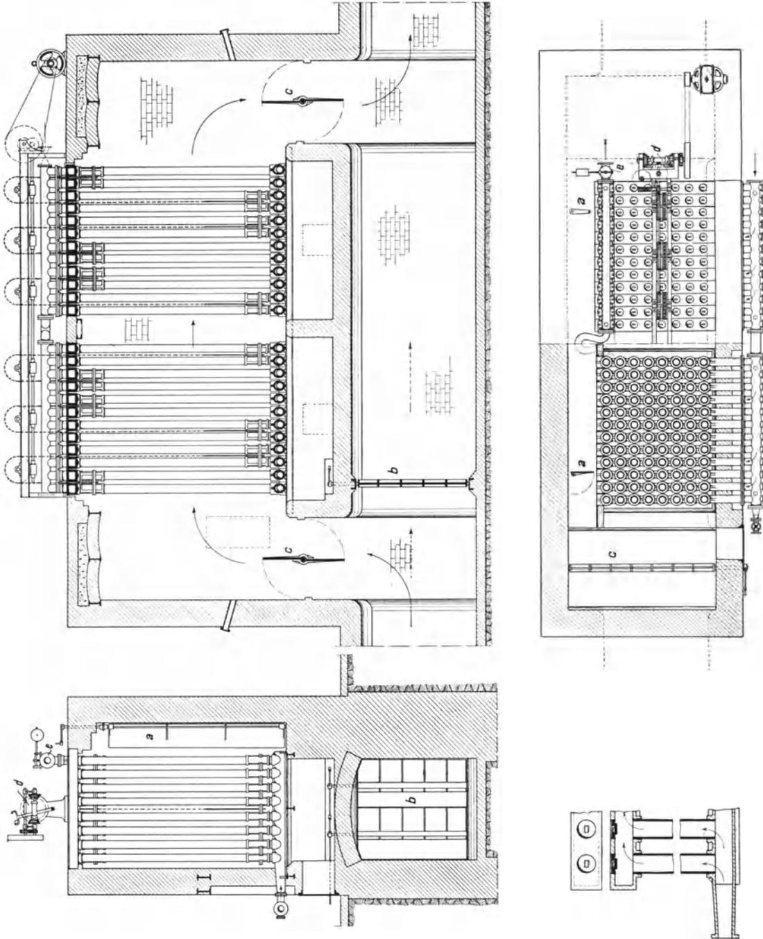
Abb. 74. Rauchgasvorwärmer mit gußeisernen Röhren.
