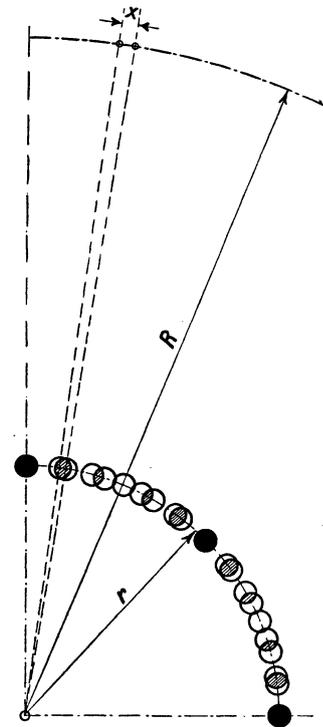
Abb. 219. Differentialteilung der Schraubenlöcher.
