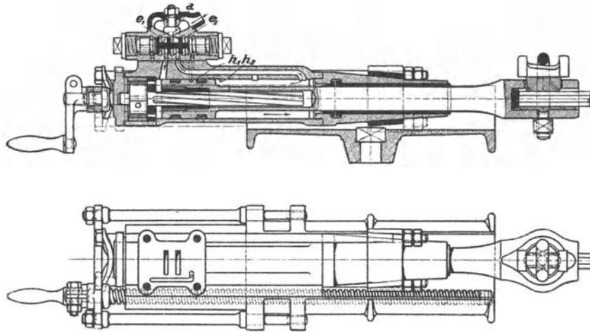
Abb. 403. Stoßende Gesteinbohrmaschine der Demag.
