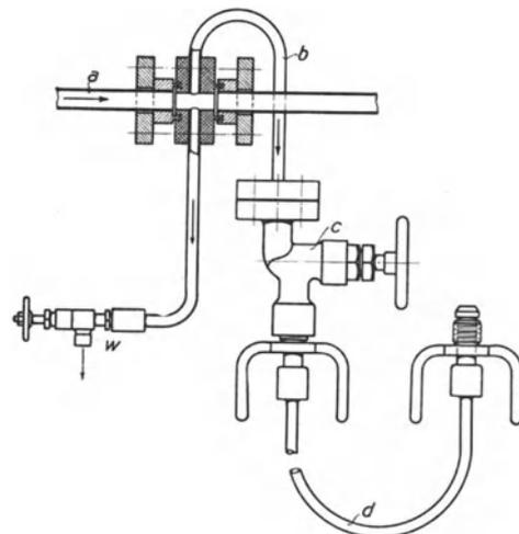
Abb. 421. Fülleitung für Druckluftlokomotiven.
