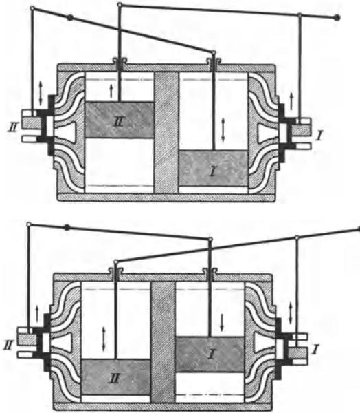
Abb. 301. Schema der Duplexpumpe.
