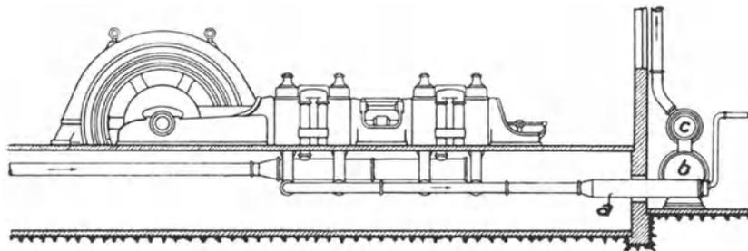
Abb. 452. Ausnützung der Auspuffwärme von Gasmaschinen in Abwärmekesseln.
