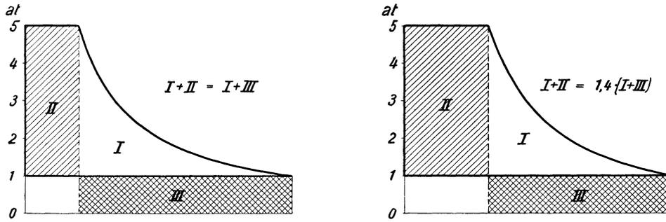
Abb. 8. Isothermische Kompressor- bzw. Motorarbeit. Abb. 9. Adiabatische Kompressor- bzw. Motorarbeit.
