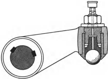
Abb. 241. Kugelkopf für Knaggensteuerung.
