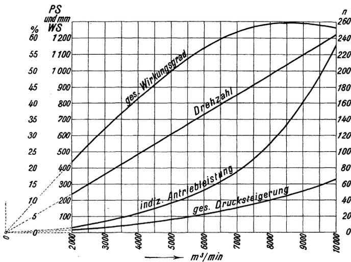
Abb. 427. Kennlinien eines Hauptgrubenventilators bei veränderlicher Drehzahl.
