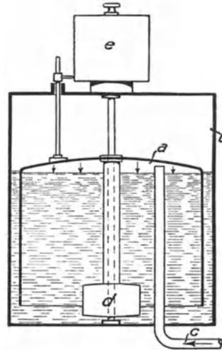
Abb. 491. Druckmessung mittels Tauchglocke.
