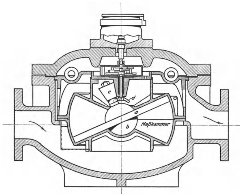
Abb. 499. Scheibenwassermesser von Siemens &amp; Halske A.-G.
