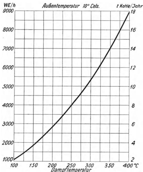
Abb. 79. Abkühlungsverlust für 1 m<sup>2</sup> nackter Rohroberfläche in WE/h und in t Steinkohle für 1 Jahr bei 10° Außentemperatur.
