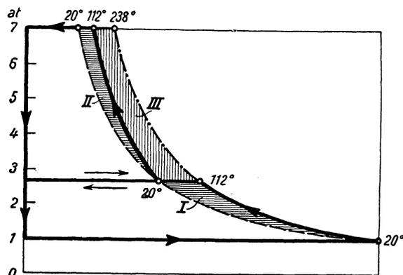
Abb. 332. Diagramm des zweistufigen Kompressors.
