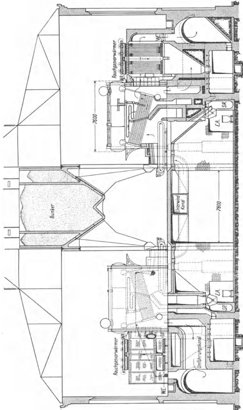
Abb. 24. Wasserröhrenkesselanlage mit Rauchgasvorwärmern.
