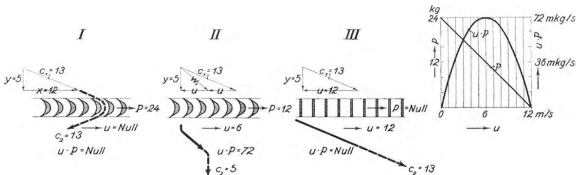
Abb. 163. Wirkung der Gleichdruckturbine.
