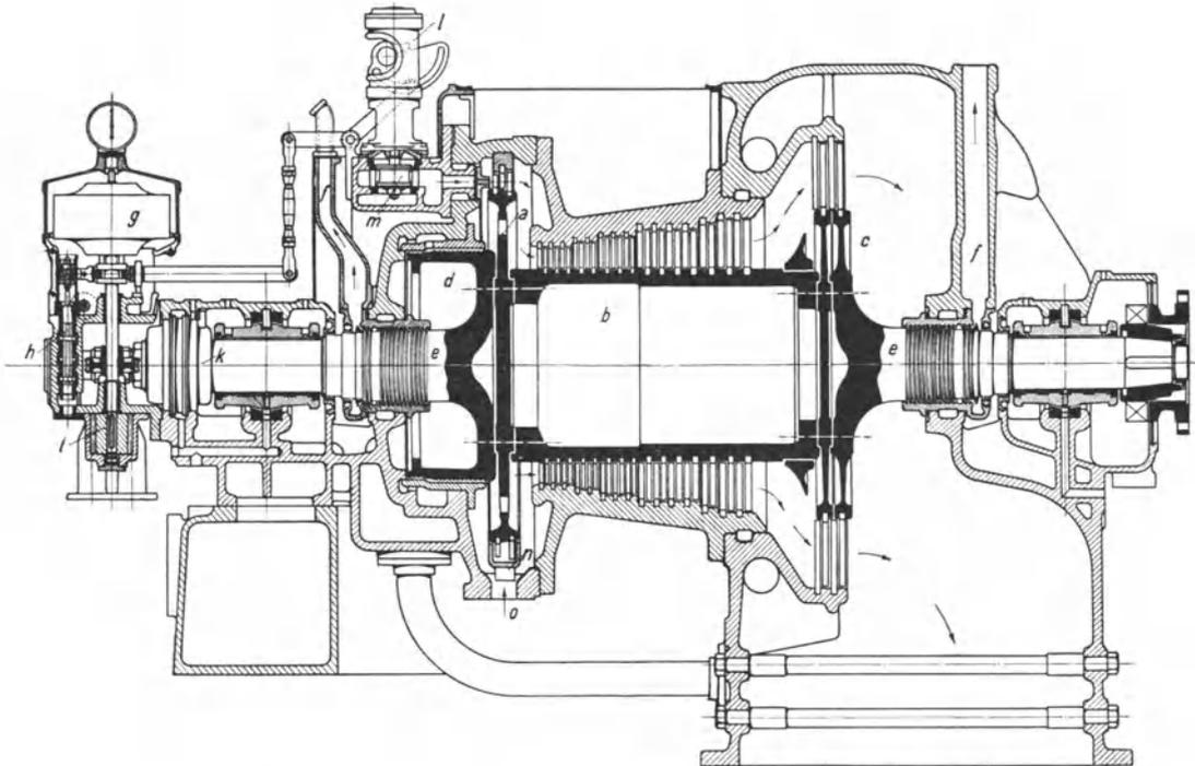
Abb. 186. Dampfturbine der Maschinenfabrik Thyssen & Co.
