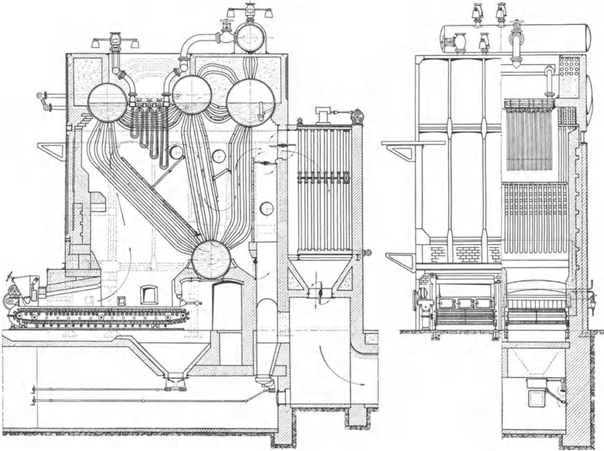
Abb. 57. Stirling-Kessel der Hanomag.
