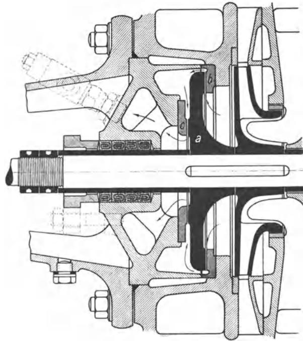
Abb. 319. Ausgleich des Axialschubes mittels Entlastungsscheibe (R. Wolf, Magdeburg).
