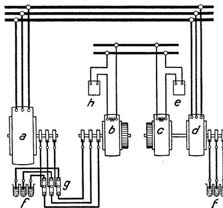
Abb. 484. Reguliergetriebe mit Energierückgabe ins Netz.
