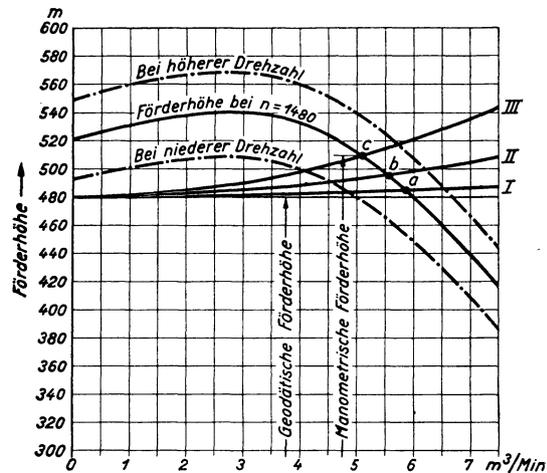
Abb. 312. Änderung der Fördermenge bei Änderung der zu überwindenden Druckhöhe.
