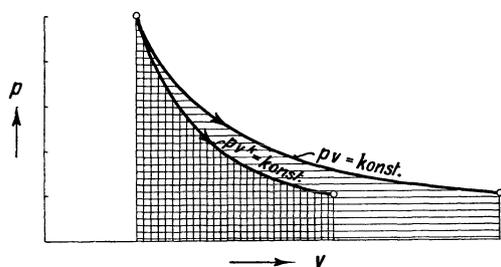
Abb. 6. Vergleich zwischen isothermischer und adiabatischer Expansion.
