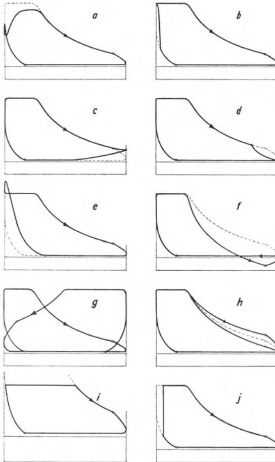
Abb. 127. Fehlerhafte Dampfdiagramme.
