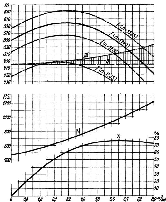
Abb. 310. Kennlinien einer Kreiselpumpe in Abhängigkeit von der Fördermenge.
