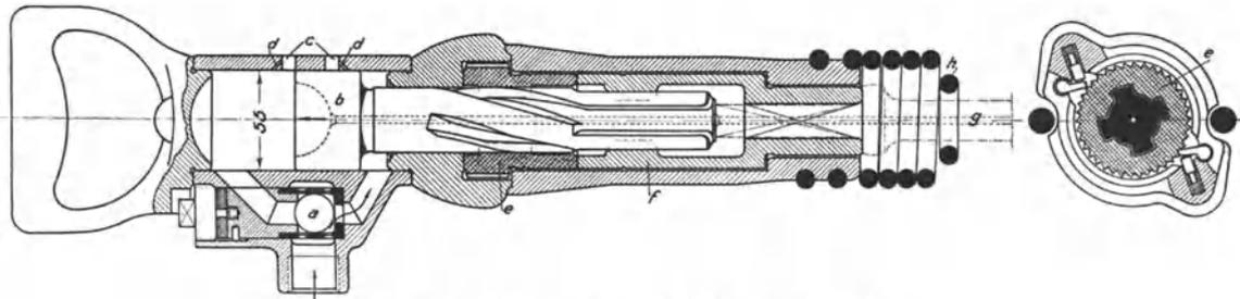
Abb. 402. Bohrhammer von H. Flottmann & Co.
