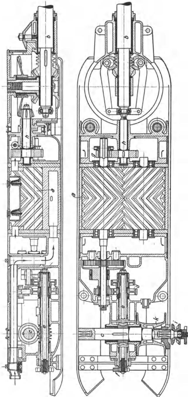
Abb. 394. Schrämmaschine von Flotmann & Co. mit Antrieb durch Pfeilradmotor.
