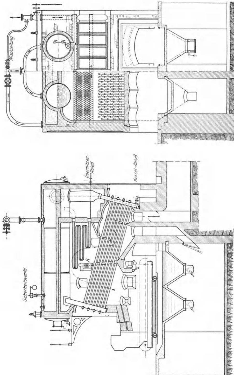
Abb. 51. Schrägrohrkessel von L. & C. Steinmüller.
