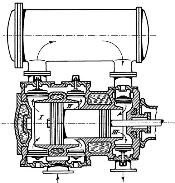
Abb. 333. Einzylindriger Stufenkompressor (Flottmann).
