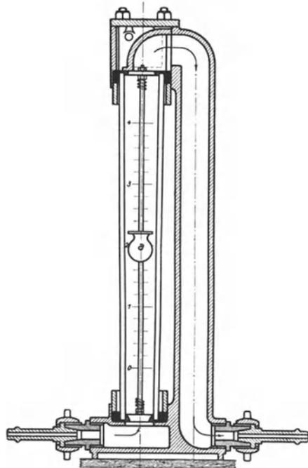
Abb. 520. Anzeigender Druckluftmesser der Demag.
