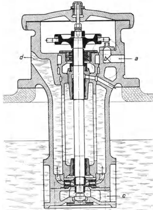
Abb. 176. Hilfsölpumpe für Dampfturbine (Thyssen).
