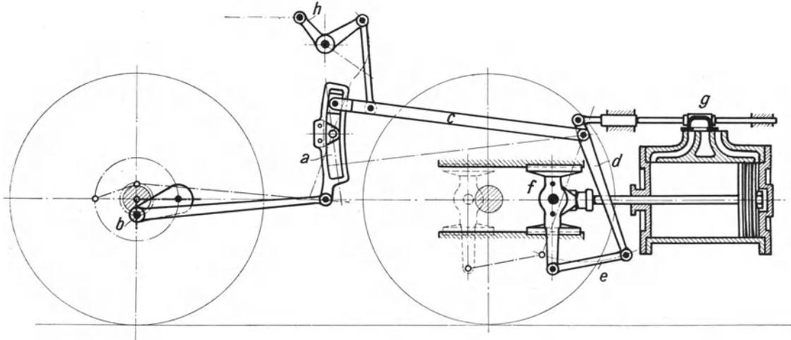
Abb. 119. Heusinger-Steuerung einer Druckluftlokomotive.
