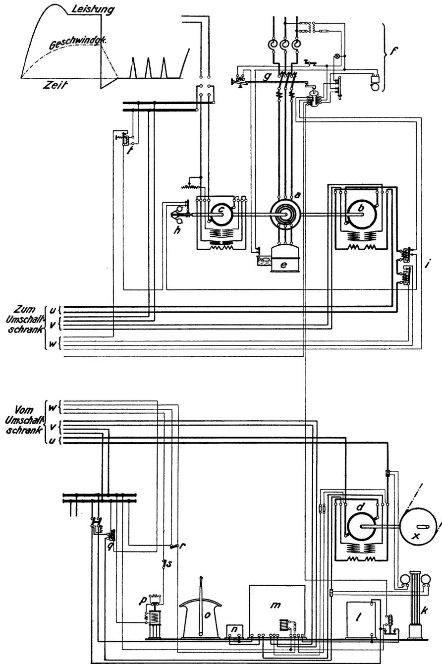
Abb. 475. Gleichstromfördermaschine mit Leonardschaltung und schwungradlosem Umformer.
