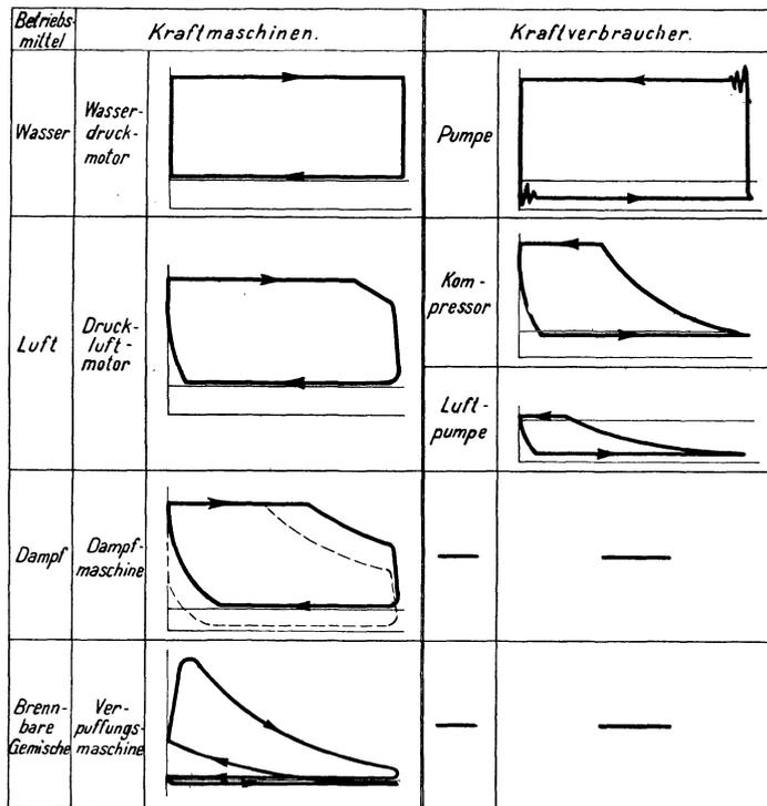
Abb. 86. Diagramm der wichtigsten Kolbenmaschinen.
