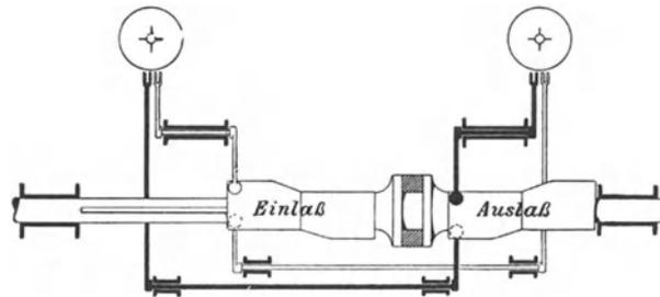
Abb. 243. Steuerwelle mit 4 Knaggen.
