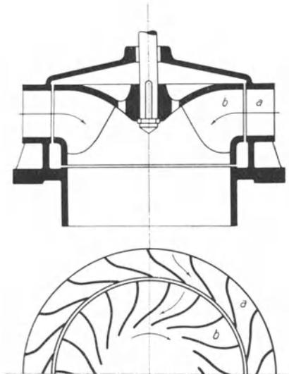
Abb. 161. Radiale Überdruckturbine (Francis-Turbine).
