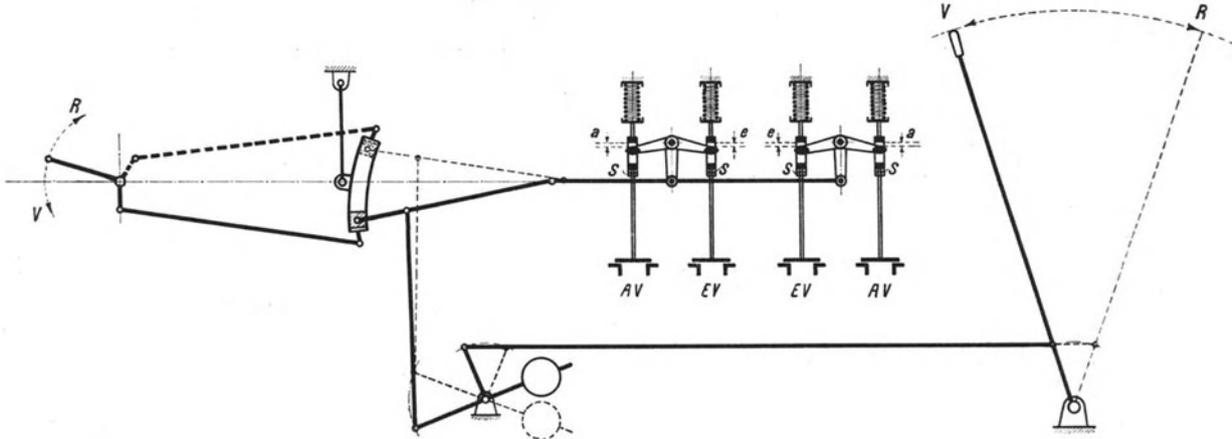
Abb. 240. Kulissensteuerung mit Ventilen.
