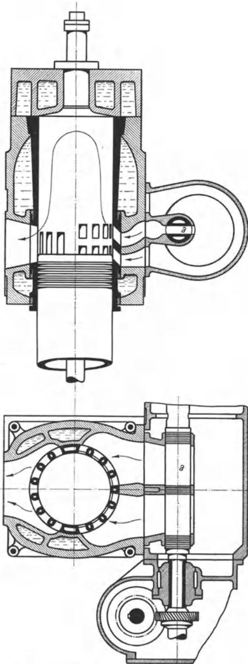
Abb. 460. Zweitakt-Schlitzspulmaschine von Gebr. Sulzer.
