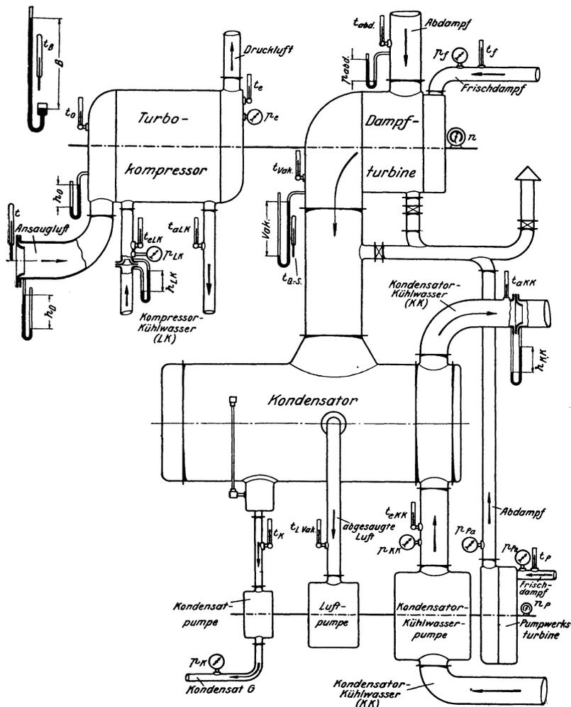
Abb. 363. Meßanordnung für Turbokompressoren.
