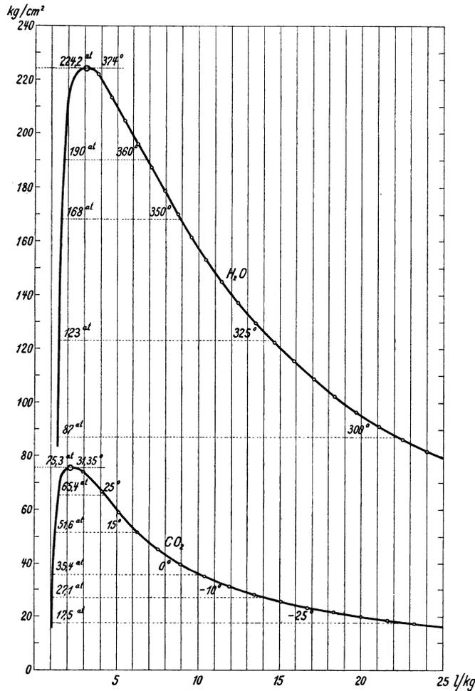
Abb. 1. Grenzkurven für Flüssigkeit und Dampf.
