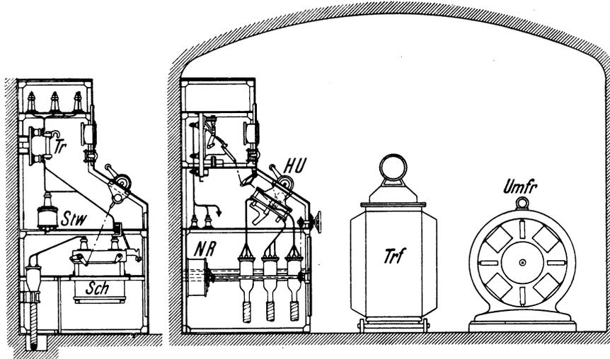
Abb. 480. Aufbau einer Einankerumformeranlage.
