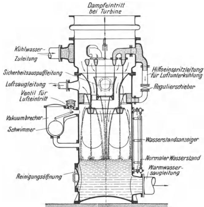
Abb. 137. Mischkondensator (MAN.).
