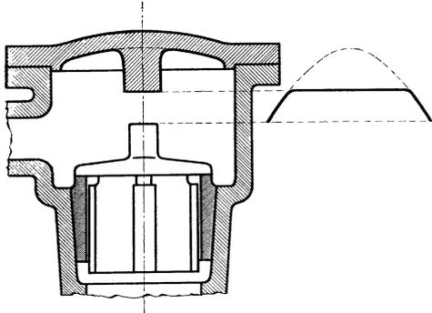
Abb. 285. Einsitziges Pumpenventil.
