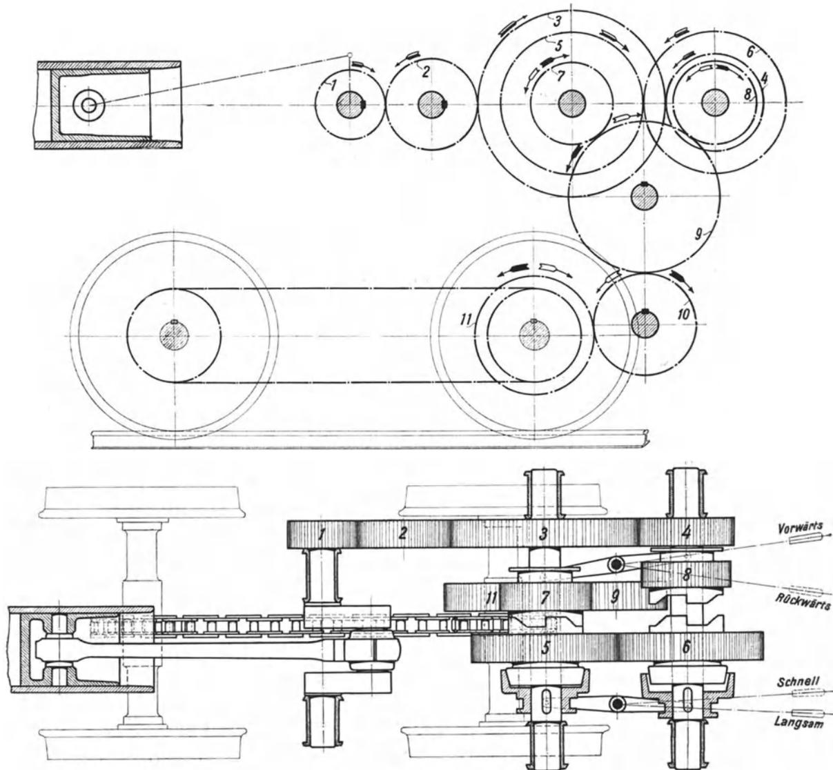
Abb. 466. Getriebe einer Benzolgrubenlokomotive älterer Bauart.
