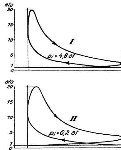
Abb. 449. Diagramme der Thyssenschen Großgasmaschine mit Leistungssteigerung.
