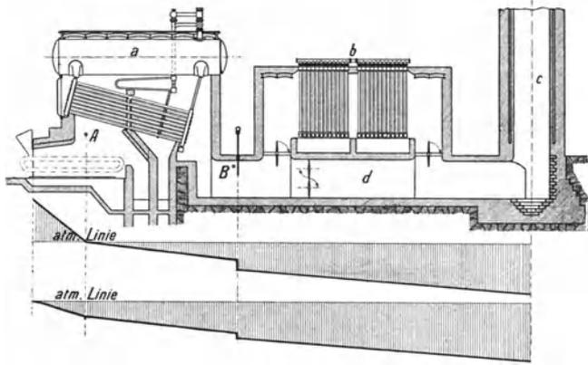
Abb. 40. Zugverhältnisse einer Kesselanlage.
