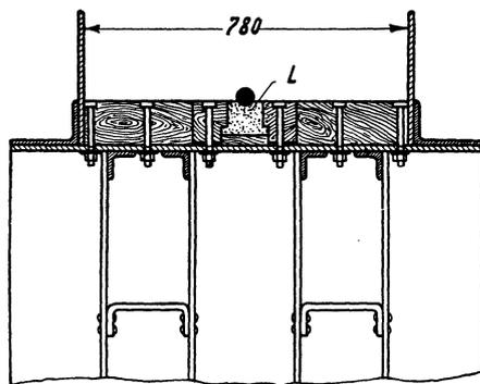
Abb. 224. Treibscheibe mit breitem Kranz und Lederfütterung (L).
