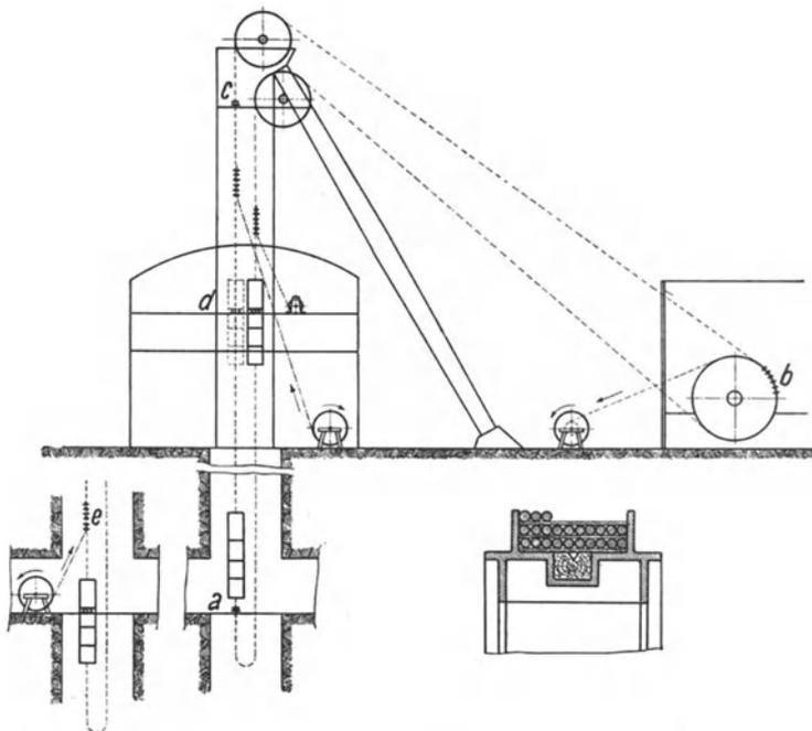
Abb. 236. Seilauflegen bei einer Treibscheibe mit breitem Kranz.
