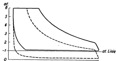
Abb. 130. Auspuff- und Kondensationsdiagramm für gleiche Leistung.
