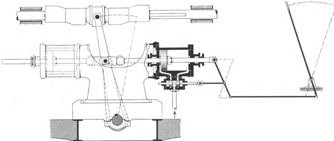
Abb. 248. Dampfsteuerung der Fördermaschine.
