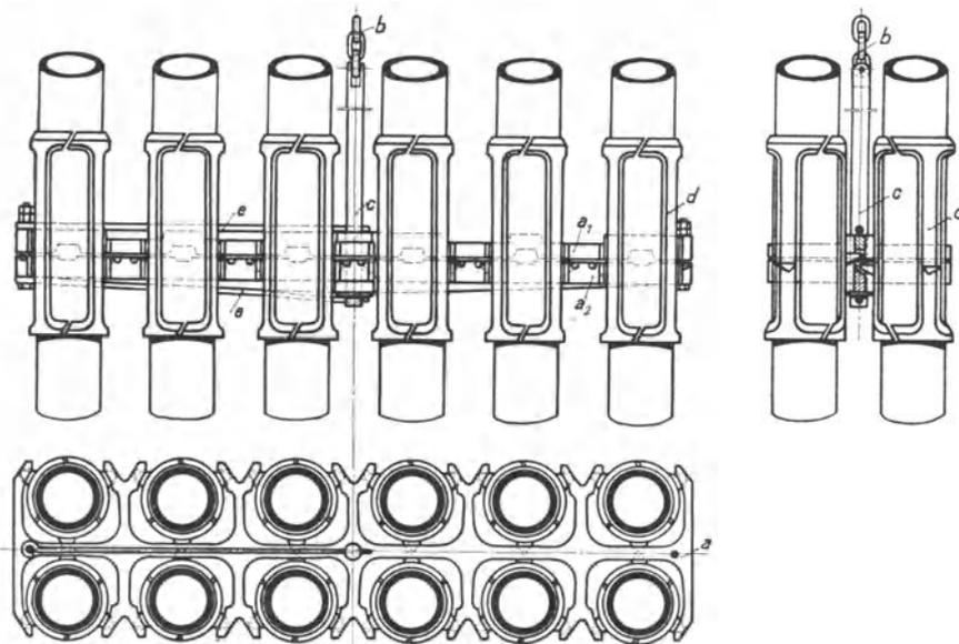
Abb. 76. Die Schaber eines Rauchgasvorwärmers.
