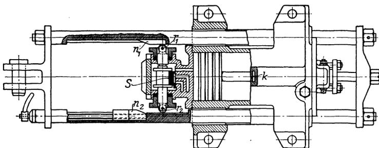
Abb. 409. Doppeltwirkender Rutschenmotor von Gebr. Eickhoff.
