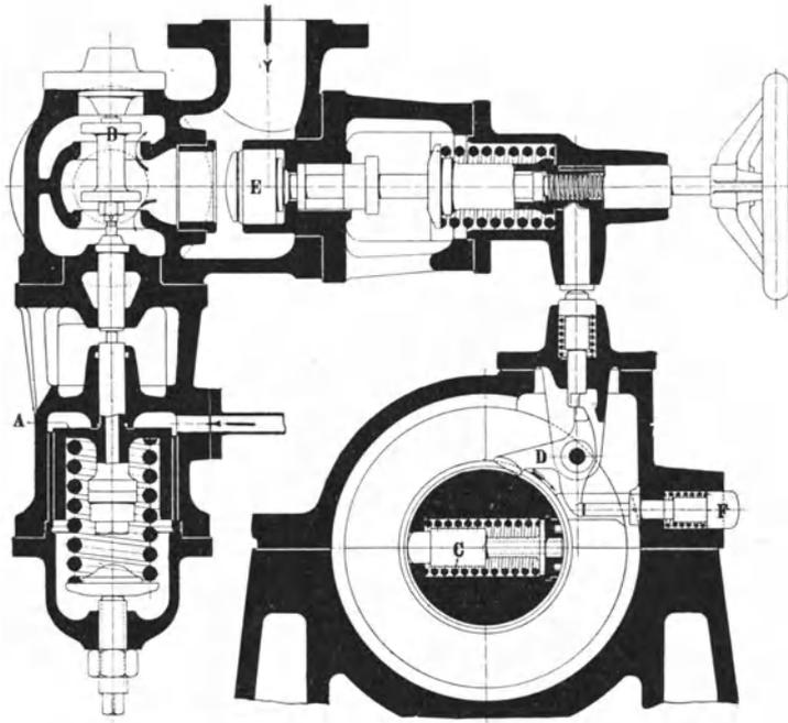
Abb. 150. Regelung der die Kondensationspumpen antreibenden Hilfsturbine (BBC.).
