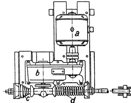
Abb. 486. Elektrischer Schüttelrutschenantrieb der SSW.
