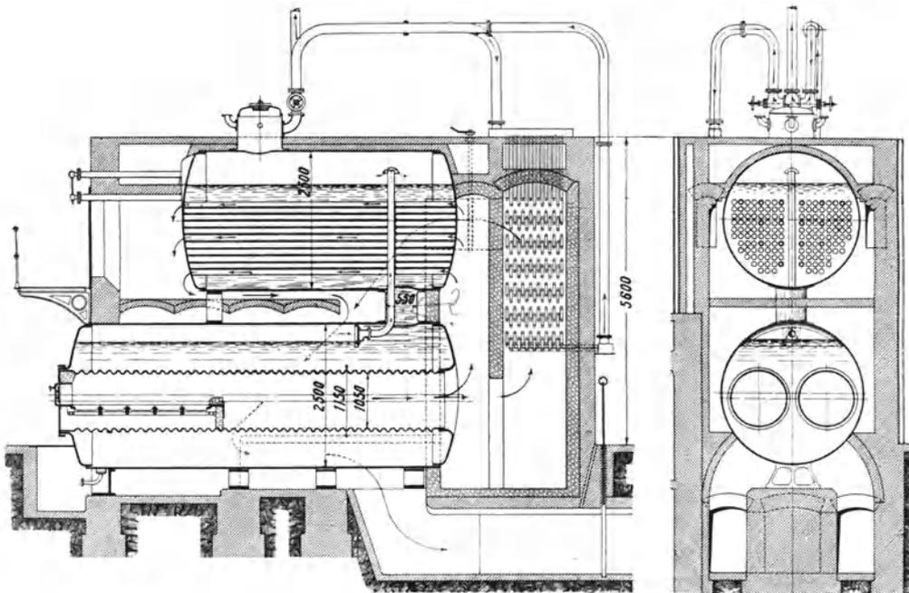
Abb. 47. Flammrohrheizröhrenkessel.
