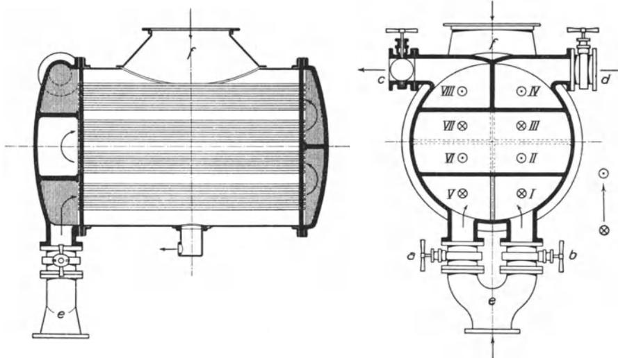
Abb. 141. Oberflächenkondensator Bauart Hülsmeier (MAN.).
