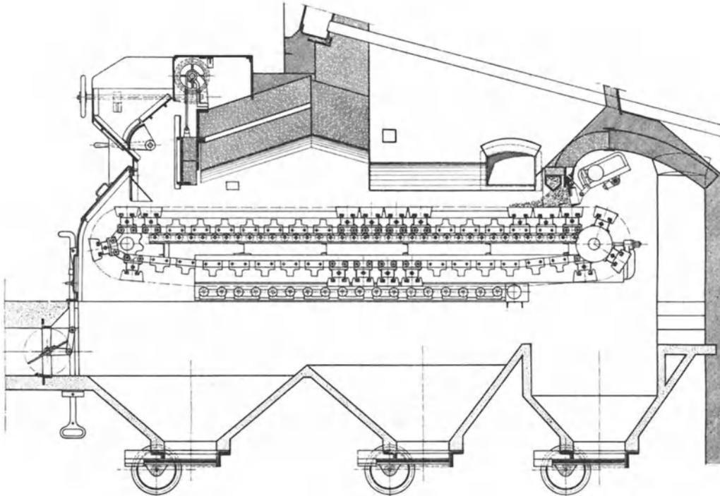
Abb. 29. Wanderrostfeuerung von L. & C. Steinmüller, mit Abschluß durch wassergekühlte Feuerbrücke und ausschwingbaren Pendelrost.
