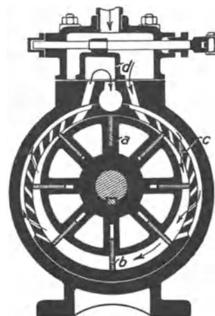
Abb. 379. Umsteuerbarer Drehkolbenmotor ohne Expansion.
