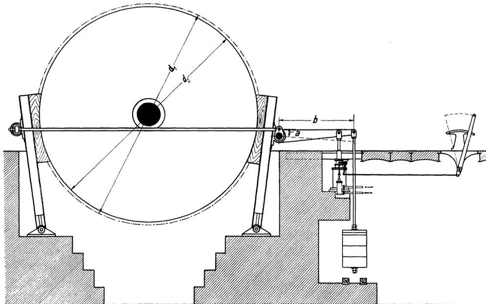
Abb. 253. Vereinigte Manövrier- und Fallgewichtbremse.
