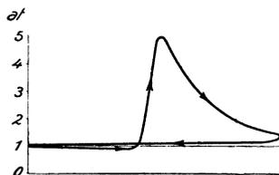
Abb. 433. Diagramm der Gasmaschine von Lenoir.
