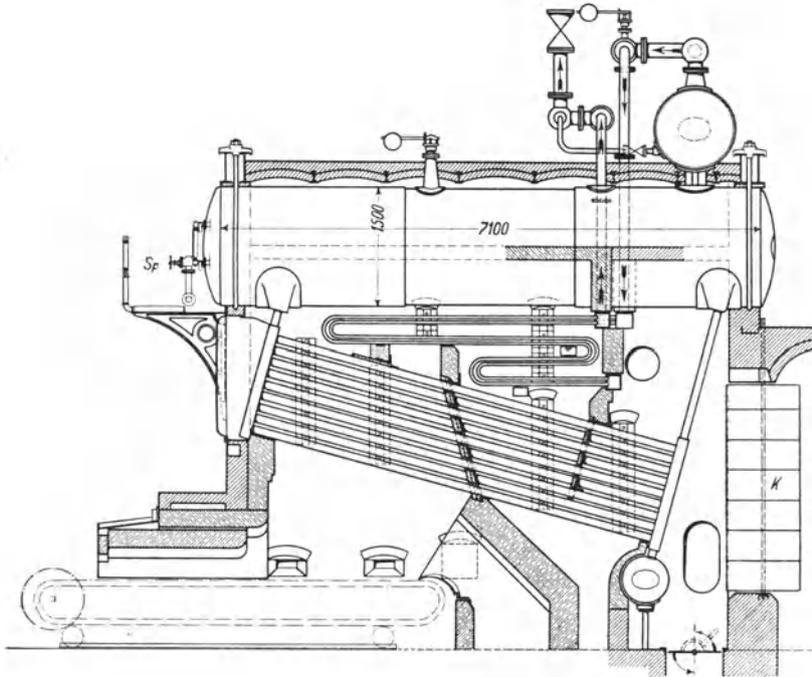
Abb. 52. Schrägröhrenkessel von Petry-Dereux.
