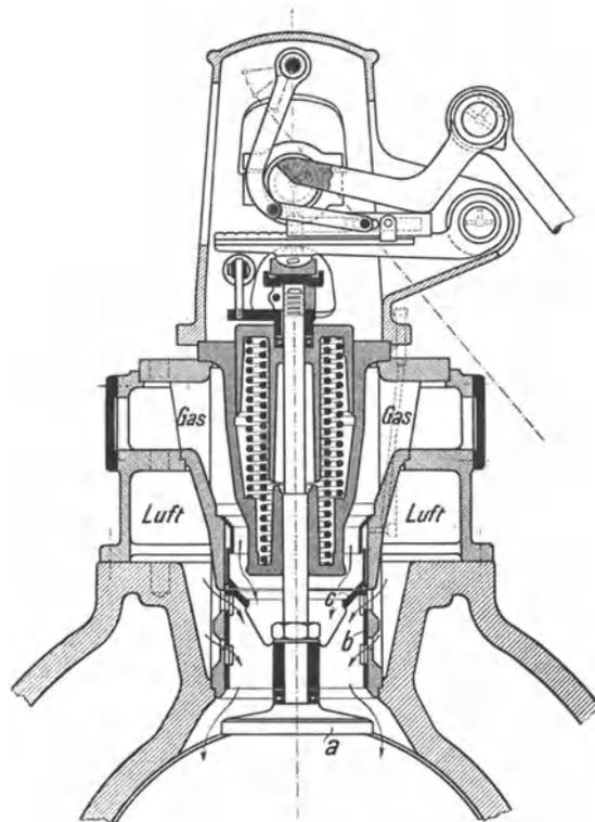
Abb. 446. Einlaßsteuerung der MAN für Großgasmaschinen.
