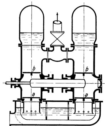
Abb. 297. Doppeltwirkende Pumpe mit durchgehendem Plunger.
