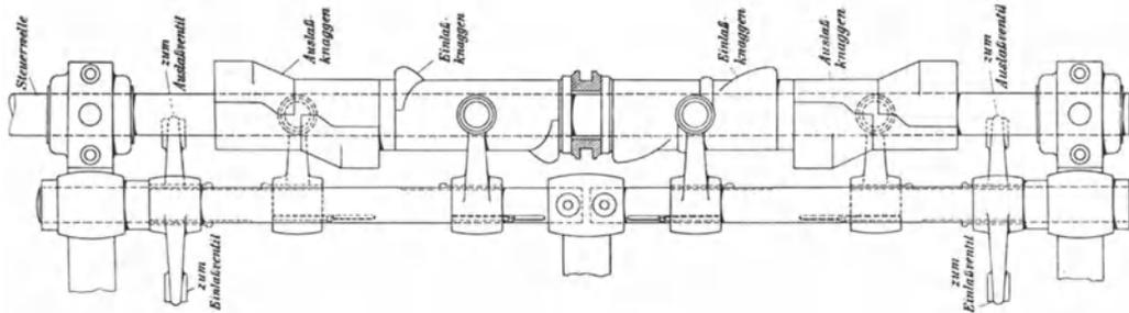
Abb. 242. Steuerwelle mit 8 Knaggen.
