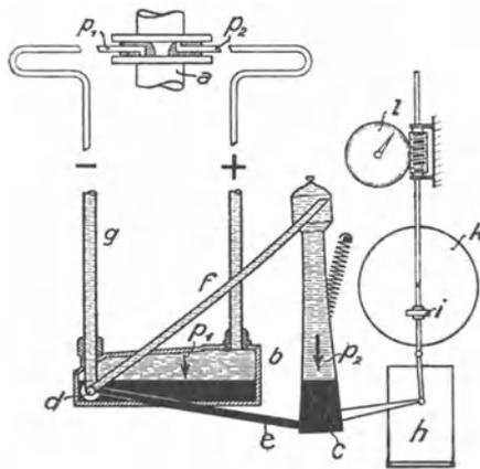
Abb. 516. Anzeigender, registrierender und zählender Dampfmesser von Gehre.
