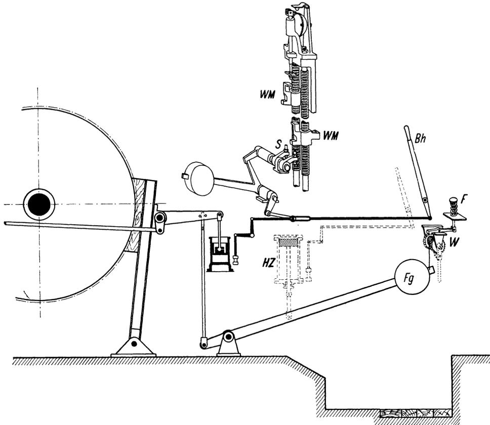
Abb. 260. Bremse, Teufenzeiger, Endauslösung.
