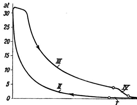
Abb. 459. Diagramm der Zweitakt-Dieselmotore.
