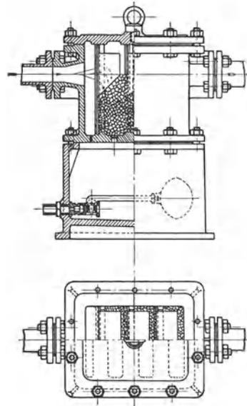
Abb. 368. Wasserabscheider für Druckluft mit Quarzfilter.
