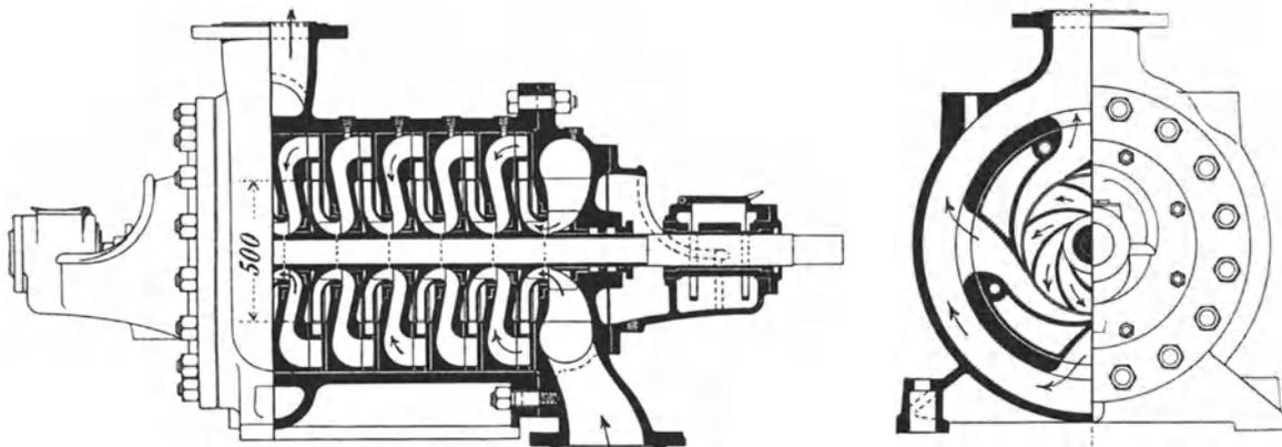
Abb. 318. 5stufige Hochdruckkreiselpumpe (Sulzer).
