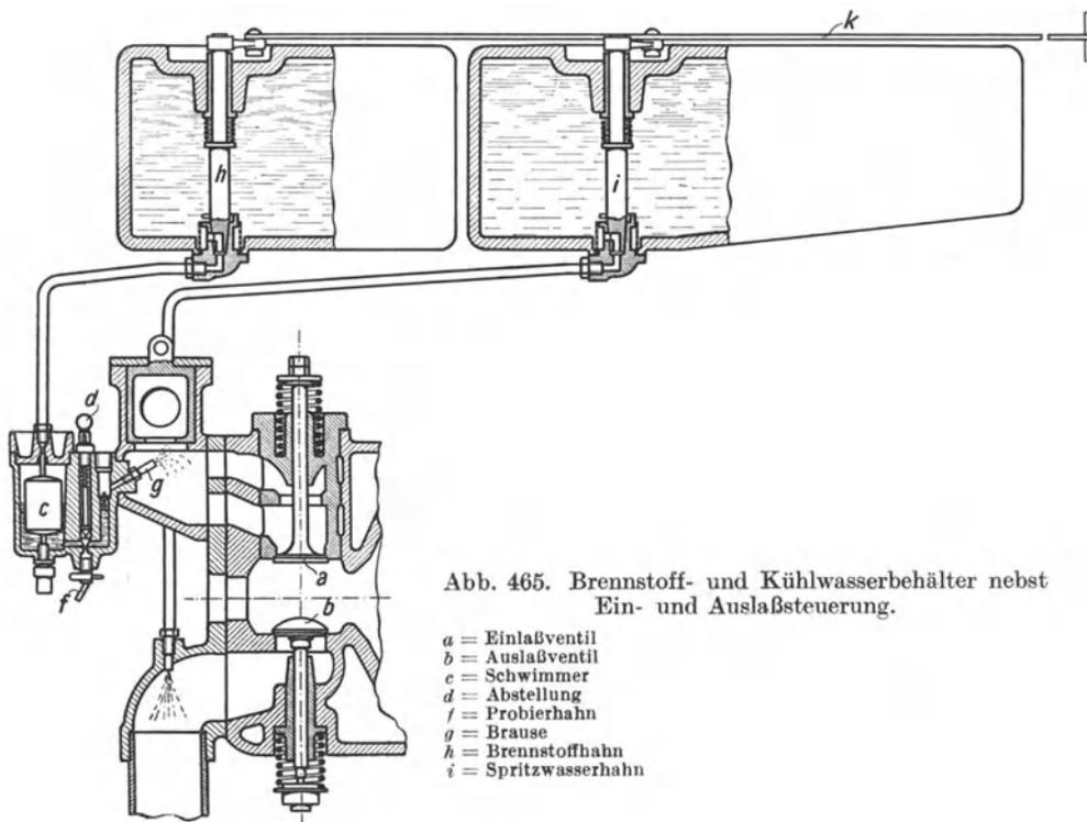
Abb. 465. Brennstoff- und Kühlwasserbehälter nebst Ein- und Auslaßsteuerung.
