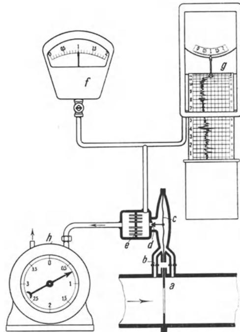
Abb. 521. Druckluftmesser der Askania-Werke, Berlin.
