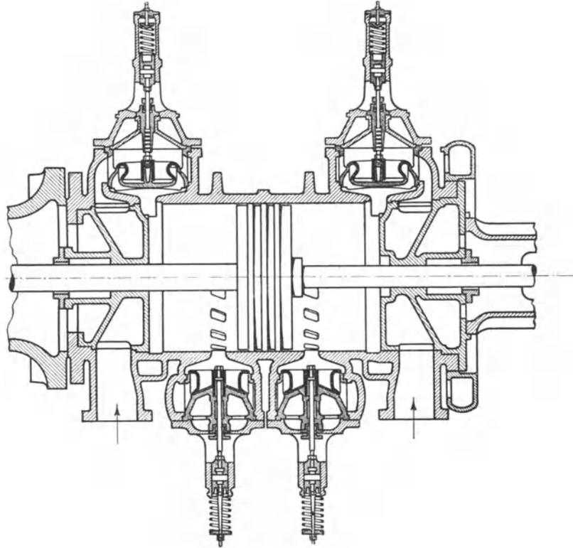
Abb. 126. Gleichstromdampfmaschine mit zwei durch Ventile gesteuerten Auslaßschlitzen.
