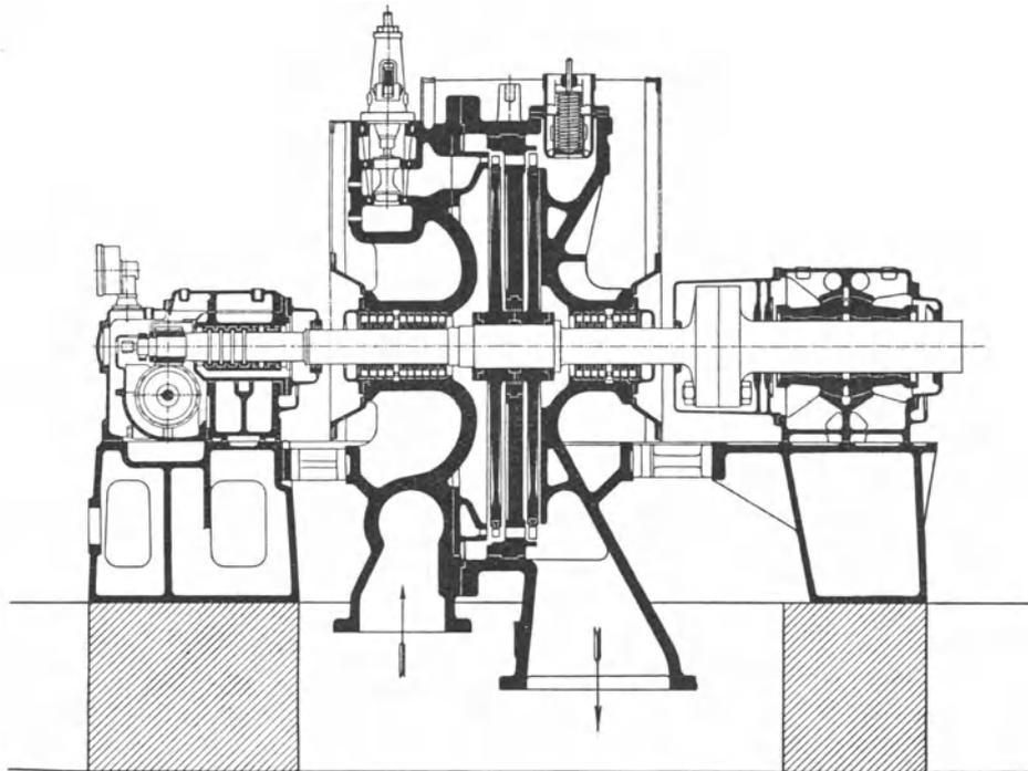
Abb. 190. Gegendruckturbine der MAN.
