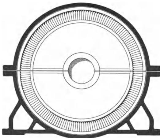
Abb. 172. Zwischenboden mit Leitschaufeln.
