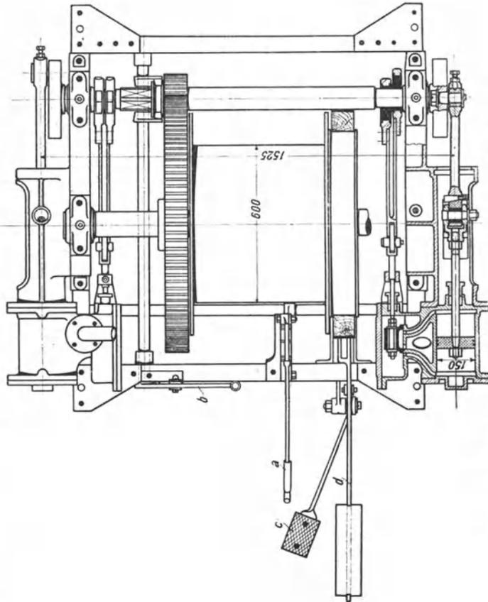
Abb. 384. Drucklufthaspel mit Zwillingsmotor (Eickhoff).
