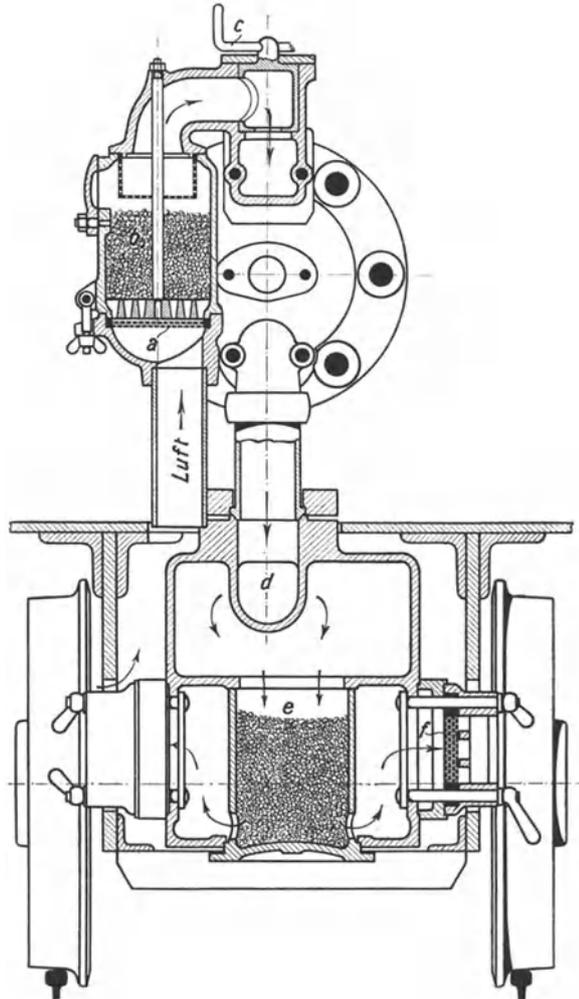
Abb. 467. Sicherung des Einlasses und des Auspuffs gegen Herausschlagen von Flammen.
