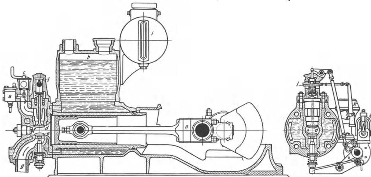
Abb. 444. Kleiner Benzolmotor der Motorenfabrik Deutz mit Verdampfungskühlung.
