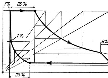
Abb. 104. Auspuffdampfdiagramm.
