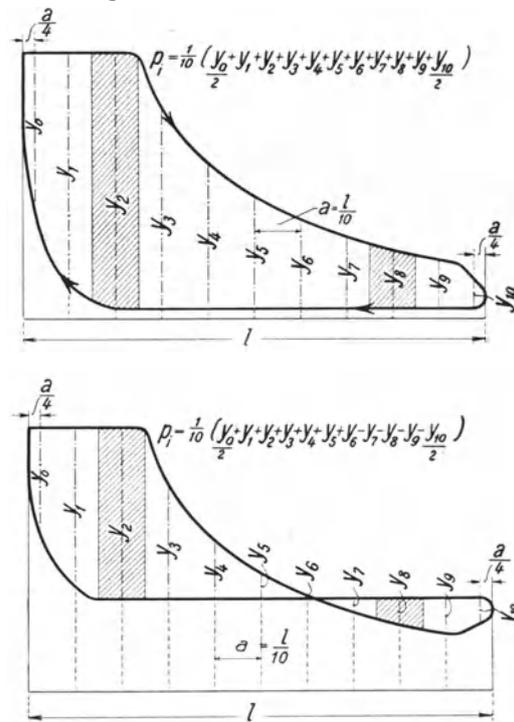
Abb. 90. Trapezregel, um den mittleren indizierten Druck  $p_i$  zu ermitteln.
