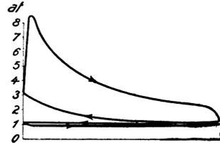
Abb. 435. Diagramm des Viertaktmotors von Otto.
