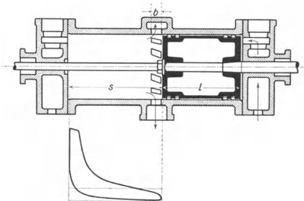
Abb. 125. Steuerung mit Auspuffschlitzen. Gleichstromdampfmaschine.
