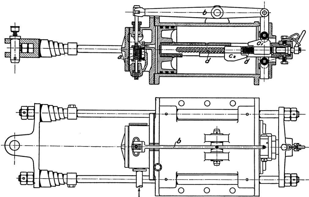
Abb. 406. Einfachwirkender Schüttelrutschenmotor von Gebr. Eickhoff, Bochum.
