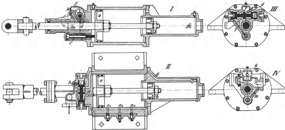
Abb. 410. Doppeltwirkender Schüttelrutschenmotor von H. Flottmann & Co., Herne.
