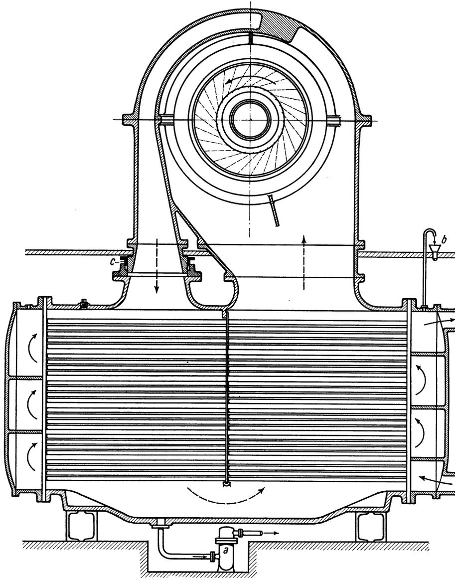
Abb. 361. Querschnitt durch einen Turbokompressor mit außenliegendem Zwischenkühler (AEG).
