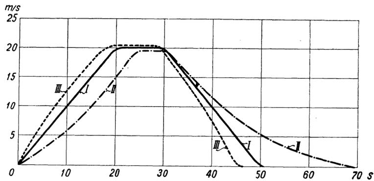
Abb. 214. Geschwindigkeitsdiagramme von Förderungen ohne und mit Seilausgleich.
