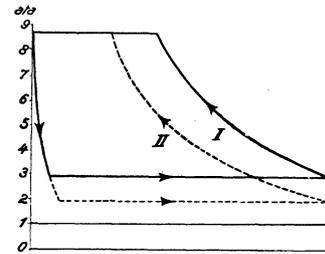
Abb. 425. Diagramme eines Ammoniakkompressors.
