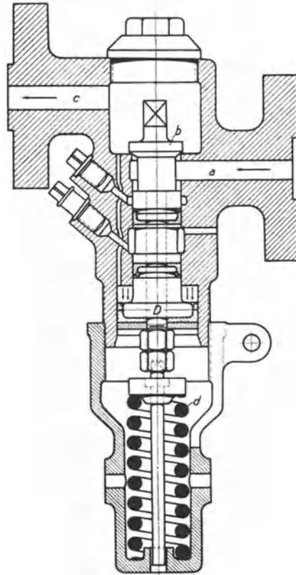
Abb. 420. Druckminderventil für Druckluftlokomotiven.
