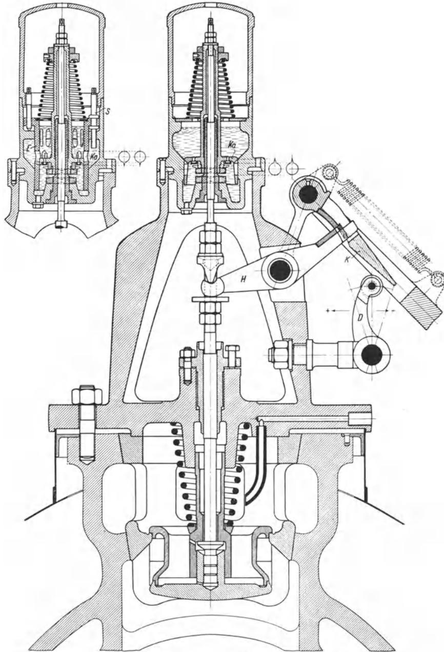
Abb. 123. Auslösende Collmann-Steuerung.
