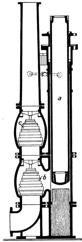
Abb. 293. Druckpumpe einer Gestängewasserhaltung.
