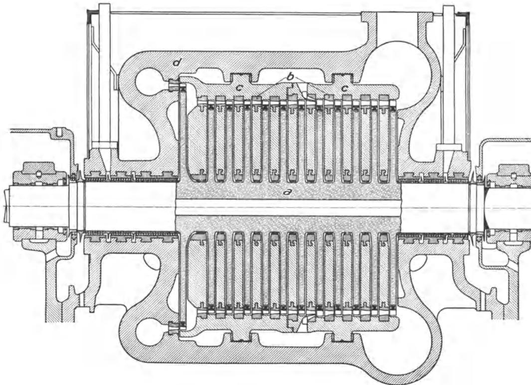
Abb. 183. Hochdruckturbine der MAN, Bauart Brünn.
