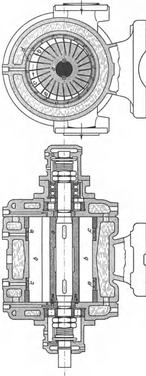
Abb. 352. Drehkolbenkompressor der Demag.
