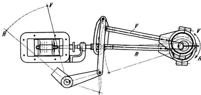
Abb. 370. Stephenson'sche Kulissensteuerung mit offenen Stangen (Eickhoff).
