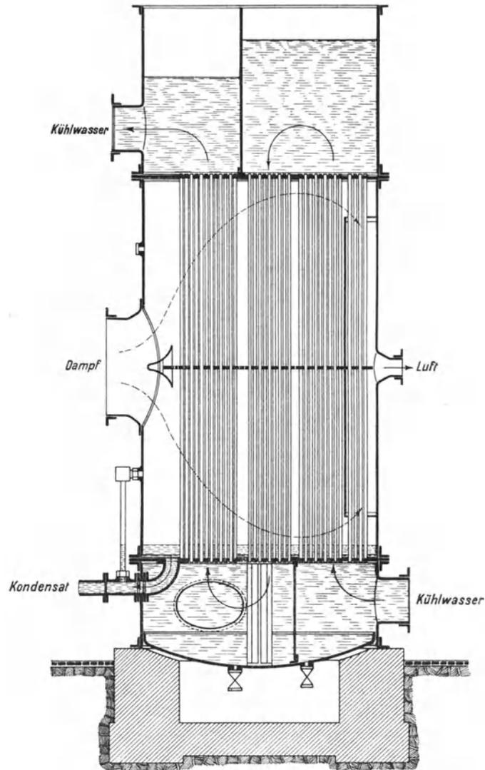
Abb. 140. Stehender Oberflächenkondensator.
