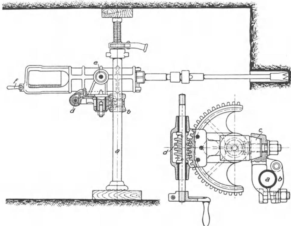
Abb. 404.. Stoßende Säulenschrämmaschine der Demag.
