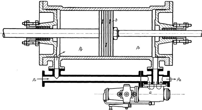
Abb. 255. Auslaßbremse mit Bremsdruckregler.
