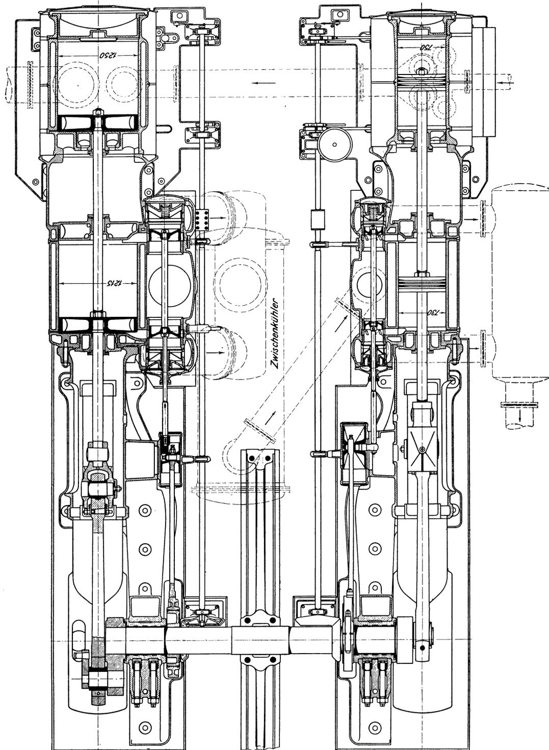
Abb. 342. Zweistufiger Kolbenkompressor mit Dampftrieb von 12000 m<sup>3</sup>/h Ansaugleistung (Neuman & Esser, Aachen).
