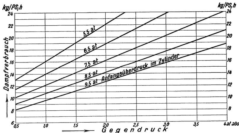
Abb. 199. Dampfverbrauch von Gegendruckkolbenmaschinen.
