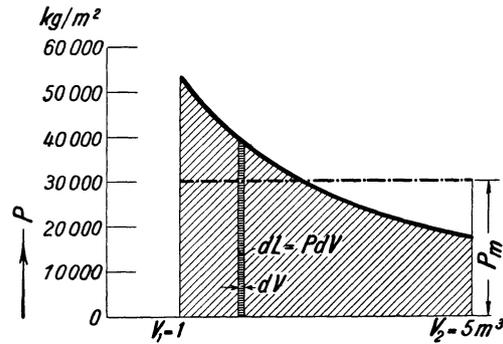
Abb. 5.  $PV$ -Diagramm.
