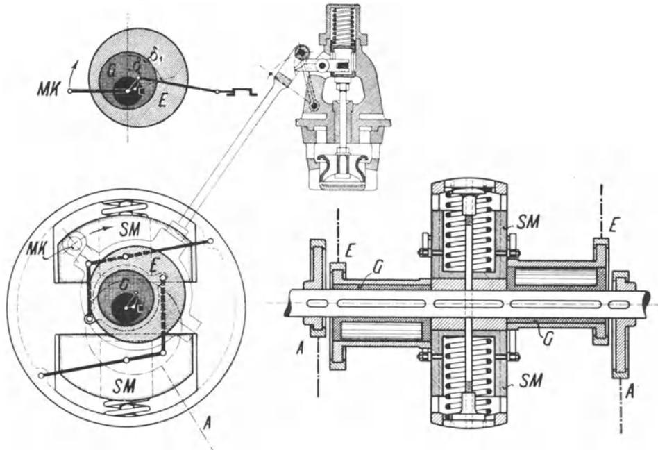
Abb. 124. Ventilsteuerng mit Achsenregler.
