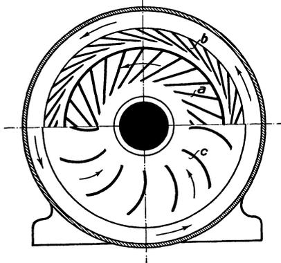
Abb. 355. Schema des Turbokompressors. üblich.
