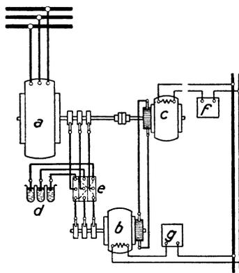
Abb. 483. Reguliergetriebe mit Gleichstromhintermotor.
