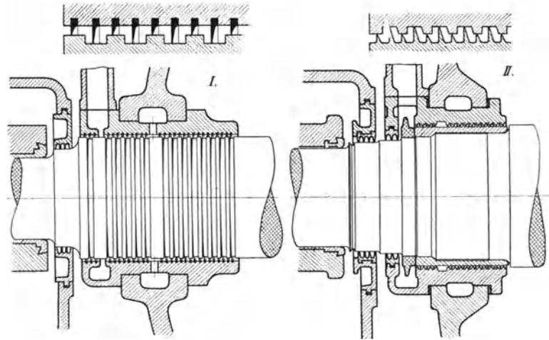
Abb. 180. Stopfbüchsen mit Labyrinthdichtung.
