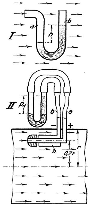
Abb. 509. Messung des dynamischen oder Staudruckes.
