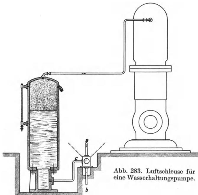
Abb. 283. Luftschleuse für eine Wasserhaltungspumpe.
