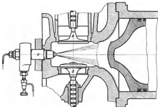
Abb. 462. Deutzer kompressorloser Dieselmotor mit Verdrängerkolben.
