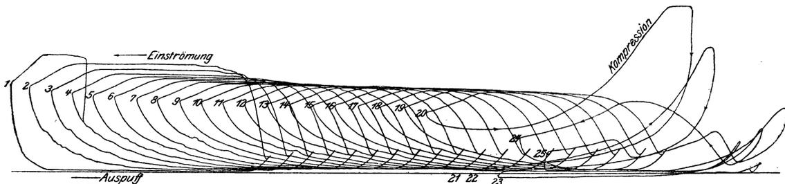
Abb. 495. Fortlaufende Diagramme einer Fördermaschine.
