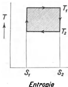
Abb. 13. Der Carnotsche Kreisprozeß im Wärmediagramm.
