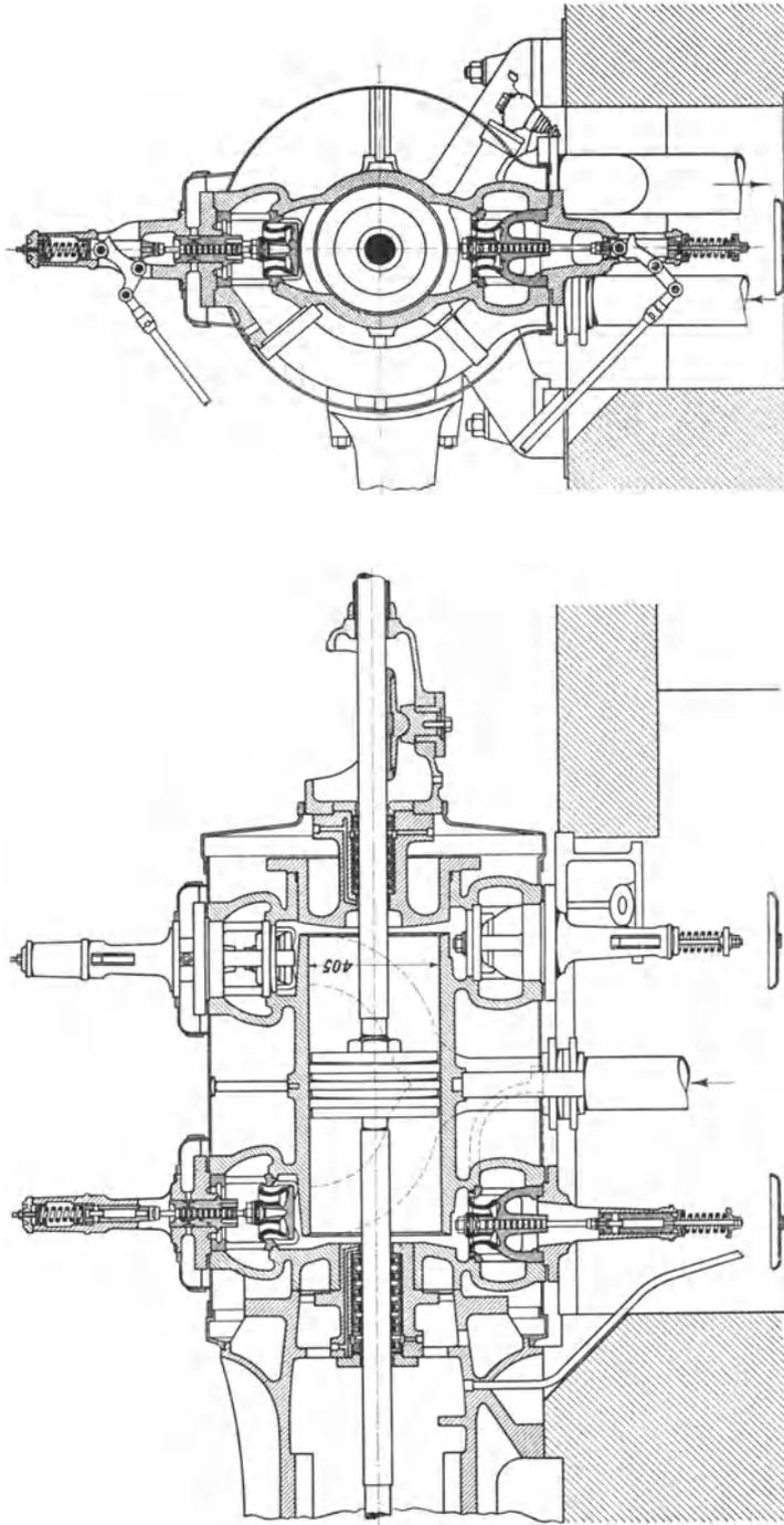
Abb. 122. Heißdampfzylinder mit Ventilsteuerung (Hanomag).
