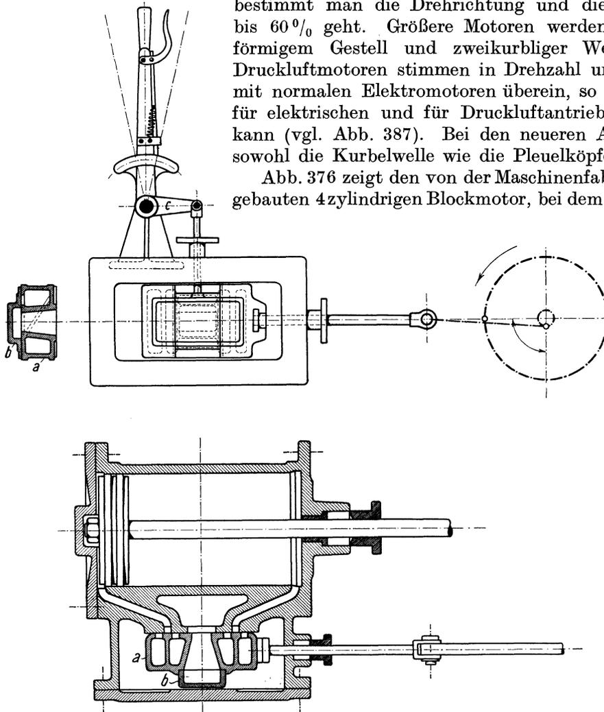
Abb. 372. Wechselschiebersteuerung von Eickhoff.
