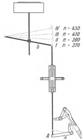
Abb. 101. Regelung mit veränderlicher Drehzahl.
