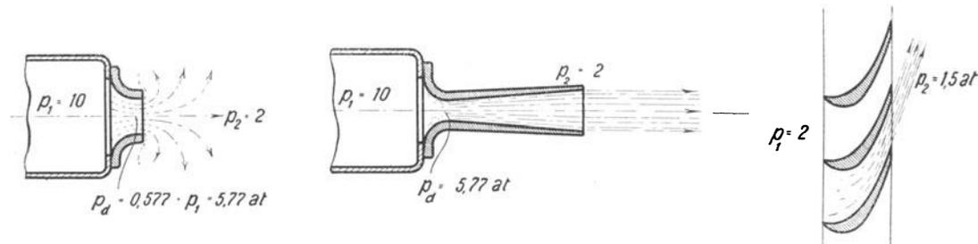
Abb. 166. Ausströmung von Dampf.
