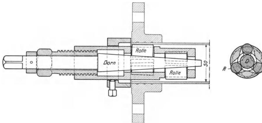
Abb. 62. Einwalzen eines Rohrflansches.
