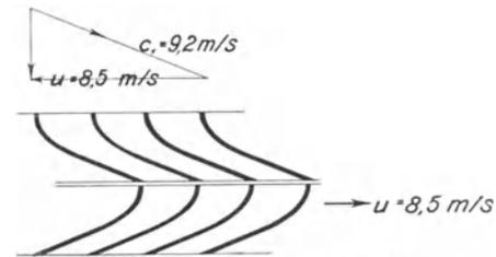
Abb. 164. Überdruckschaufelung.
