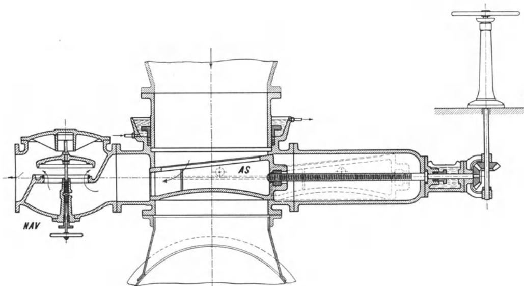
Abb. 144. Wasserstopfbüchse, Abdampfschieber und Notauspuff.
