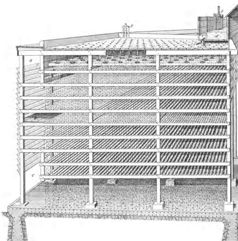
Abb. 158. Querstromteil des Querstromgegenstromkühlers.
