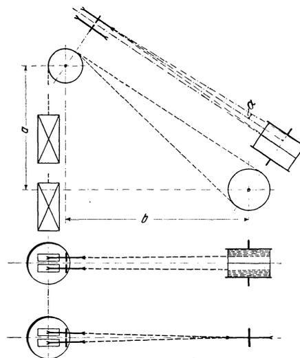
Abb. 213. Fördermaschine liegt in der Durchschubrichtung der Förderwagen.
