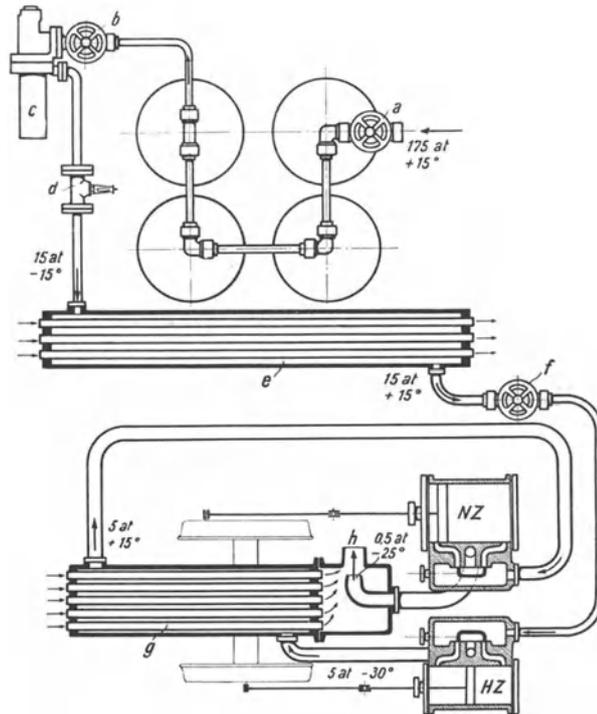
Abb. 418. Druckluftlokomotive mit zweistufiger Expansion (Borsig).
