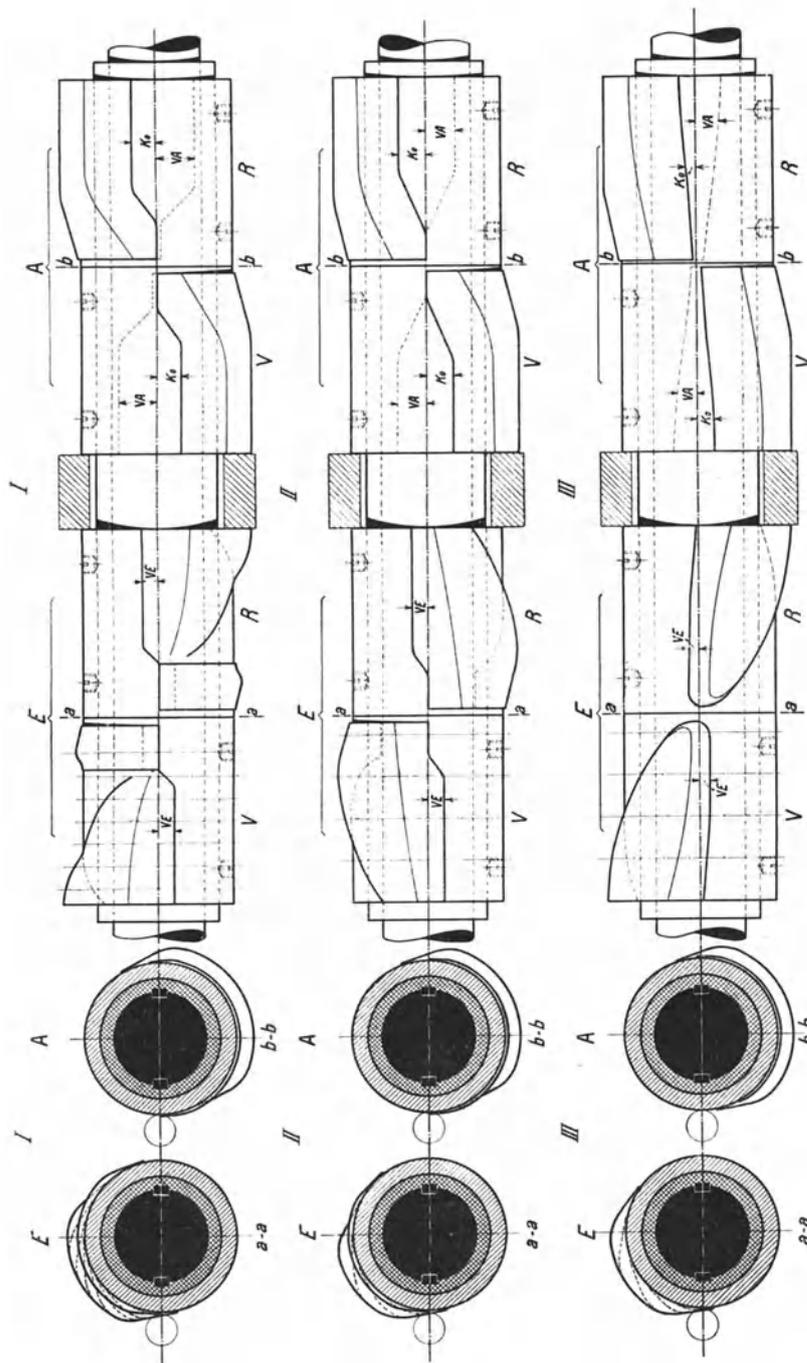
Abb. 246. I: Knaggen mit getrennten Fahrt- und Manövriernaggen. II: Knaggen umgekehrter Form. III: Alte Knaggenform.
