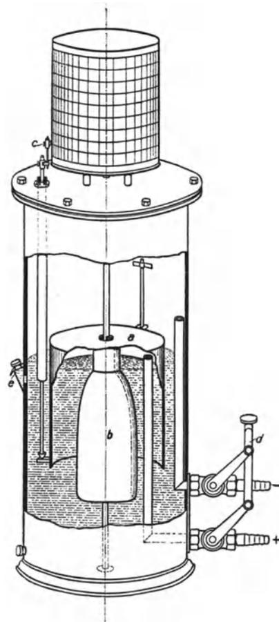
Abb. 494. Differenzdruckmesser mit Tauchglocke und parabolischem Schwimmer (Hydro).
