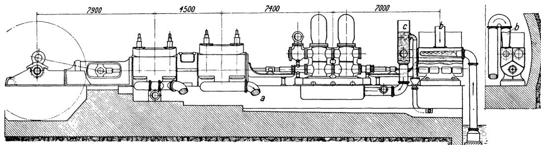
Abb. 303. Wasserhaltung für 25 m<sup>3</sup>/min aus 500 m Teufe.
