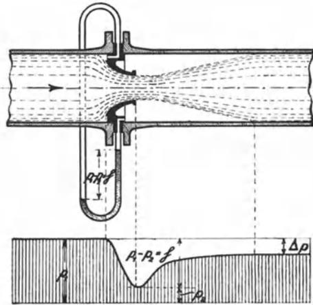
Abb. 511. Messung mittels Düse.
