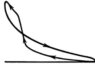
Abb. 436. Diagramm einer Gasmaschine, deren Gemisch infolge Selbstzündung weit vor dem Hubwechsel verbrennt.
