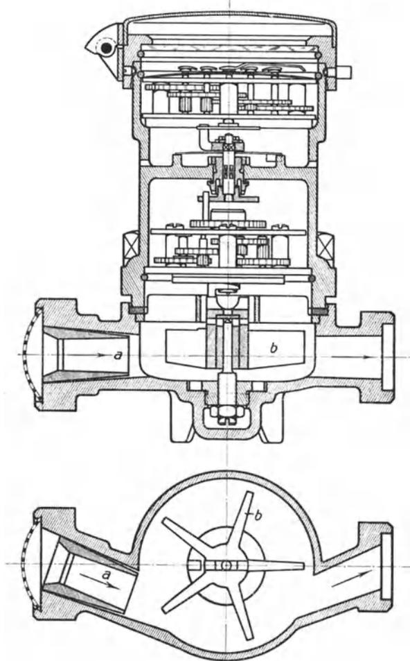
Abb. 501. Einstrahlwassermesser von Dreyer, Rosenkranz & Droop, Hannover.
