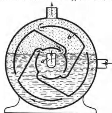
Abb. 504. Schema der nassen Gasuhr.
