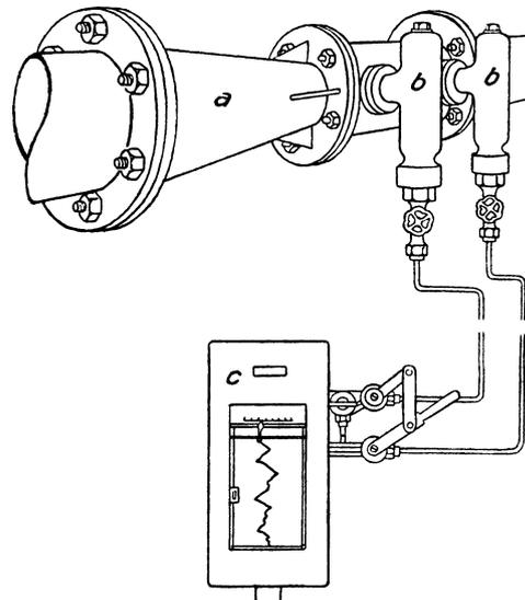
Abb. 515. Registrierender Venturi-Dampfmesser von Siemens & Halske, A.-G.
