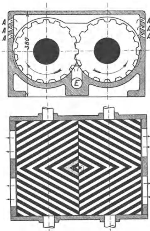
Abb. 381. Schema eines Pfeilradmotors.
