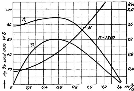
Abb. 426. Kennlinien eines Ventilators bei konstanter Drehzahl.
