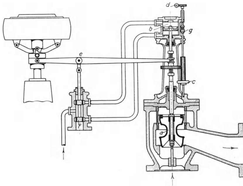
Abb. 177. Drosselregelung der Zoellyturbine.
