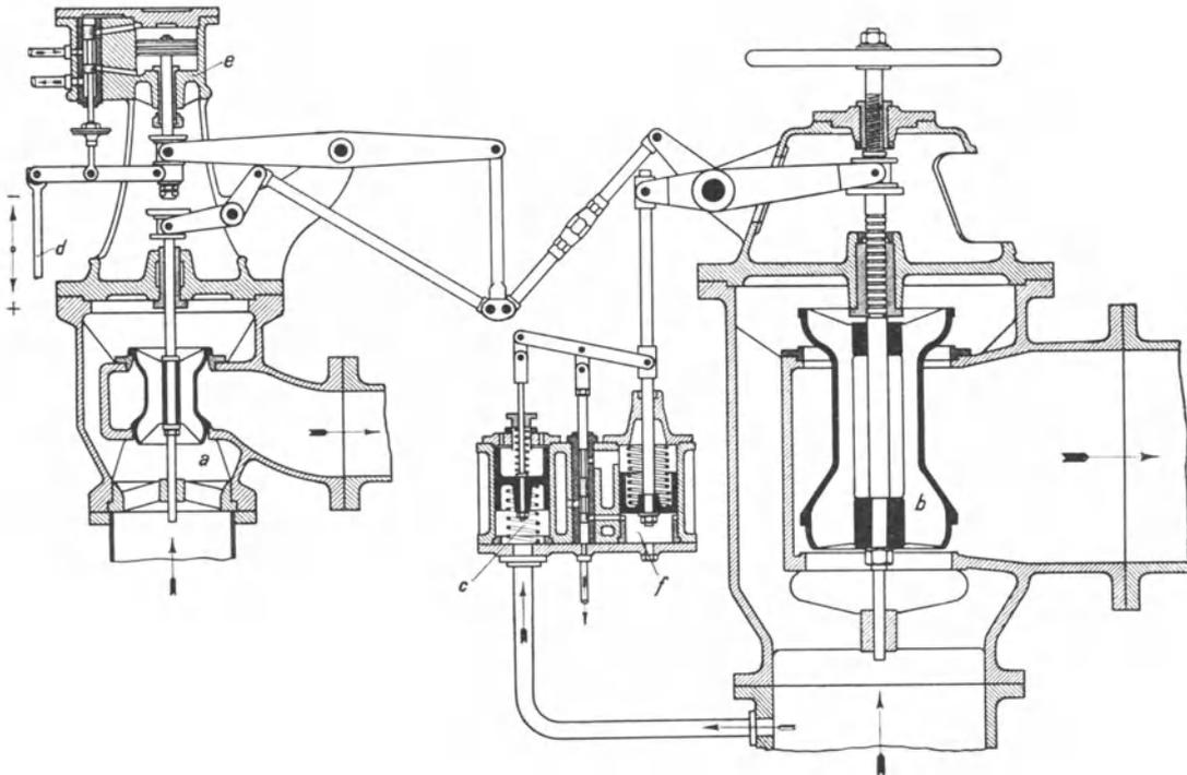
Abb. 194. Zweidrucksteuerung von Rateau (MAN).
