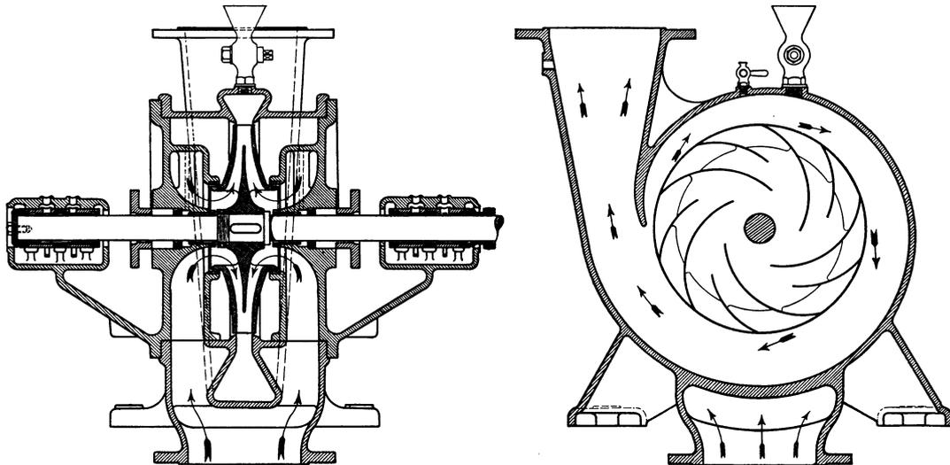
Abb. 315. Niederdruckkreiselpumpe (Jaeger).
