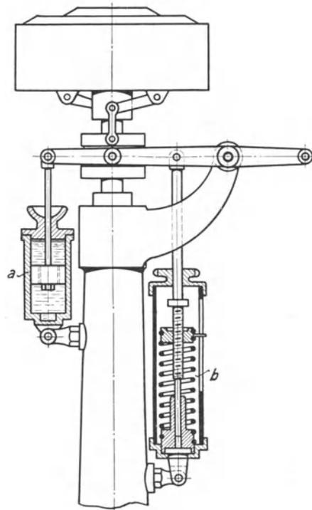
Abb. 100. Regler mit Federwaage und Ölkatarakt.
