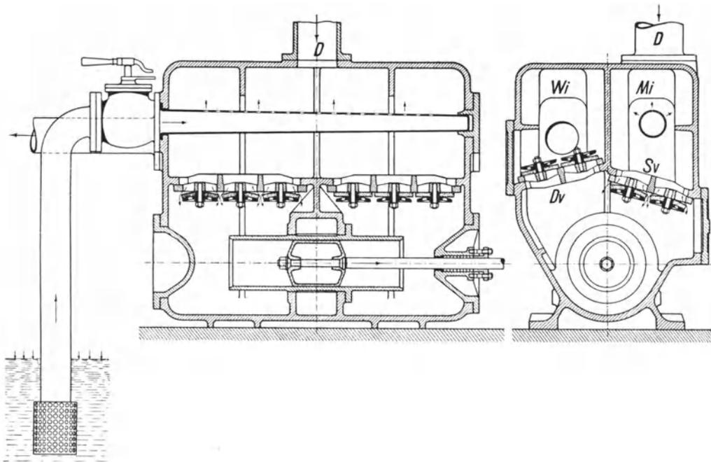
Abb. 135. Mischkondensation mit nasser Luftpumpe.
