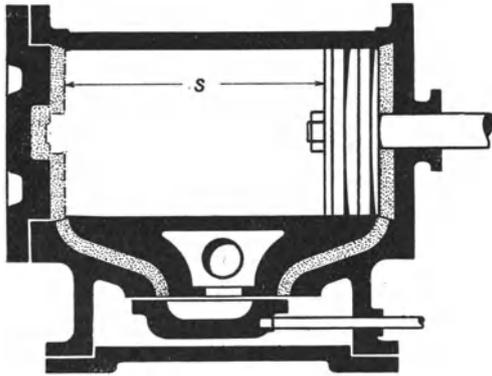
Abb. 84. Schädlicher Raum eines Dampfzylinders.
