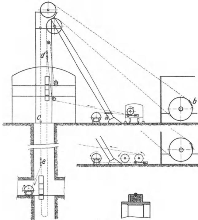
Abb. 237. Seilauflegen bei Treibscheiben mit schmalen Kranz.
