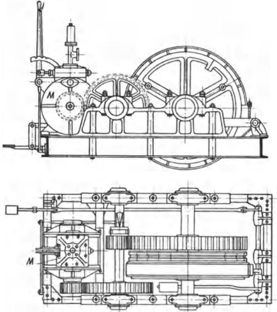
Abb. 388. Haspel mit Drahtkolbenmotor (Axmann).
