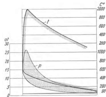
Abb. 3. Temperaturverlauf in einem Gasmaschinenzylinder.
