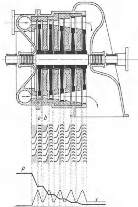
Abb. 171. 5stufige Gleichdruckturbine.
