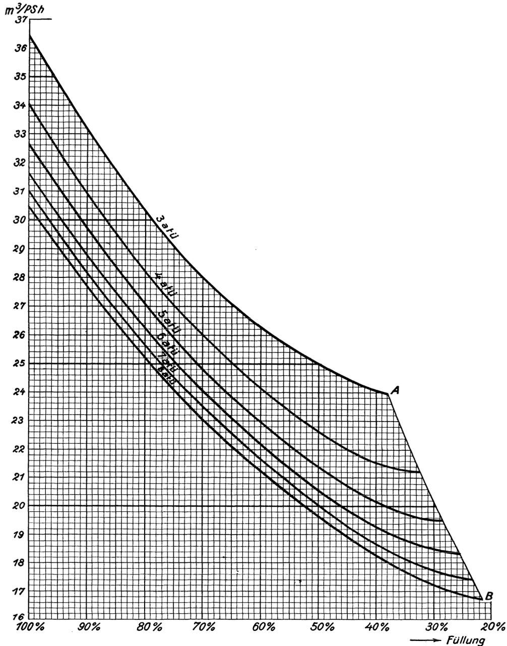
Abb. 365. Stündlicher theoretischer Druckluftverbrauch für 1 PS, gemessen in  $m^3$  angesaugter Luft von 1 at, bei adiabatischer Expansion und 1,033 at Gegendruck.
