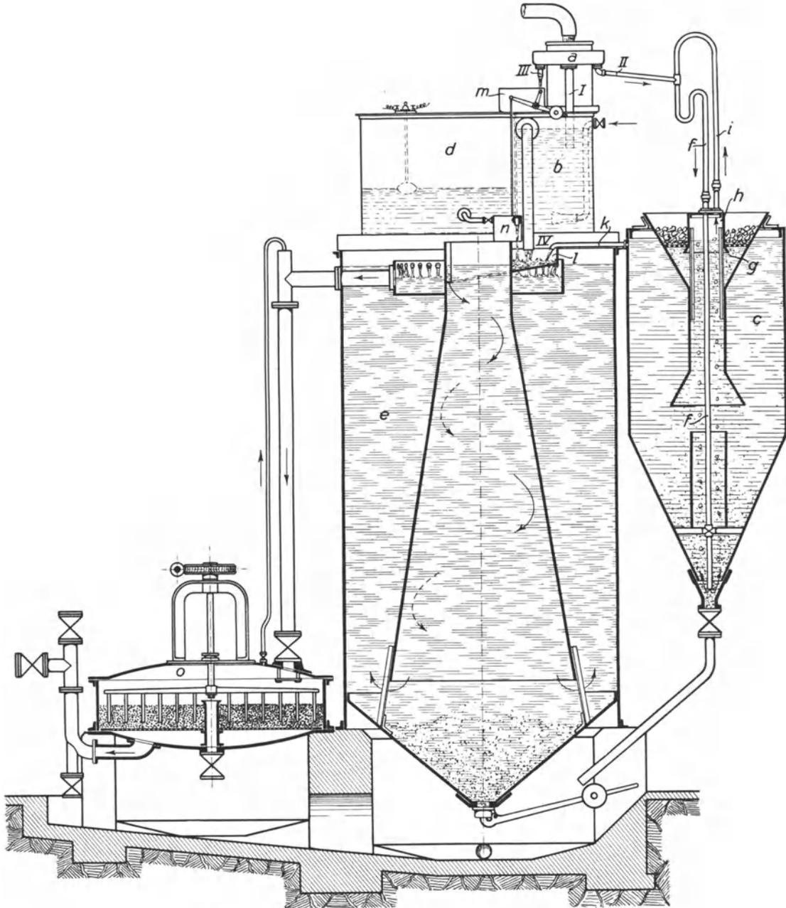
Abb. 70. Wasserreiniger von L. & C. Steinmüller.
