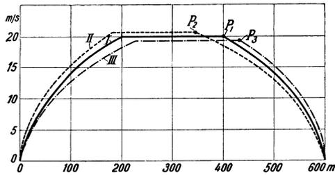
Abb. 228. Geschwindigkeitsdiagramm auf Wegbasis.
