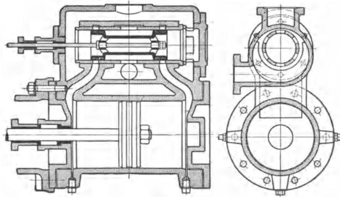
Abb. 115. Kolbenschiebersteuerung.
