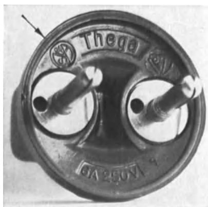
Abb. 188 und 189. Überwachungszeichen in Fertigstücken aus typisierten und überwachten Preßstoffen.
