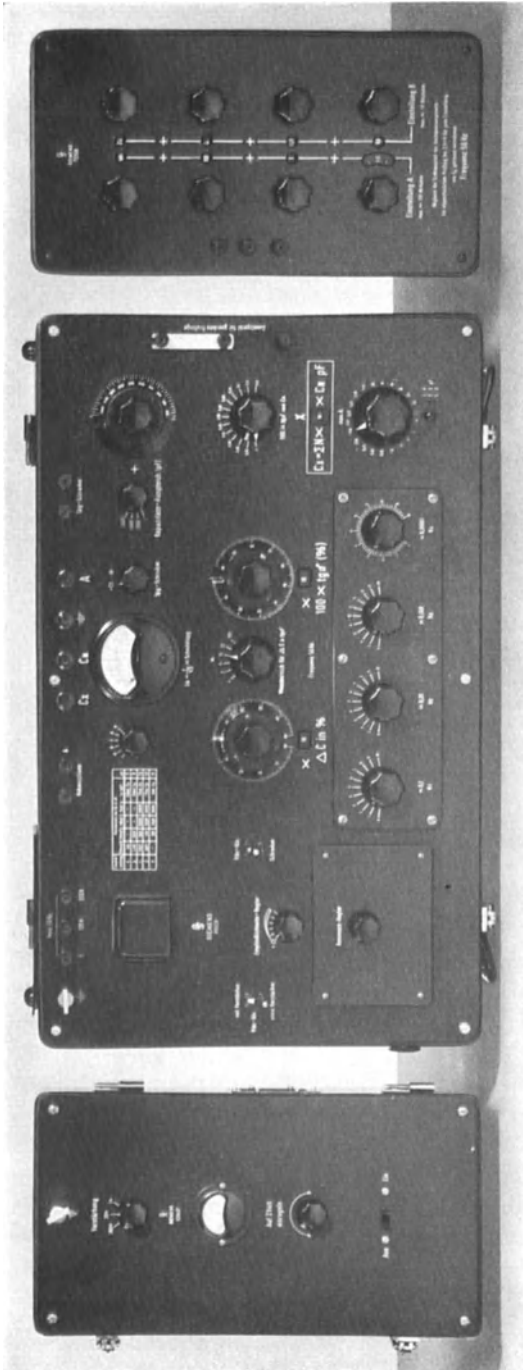
Abb. 91 a. Registrierende Verlustfaktormeinrichtung.
