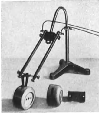
Abb. 32. Spannungszuführung an aufgeriebene Graphitelektroden.
