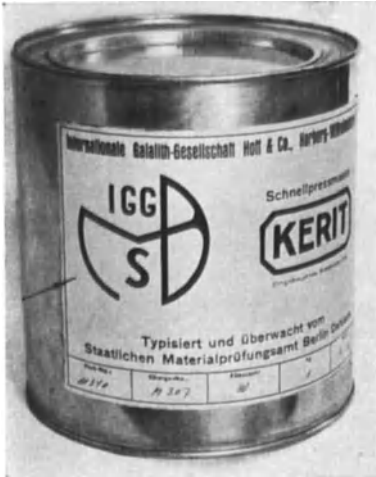
Abb. 190. Überwachungszeichen auf der Verpackung typisierter und überwachter Kunstharz-Preßmassen.
