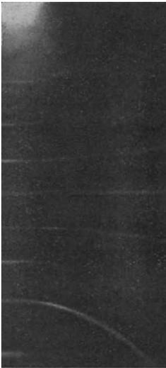
Abb. 23. Debye-Scherreraufnahme eines gezogenen Wolframdrahtes.
