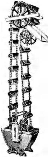
Abb. 42. Senkrecht stehender, langsam laufender Elevator mit eingezogenem Becherstrang.
