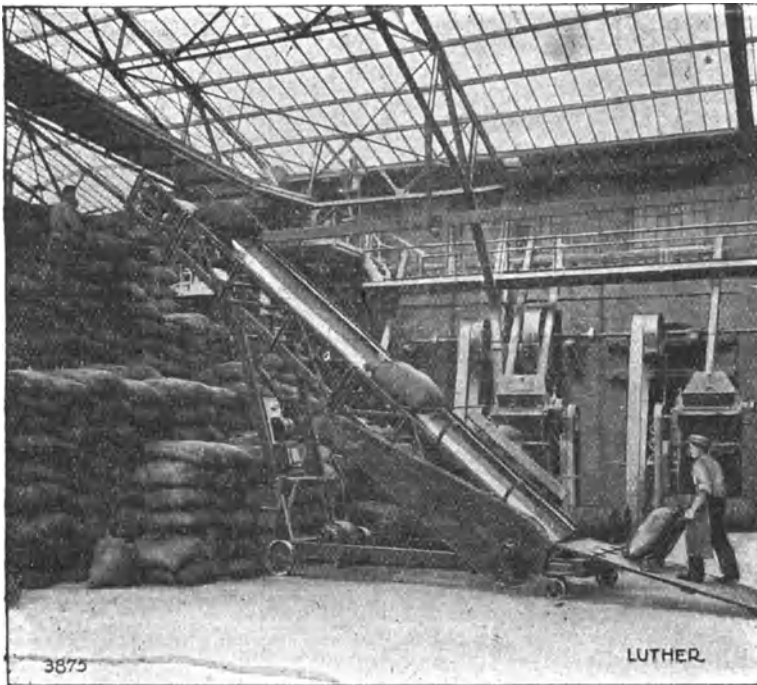
Abb. 58. Sackelevator von G. Luther A.-G., Braunschweig.
