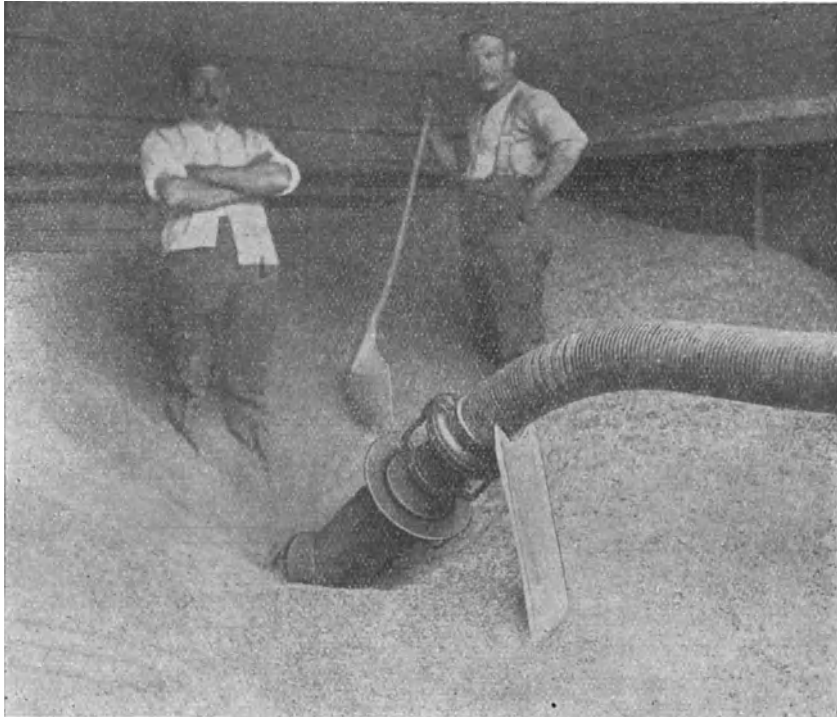
Abb. 50. Saugdüse von Anme, Giesecke & Koenigen, Braunschweig, beim Fördern von Getreide aus dem Schiffsraum.
