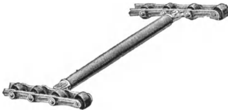
Abb. 33. Mitnehmerstange eines Schleppers mit weit auseinanderliegenden Ketten.
