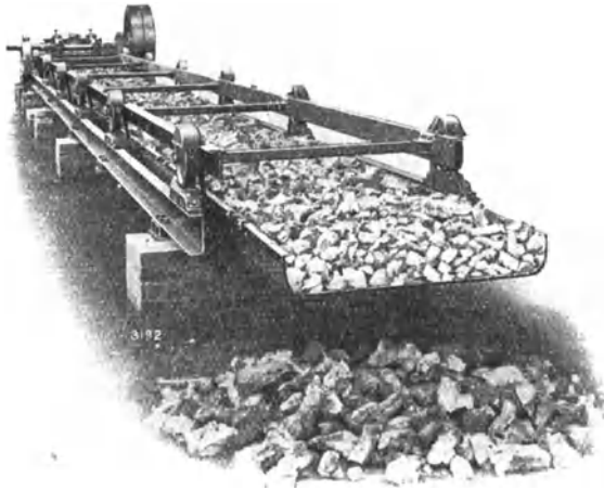
Abb. 35. „Torpedorinne“ von Amme, Giesecke & Konegen.
