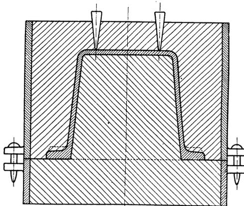
Fig. 51. Form eines kleinen Maschinengestells ohne besonderen Kern.
