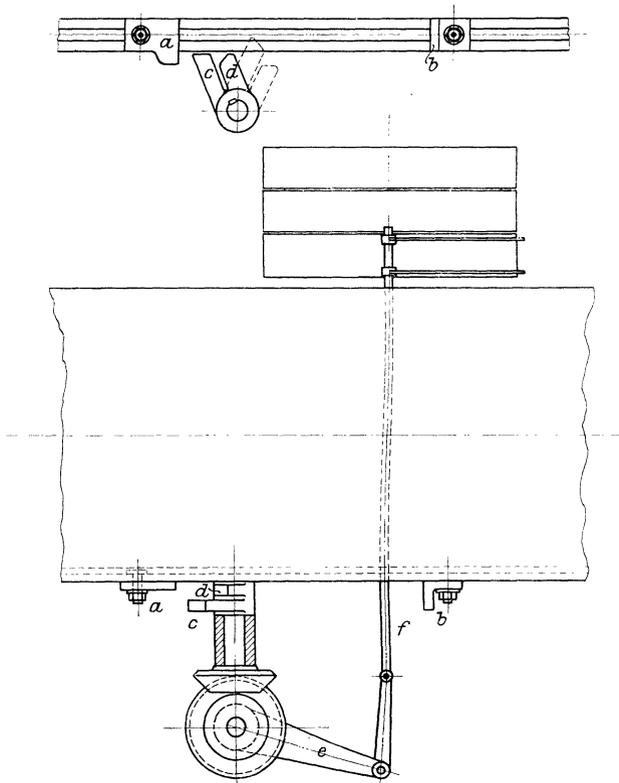
Fig. 272. Umsteuerung einer Hobelmaschine durch Stoßknaggen und Stoßhebel.
