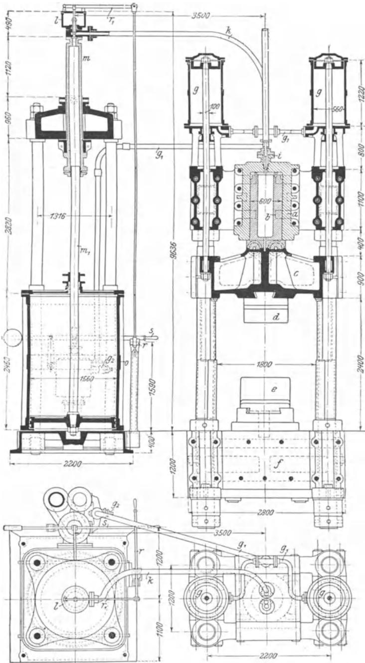
Fig. 129. Dampfhydraulische Schmiedepresse von Breuer, Schumacher & Co. A.-G. in Kalk bei Köln.
