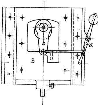
Fig. 288. Ausrückbare Druckstelze.
