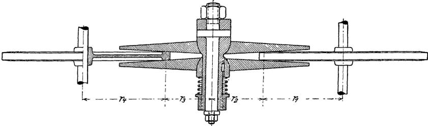
Fig. 243. Reibungsrädergetriebe.
