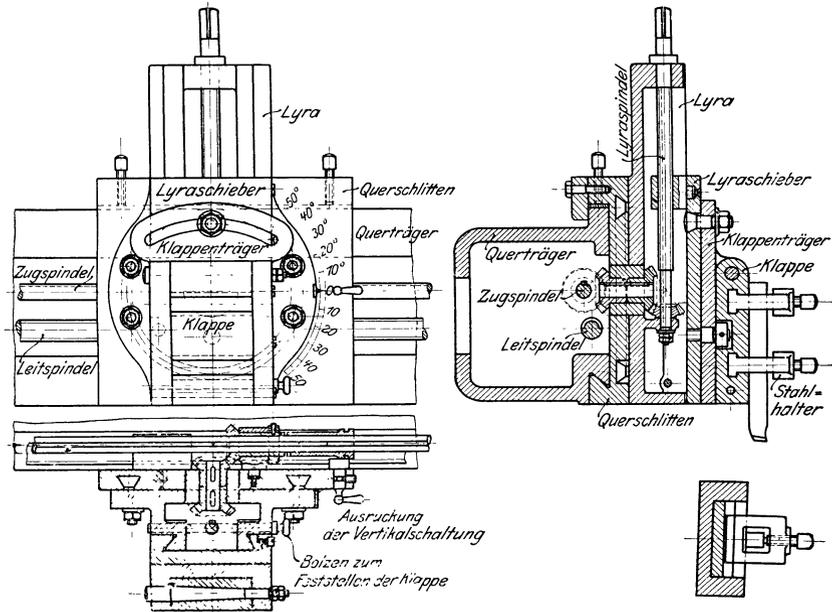
Fig. 375. Hobelmaschinen-Support.
