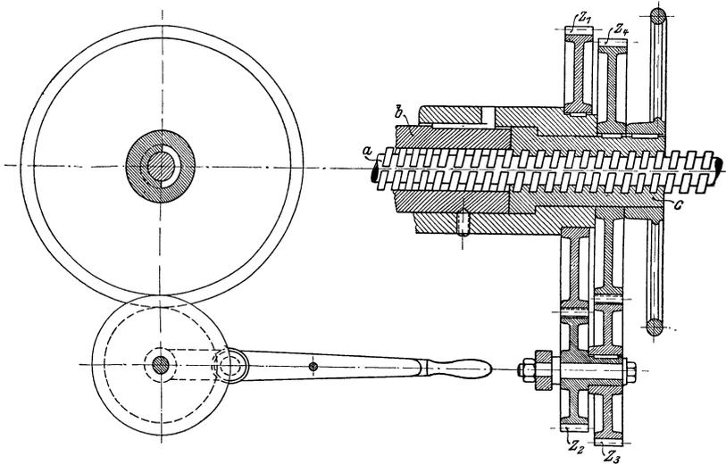
Fig. 252. Differentialrädergetriebe einer Wagerechthoerbohrmaschine.
