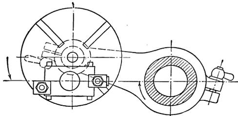
Fig. 327. Einstellung eines amerikanischen Bohrtisches (nach Ruppert).
