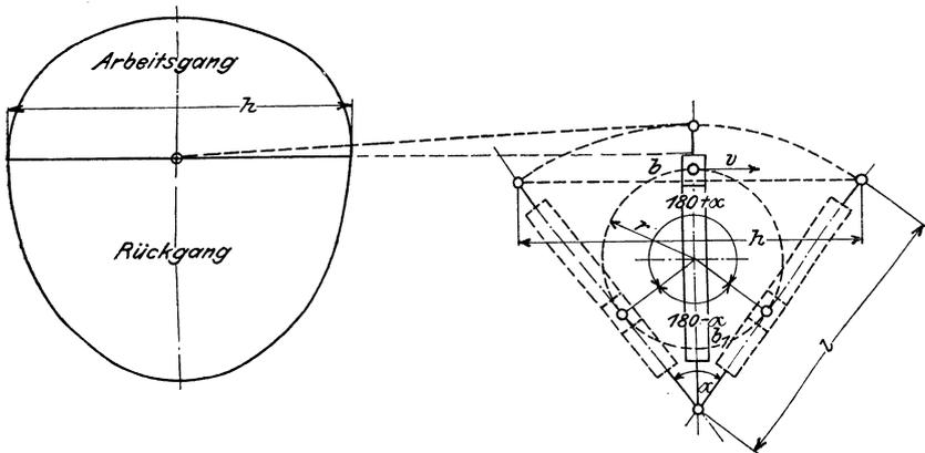
Fig. 227. Schema einer schwingenden Kurbelschleife.
