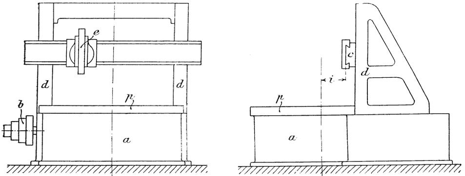
Fig. 316. Plandrehbank mit wagerechter Planscheibe
