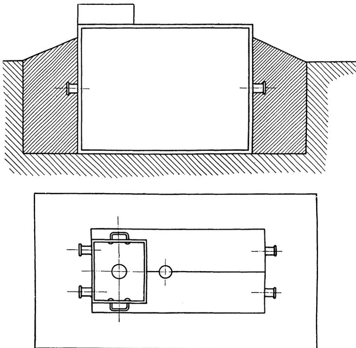
Fig. 55. Zum Gießen eingestampfte Dampfzylinderform.
