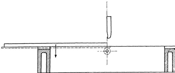
Fig. 220. Hobelmaschinenantrieb durch Zahnstange und Rad.
