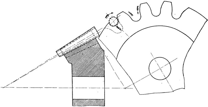
Fig. 360. Das Kegelräderfräsen.
