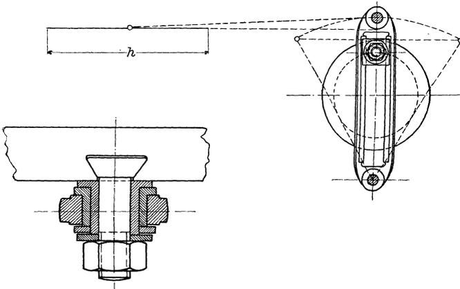
Fig. 225. Schwingende Kurbelschleife.
