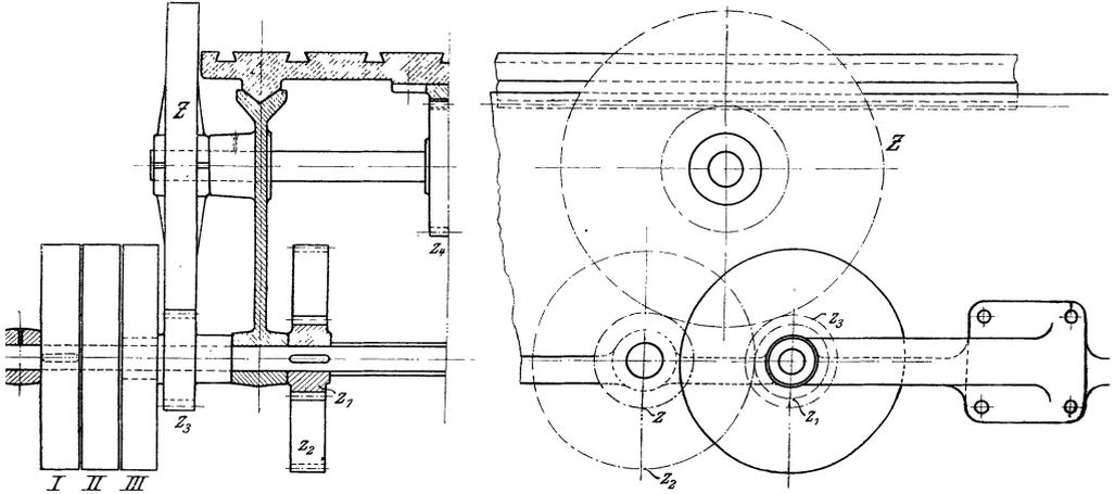
Fig. 269. Dreischeiben-Wendegetriebe mit einfacher und doppelter Stirnräderübersetzung.
