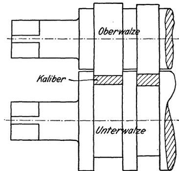
Fig. 135. Geschlossene Kaliber.
