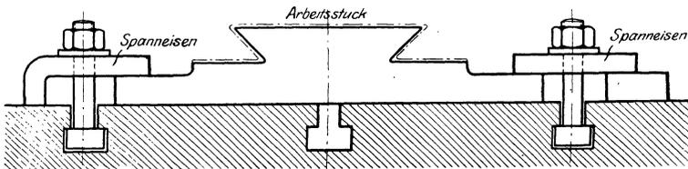
Fig. 194. Befestigung mit Spanneisen.
