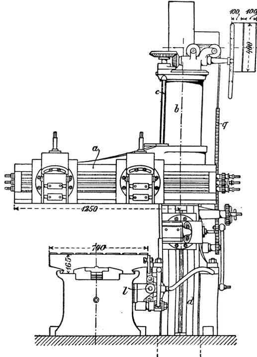
Fig. 374. Einständer- oder Einpilaster-Hobelmaschine (nach Fischer).
