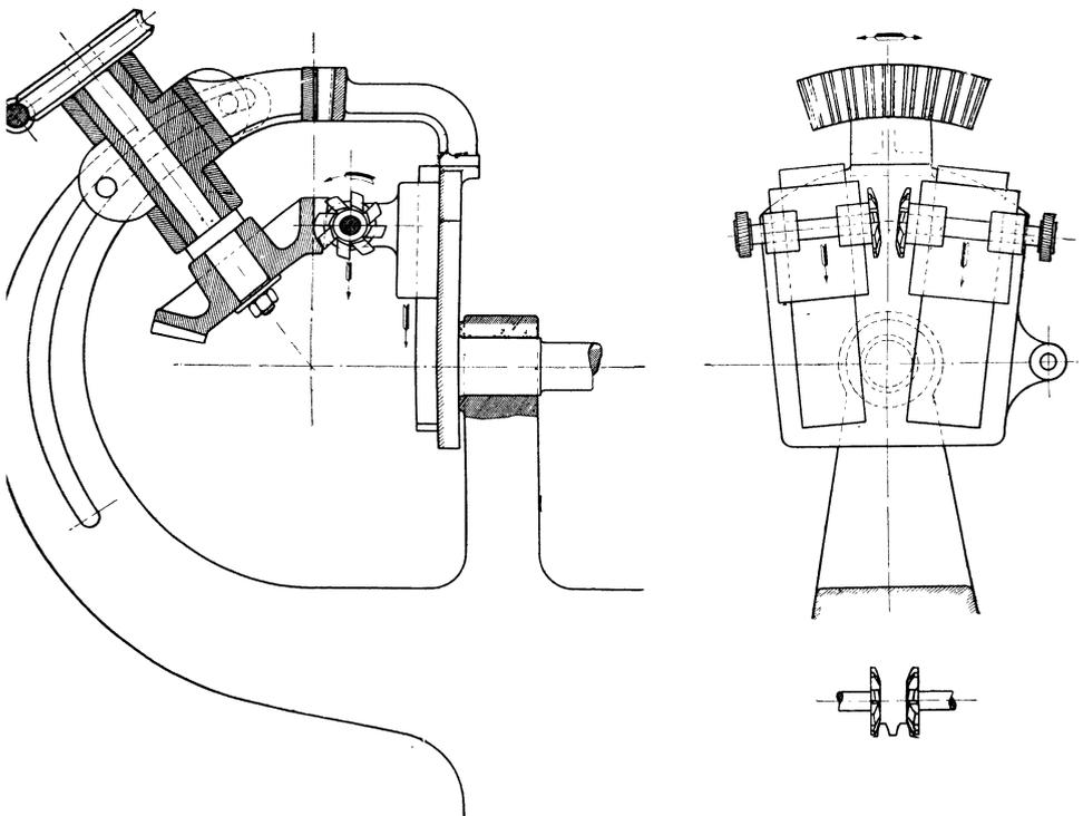
Fig. 361. Das Kegelräderfräsen nach Patent Warren.
