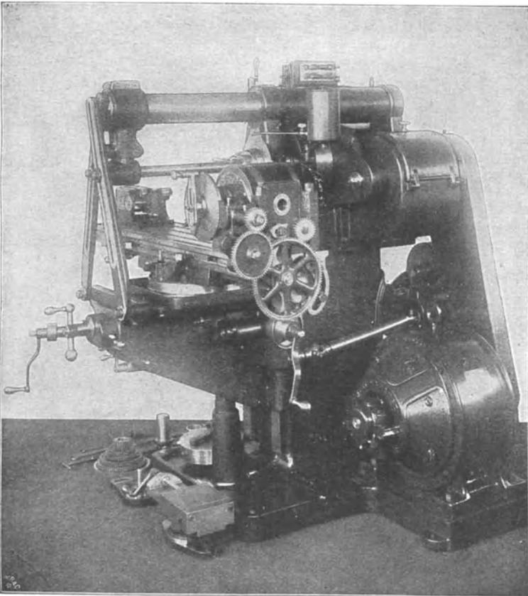
Fig. 354. Universal-Fräsmaschine mit elektrischem Antriebe (nach Möller).
