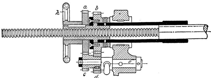
Fig. 336. Alte Bohrspindelnachstellung (nach Ruppert).
