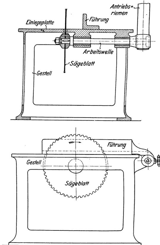
Fig. 395. Kreissäge.
