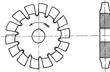
Fig. 172. Zahnradfräser (Profilfräser).
