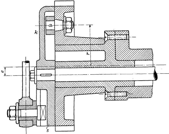
Fig. 229. Ausführung einer umlaufenden Kurbelschleife.
