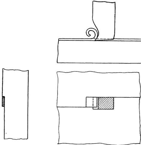
Fig. 155. Spiralförmiger Span.
