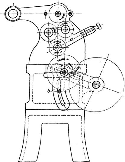
Fig. 302. Umsteuerung und Wechselräder einer Drehbank.
