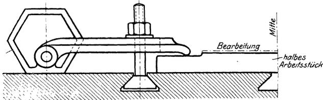
Fig. 195. Verstellbares Spanneisen.
