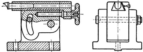
Fig. 353. Reitstock der Universal-Fräsmaschine (nach Fischer).
