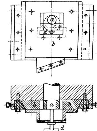
Fig. 289. Ausziehbare Schieber.
