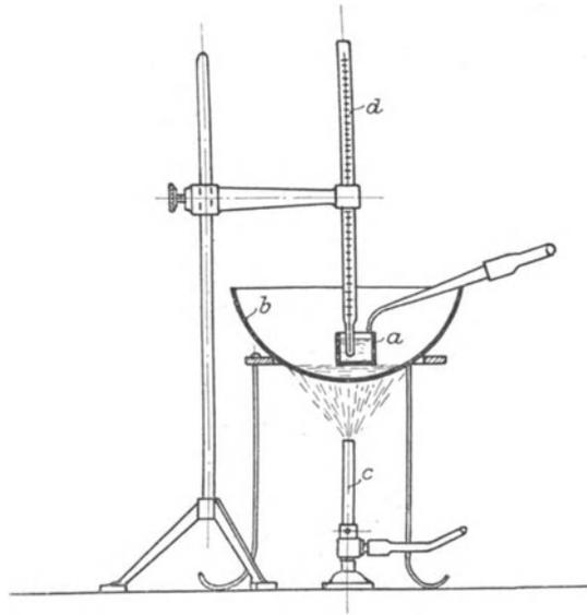
Fig. 15. Entflammungspunktmesser.
