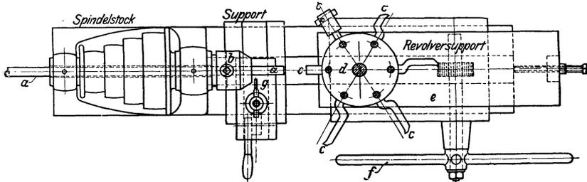
Fig. 319. Revolver-Drehbank.
