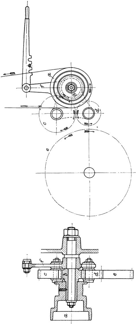
Fig. 275. Stirnräder-Wendegetriebe mit zwei Zwischenrädern.
