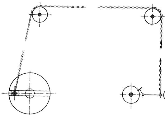
Fig. 237. Kurbelscheibe und Kette (Faulenzer).
