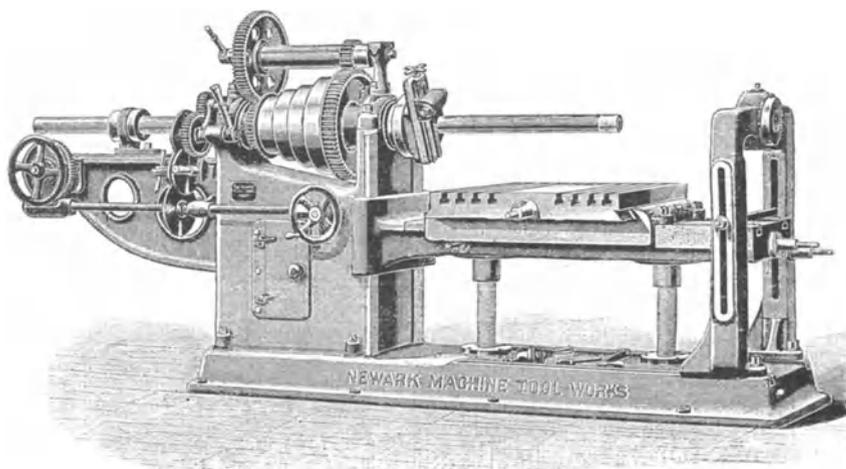
Fig. 338. Neue Wagerecht-Bohrmaschine für kleine Arbeitsstücke (nach Fischer).
