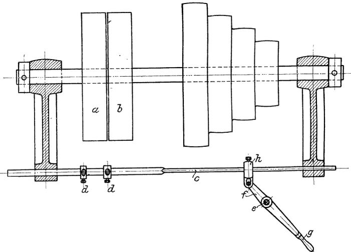
Fig. 282. Deckenvorgelege mit drehbarer Ausrückstange.
