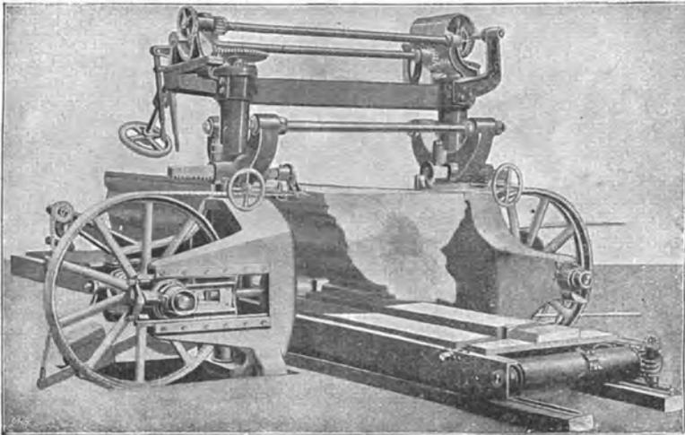
Fig. 397. Blockbandsäge von Kirchner (nach Fischer).
