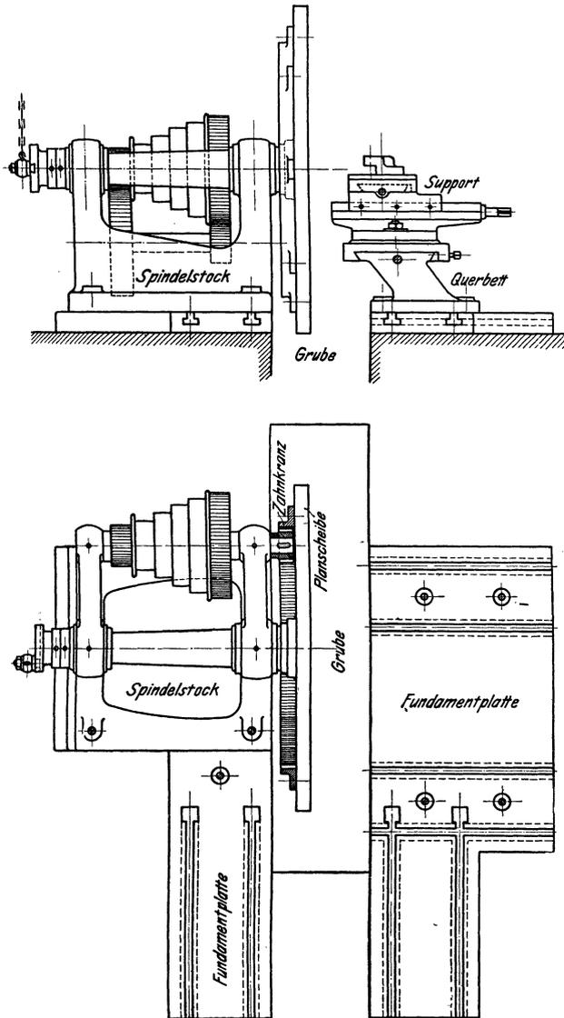
Fig. 315. Plandrehbank mit senkrechter Planscheibe.
