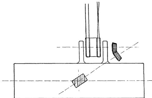
Fig. 268. Hobelmaschine mit Schneckenantrieb. Tischbewegung parallel zur Transmission.
