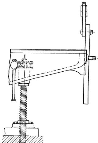
Fig. 339. Bohrstangenlager (nach Ruppert).
