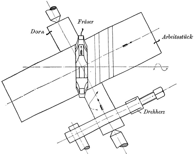
Fig. 357. Das Schraubenräderfräsen.
