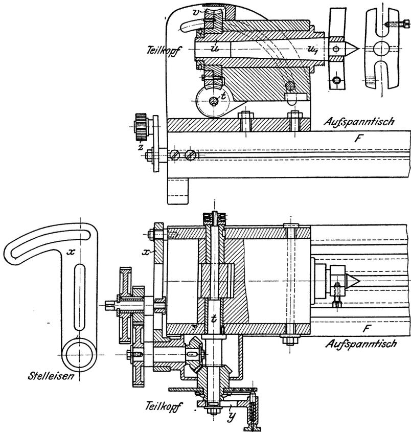
Fig. 352. Teilkopf der Universal-Fräsmaschine (nach Fischer).
