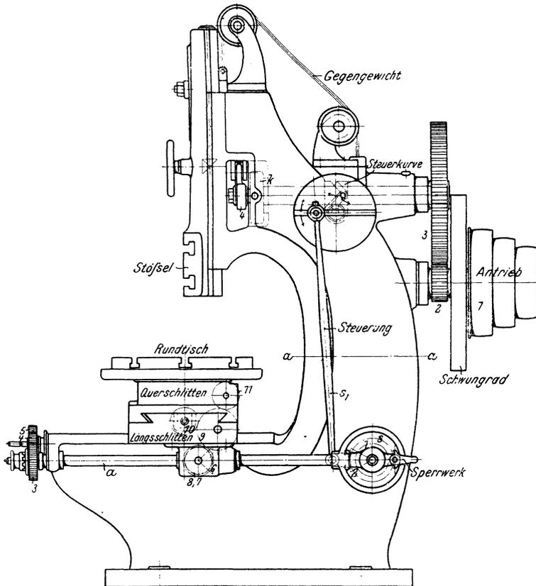
Fig. 386. Stoßmaschine von Lorenz, Ettlingen (nach Hülle).
