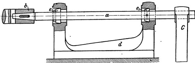
Fig. 168. Bohrstange.
