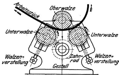
Fig. 141. Blechbiegemaschine (Querschnitt).
