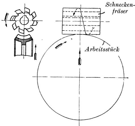
Fig. 358. Das Schneckenräderfräsen.
