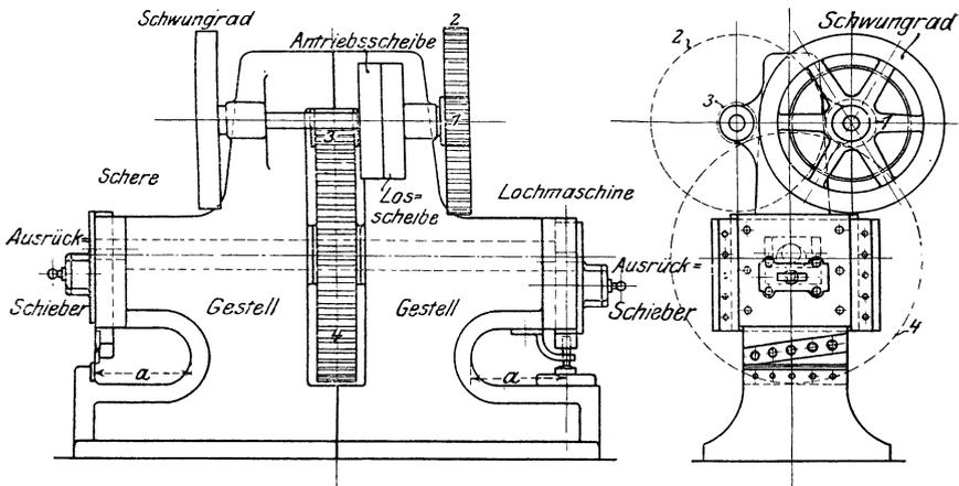
Fig. 391. Schere und Lochmaschine.
