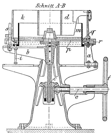
Fig. 63. Durchziehmaschine der Badischen Maschinenfabrik in Durlach (nach Fischer).
