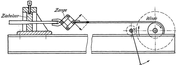
Fig. 144. Schleppzangenziehbank.
