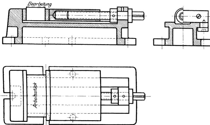
Fig. 197. Maschinenschraubstock.
