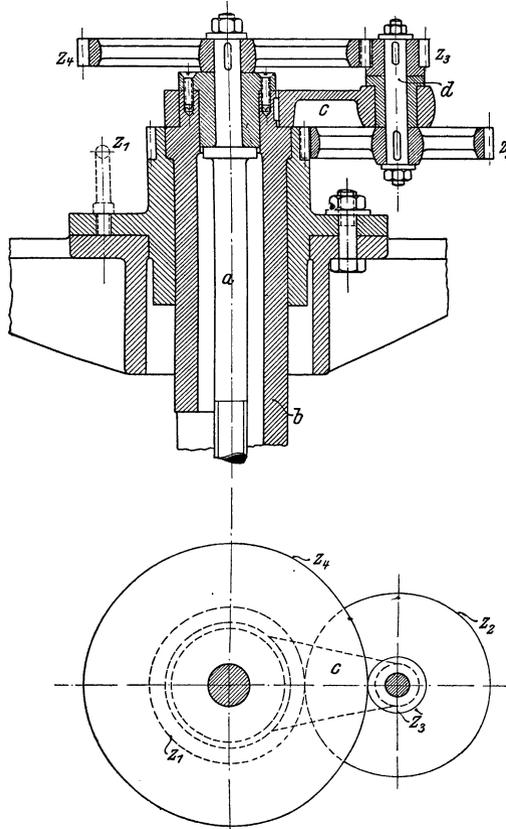
Fig. 254. Umlaufräderwerk einer Zylinderbohrmaschine.
