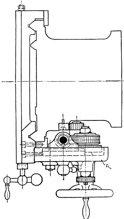
Fig. 308. Schild der Norton - Drehbank (nach Ruppert).
