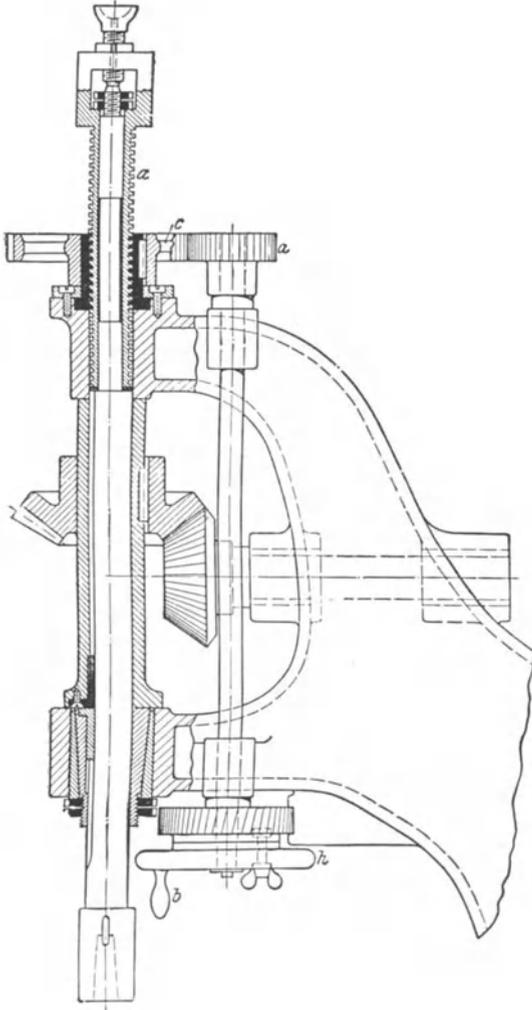
Fig. 323. Alte deutsche Bohrmaschinenspindel mit Antrieb und Schaltung (nach Ruppert).
