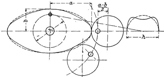
Fig. 233. Schema eines Kurbelmechanismus mit stark exzentrischem und elliptischem Rade.
