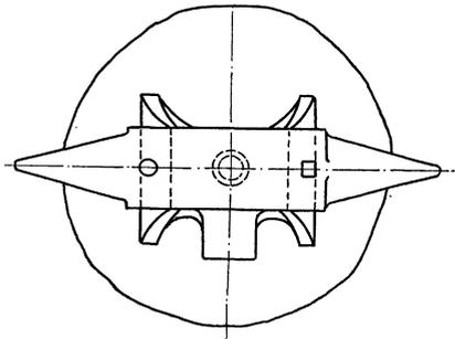
und Vor- oder Zuschlaghammer. Erstere haben ein Gewicht bis zu 2 kg und einen Stiel von 35—40 cm Länge. Sie werden vom Schmiede, dem Vorarbeiter, mit einer Hand geführt, während er mit der anderen das Arbeitsstück festhält. Zuschlaghämmer wiegen bis zu 10 kg, haben einen Stiel bis etwa 1 m Länge und werden mit beiden Händen
