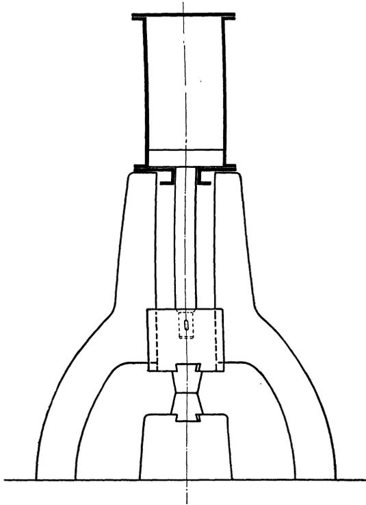
Fig. 124. Doppeltwirkender Dampfhammer mit frischem Unter- und Oberdampf.
