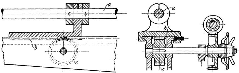
Fig. 256. Verbesserter Schaltmechanismus einer Wagerechtbohrmaschine.
