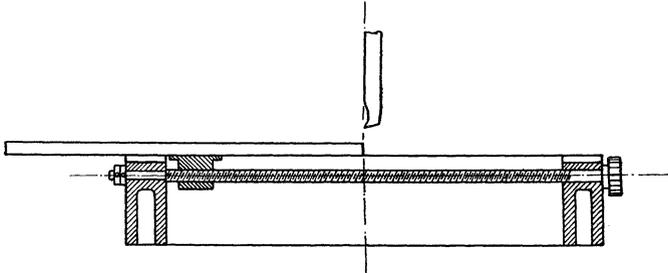
Fig. 221. Hobelmaschinenantrieb durch Schraubenspindel und Mutter.
