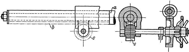
Fig. 255. Schaltmechanismus einer Wagerechtbohrmaschine.
