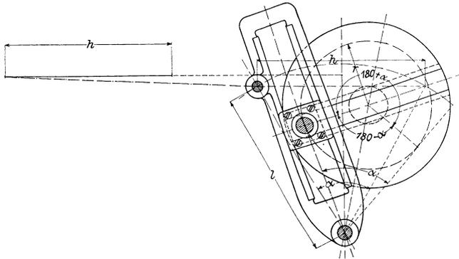
Fig. 226. Schwingende Kurbelschleife.
