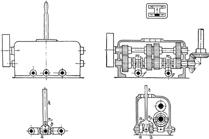
Fig. 334. Bickford-Stufenrädergetriebe (nach Ruppert).
