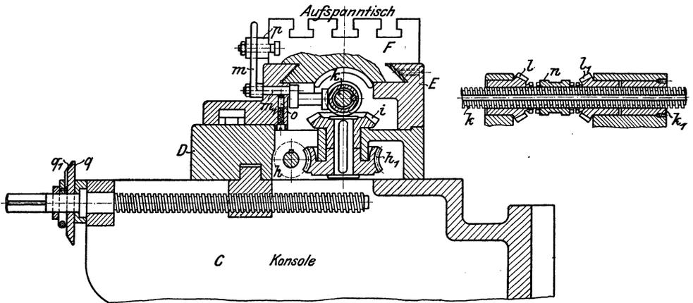
Fig. 351. Tischantrieb der Universal-Fräsmaschine (nach Fischer).
