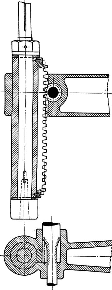
Fig. 248. Schaltmechanismus einer modernen Bohrmaschine.
