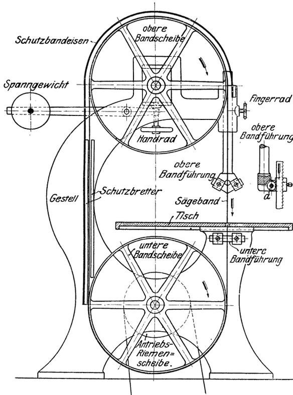
Fig. 396. Bandsäge.
