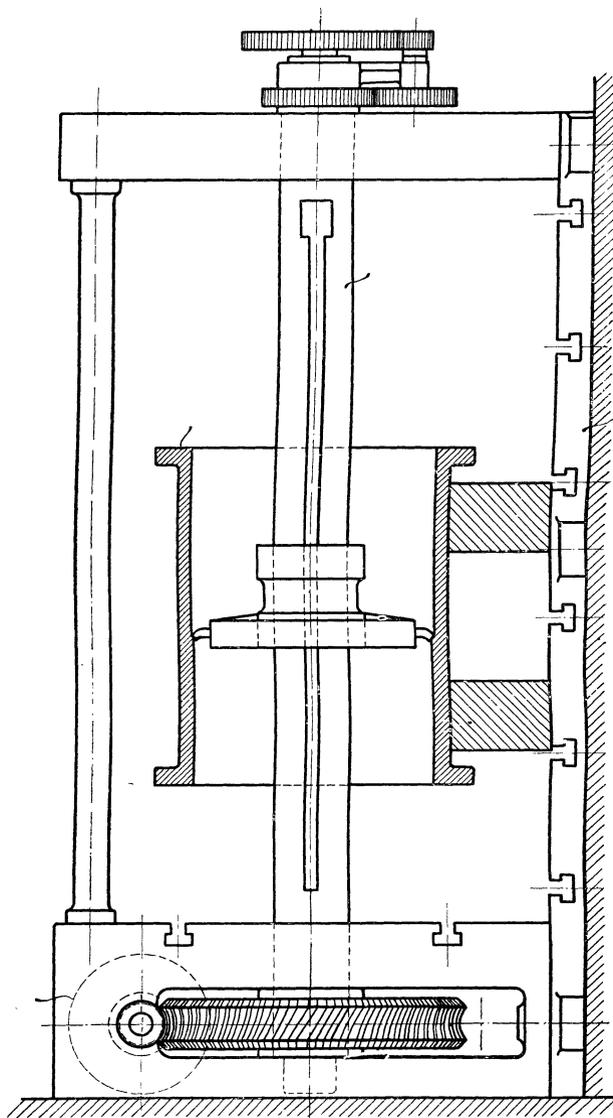
Fig. 345. Senkrechte Zylinder-Bohrmaschine.
