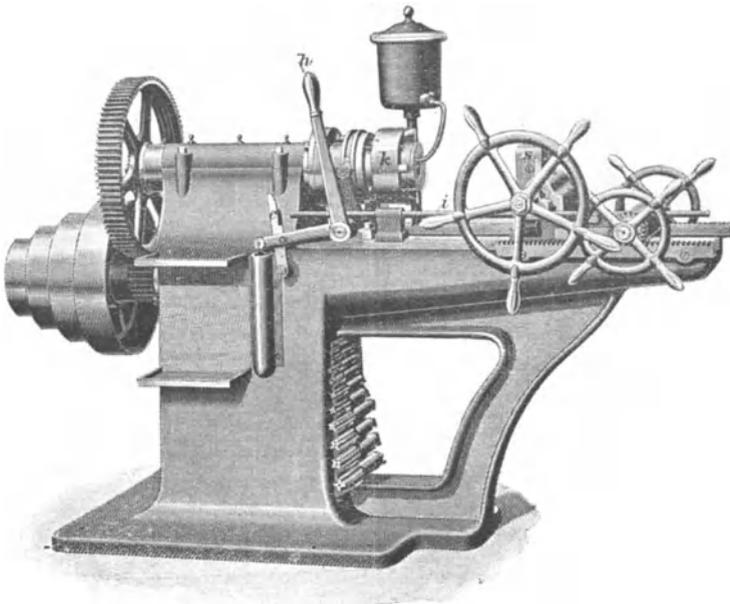
Fig. 370. Schrauben-Schneidmaschine (nach Fischer).
