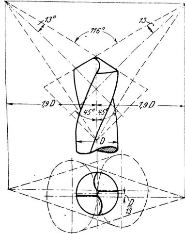
Fig. 364. Spiralbohrer-schleifflächen.
