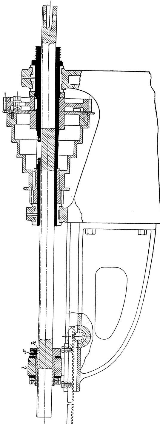
Fig. 337. Neue Bohrspindelnachstellung (nach Ruppert).
