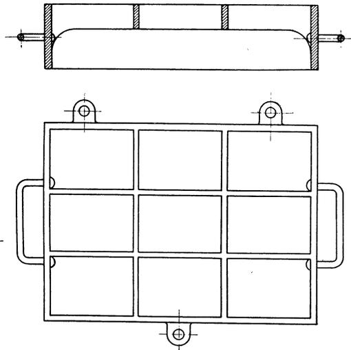
Fig. 34. Mittlerer Formkasten.
