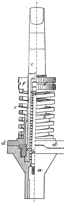
Fig. 191. Patent-Gewindeschneidvorrichtung (nach Fischer).
