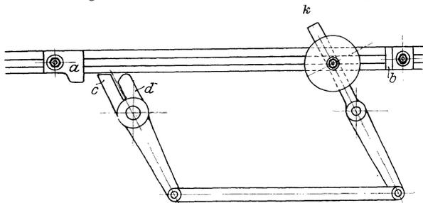
Fig. 273. Stoßhebel mit Kipphebel und Schwunggewicht.
