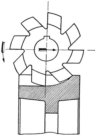
Fig. 356. Das Stirnräderfräsen mit dem Scheibenfräser.
