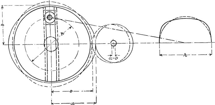
Fig. 232. Schema eines Kurbelmechanismus mit exzentrischem und elliptischem Rade.
