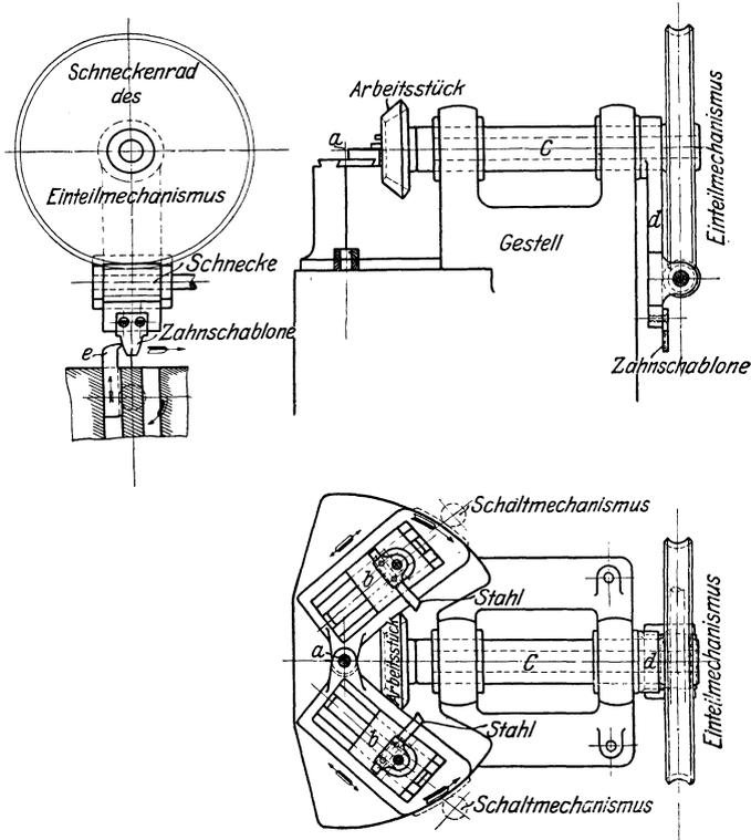
Fig. 385. Das Kegelräderhobeln.
