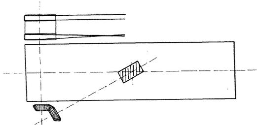
Fig. 267. Hobelmaschine mit Schneckenantrieb. Tischbewegung senkrecht zur Transmission.
