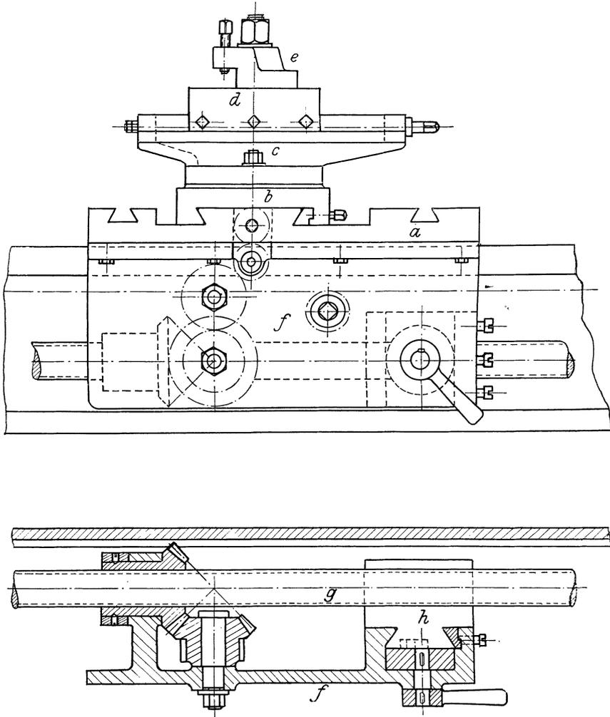
Fig. 304. Deutscher Drehbank-Support.
