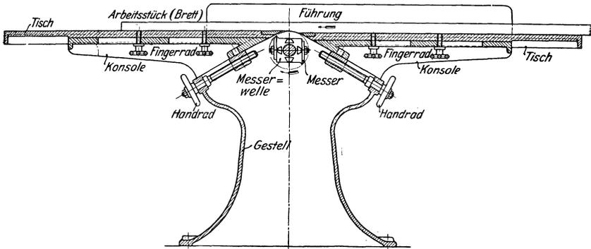
Fig. 407. Abrichthobelmaschine.
