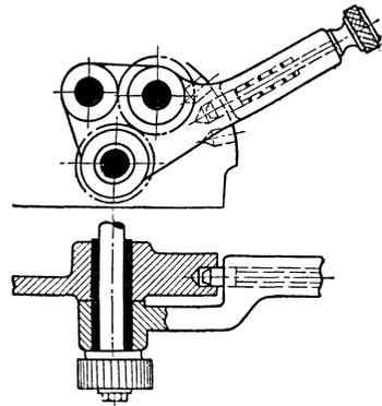
Fig. 276. Stirnräder-Wendegetriebe mit zwei Zwischenrädern (Herzsteuerung) (nach Ruppert).
