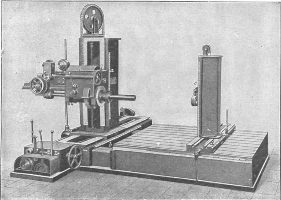
Fig. 340. Neuzzeitliche Wagerecht-Bohrmaschine für große Arbeitsstücke (nach Ruppert).
