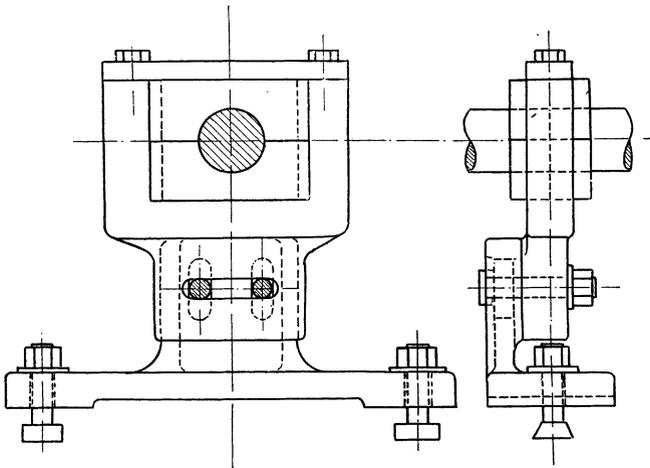
Fig. 311. Deutscher Support-Setzstock.
