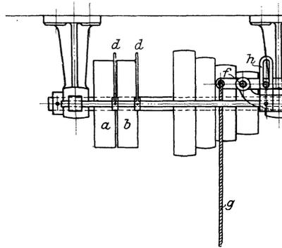
Fig. 284. Deckenvorgelege mit Kipphebel und Zugseil.
