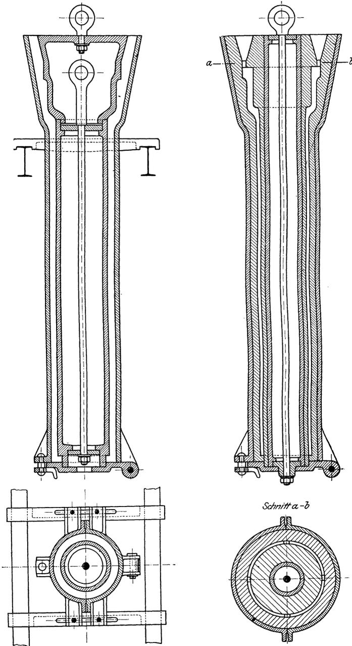
Fig. 71. Rohrformkasten und -modell für stehenden Guß.
