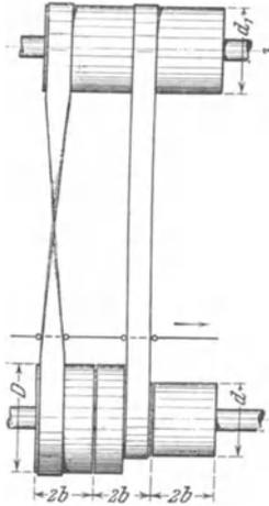
Fig. 264. Riemenscheiben-Wendegetriebe mit schnellem Rückgange.
