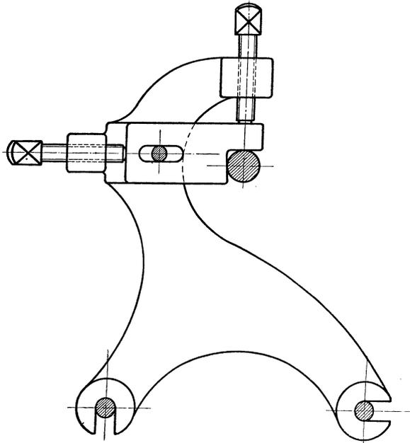
Fig. 312. Amerikanischer Support-Setzstock.
