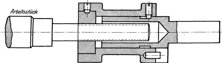
Fig. 190. Selbstauslösender Schneideisenhalter.
