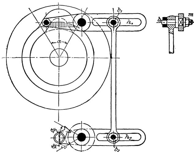
Fig. 240. Nutenscheibe und Hebel (nach Ruppert).
