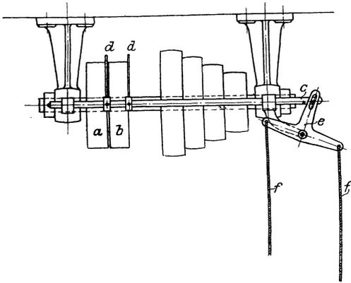
Fig. 283. Deckenvorgelege mit Kreuzhebel und Zugseilen.
