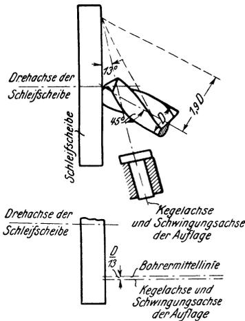
Fig. 365. Schleifen nach dem Washburne-College.
