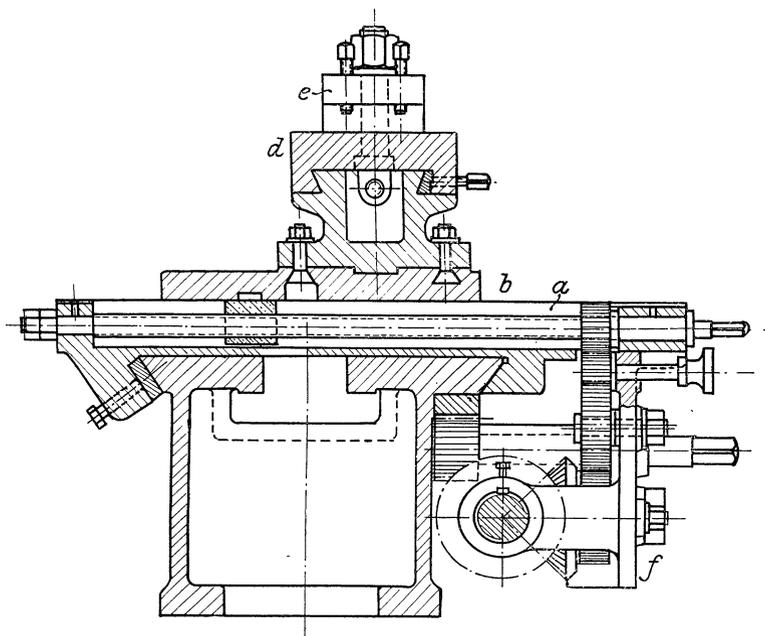
Fig. 305. Deutscher Drehbank-Support.
