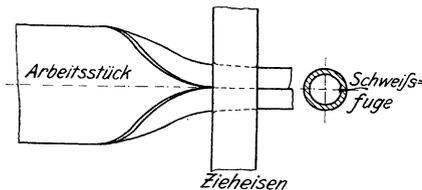
Fig. 147. Gasrohrschweißen.
