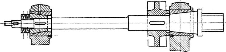
Fig. 299. Lagerung der Arbeitsspindel.
