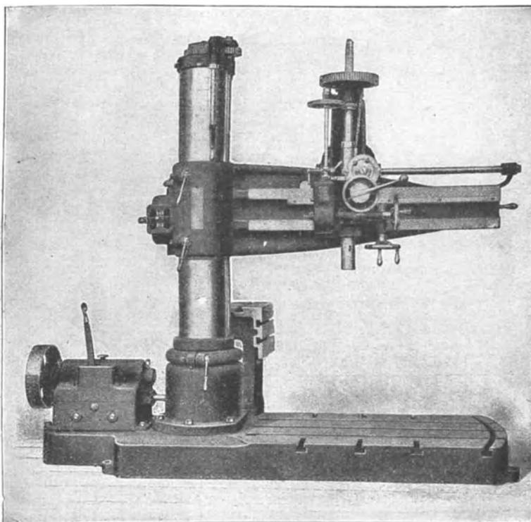
Fig. 332. Bickford-Radial-Bohrmaschine (nach Schlesinger).
