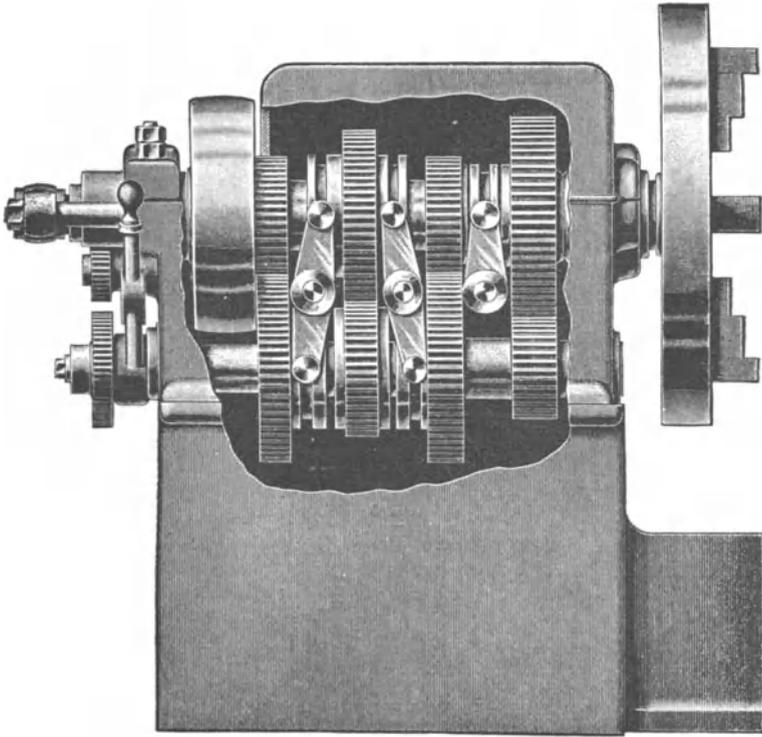
Fig. 298. Rupperts Stufenrädergetriebe.
