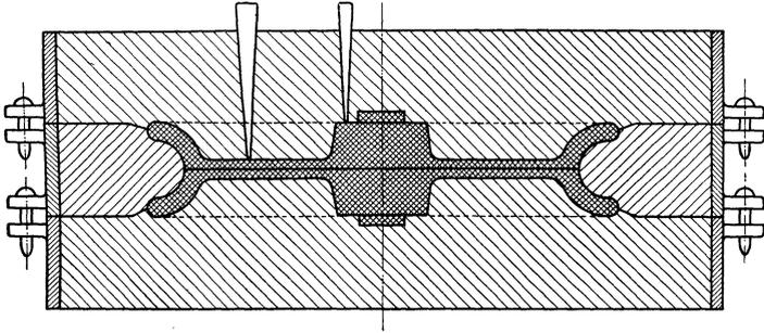
Fig. 40. Form einer Seilrolle im dreiteiligen Kasten.
