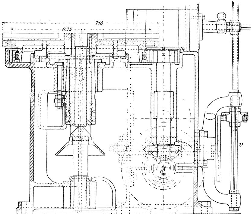
Fig. 317. Schnitt durch ein Dreh- und Bohrwerk
