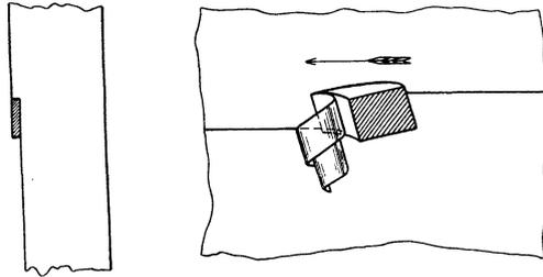
Fig. 156. Schraubenförmiger Span.
