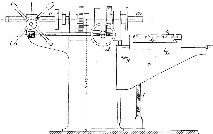
Fig. 335. Ältere Wagerecht-Bohrmaschine für kleine Arbeitsstücke (nach Fischer).
