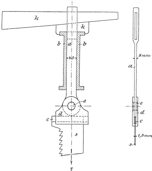
Fig. 399. Sägeblatt-Befestigung (nach Fischer).
