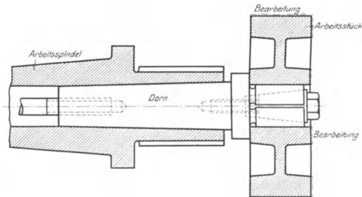
Fig. 206. Freitragender Drehdorn.
