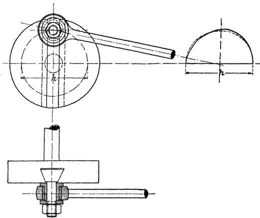
Fig. 222. Einfacher Kurbelmechanismus.
