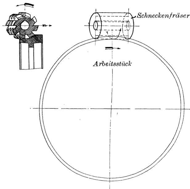
Fig. 359. Das Stirnräderfräsen mit dem Wurmfräser.
