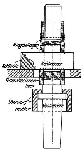
Fig. 403. Messerdorn mit Kehlmesser beim Kehlen.
