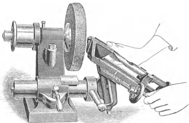
Fig. 363. Spiralbohrer-Schleifmaschine (nach Fischer).
