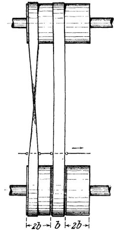
Fig. 263. Riemenscheiben-Wendegetriebe ohne schnellen Rückgang.
