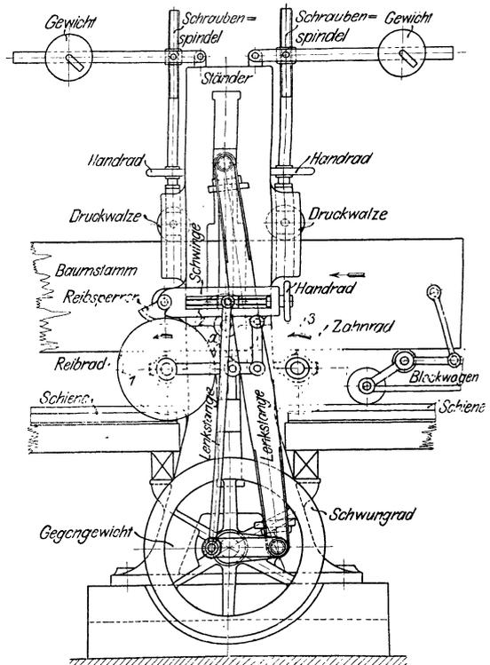
Fig. 401. Vertikalgatter.
