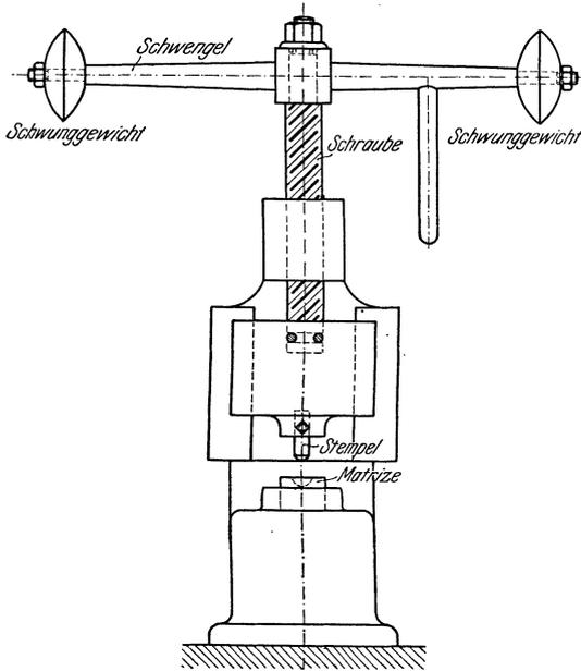
Fig. 127. Schraubenpresse.
