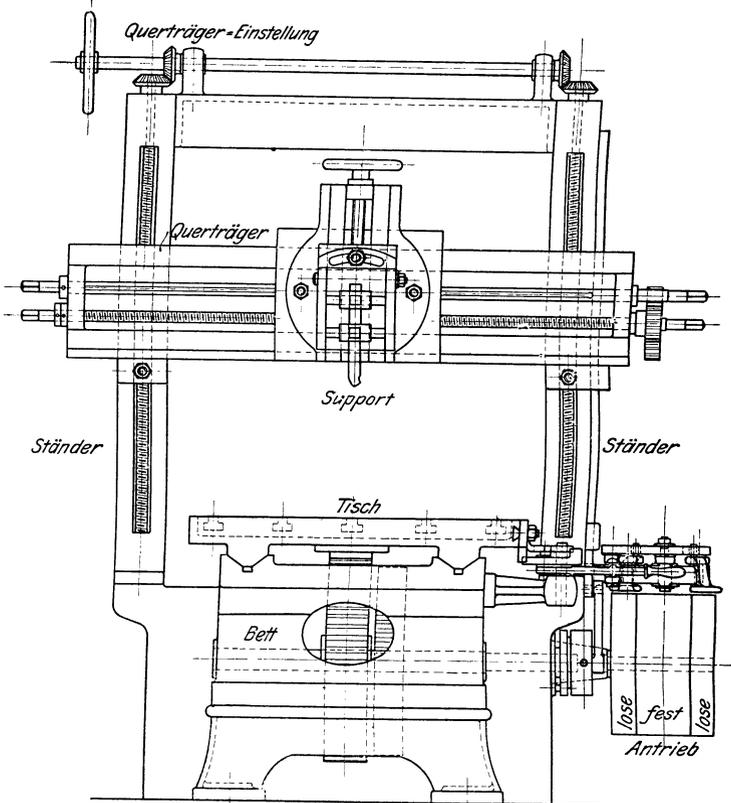
Fig. 372. Tischhobelmaschine (Endansicht).
