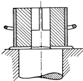
Fig. 91. Angießen eines Walzenzapfens.
