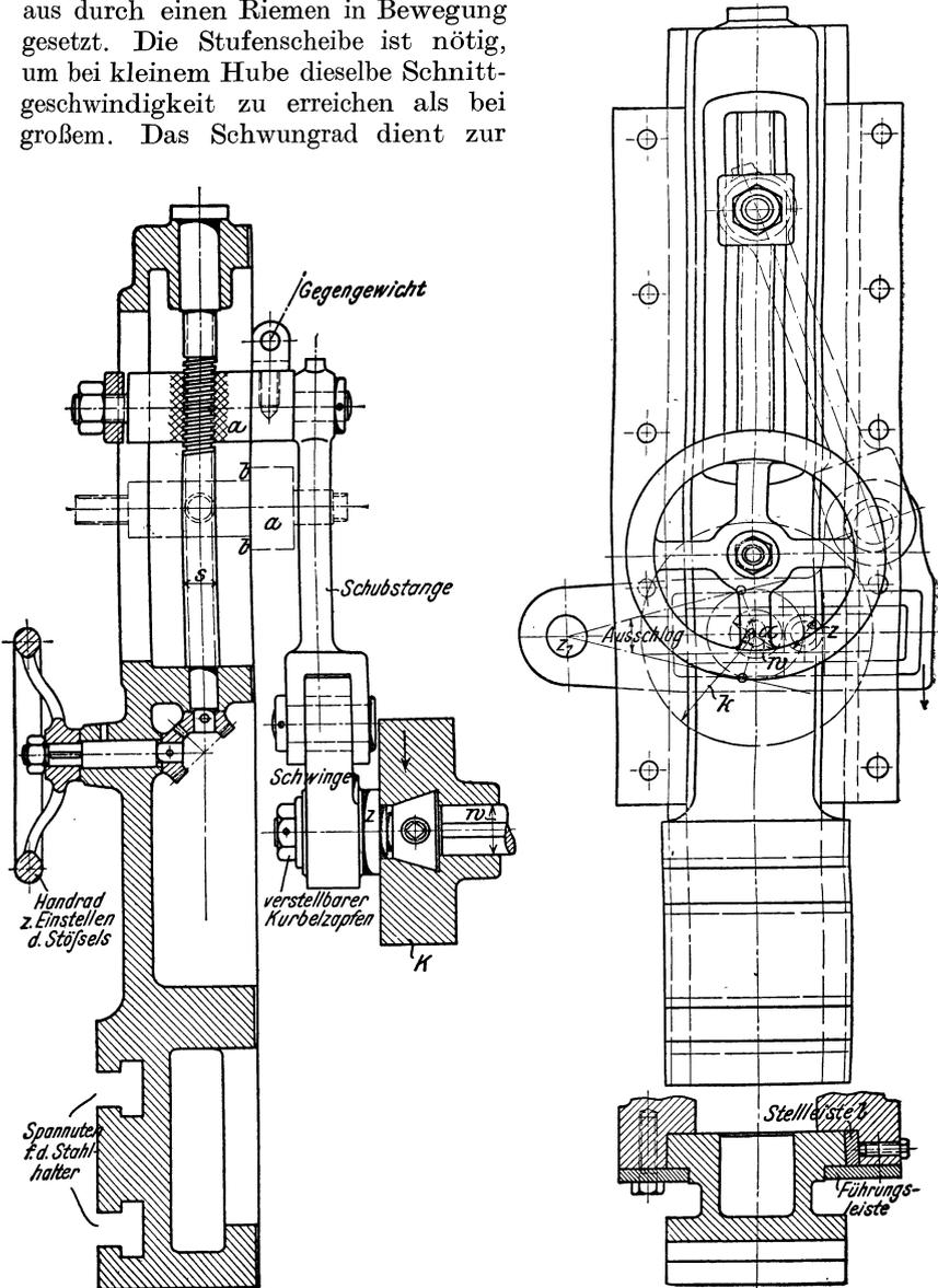
Fig. 387. Stößelantrieb und Führung (nach Hülle).
