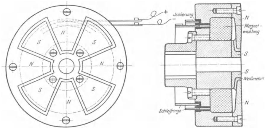
Fig. 200. Elektromagnetische Planscheibe.
