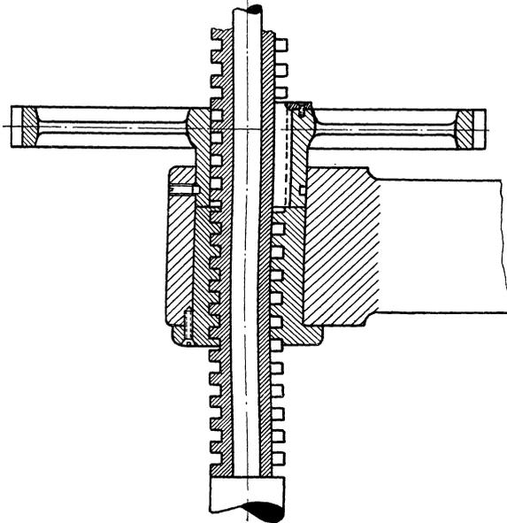
Fig. 247. Schaltmechanismus einer älteren Bohrmaschine.
