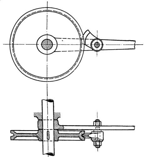
Fig. 236. Klemmschaltwerk.
