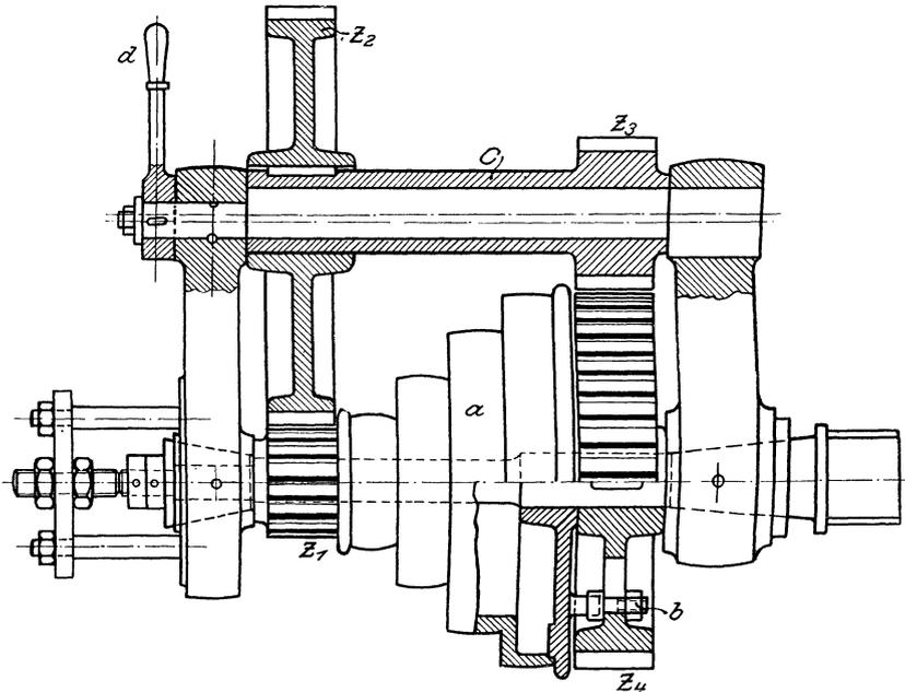
Fig. 215. Stufenscheibenantrieb einer Drehbank.
