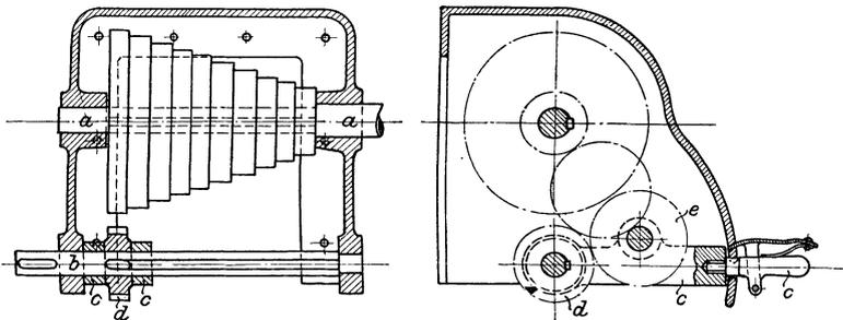
Fig. 246. Nortens Stufenrädergetriebe.
