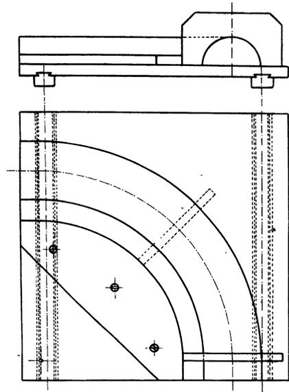
Fig. 44. Ziehen eines halben Krümmernkerns.
