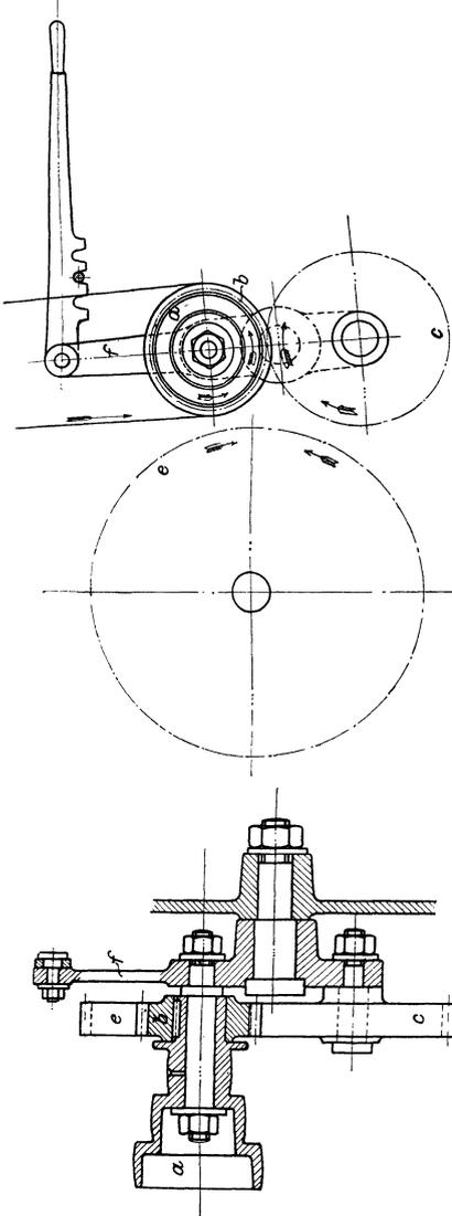
Fig. 277. Stirnräder-Wendegeräbe mit einem Zwischenrade.
