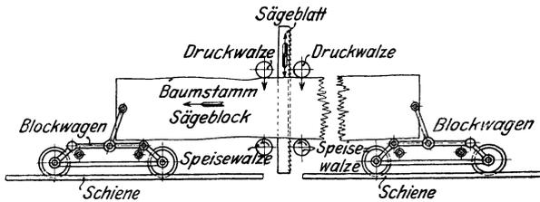
Fig. 400. Schema eines Vertikalgatters.
