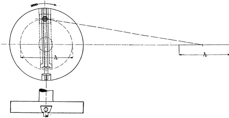
Fig. 223. Einfacher Kurbelmechanismus mit Stellspindel.
