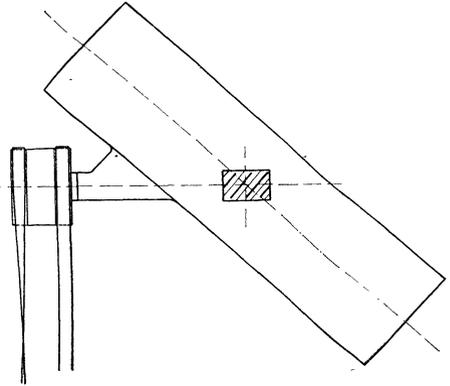
Fig. 266. Hobelmaschine mit Schneckenantrieb. Schiefe Aufstellung.
