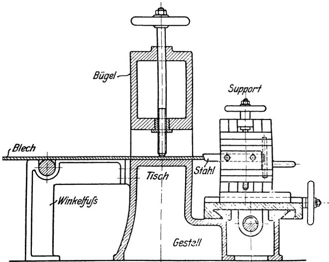
Fig. 394. Blechkanten-Hobelmaschine.
