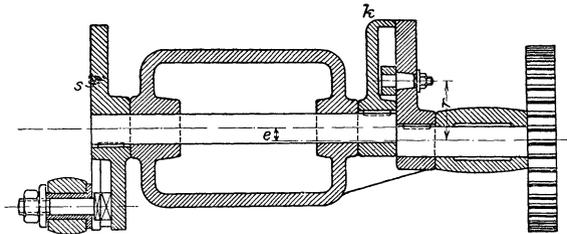
Fig. 230. Andere Ausführung einer umlaufenden Kurbelschleife.
