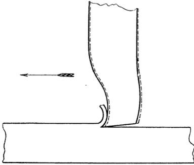
Fig. 159. Das Federn des Stahls.
