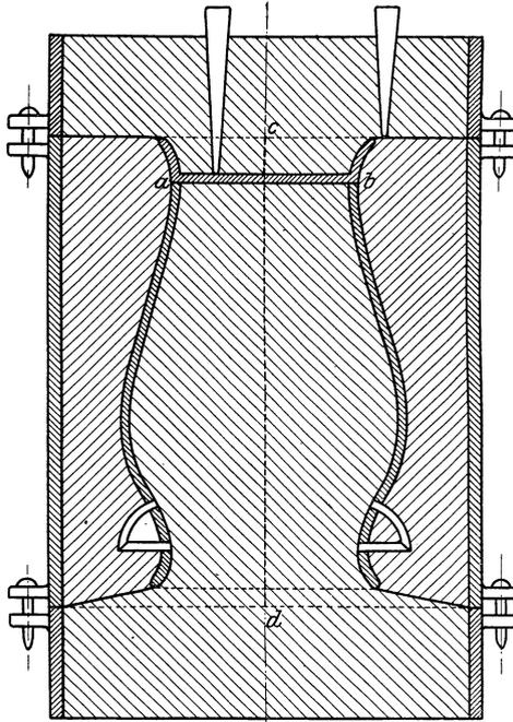
Fig. 50. Form eines bauchigen Topfes ohne besonderen Kern.
