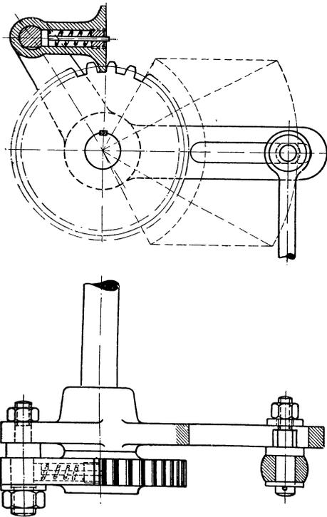
Fig. 235. Zahnschaltwerk.
