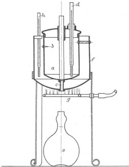
Fig. 14. Flüssigkeitsmesser (Viskosimeter).
