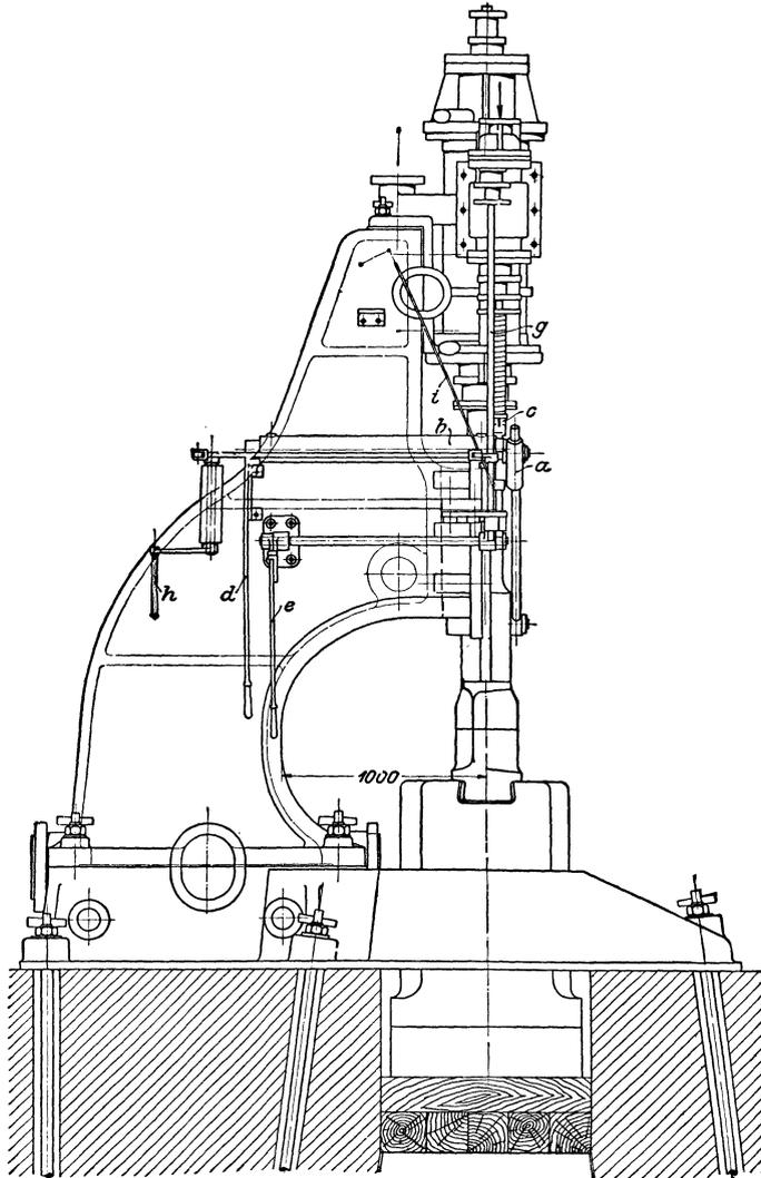
Fig. 125 b. Dampfhammer von J. Banning A.-G. in Hamm (nach Fischer).
