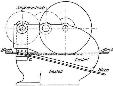
Fig. 393. Schere von Schatz (tiefste Stößelstellung).
