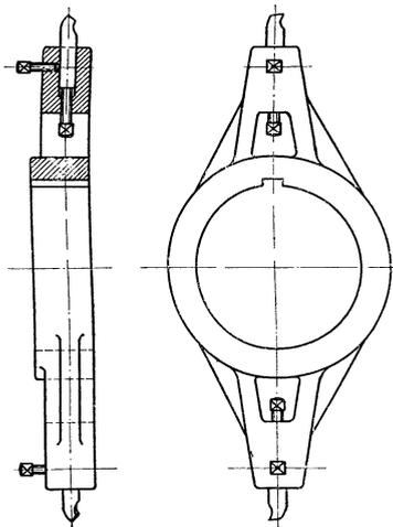
Fig. 347. Größerer Bohrkopf.
