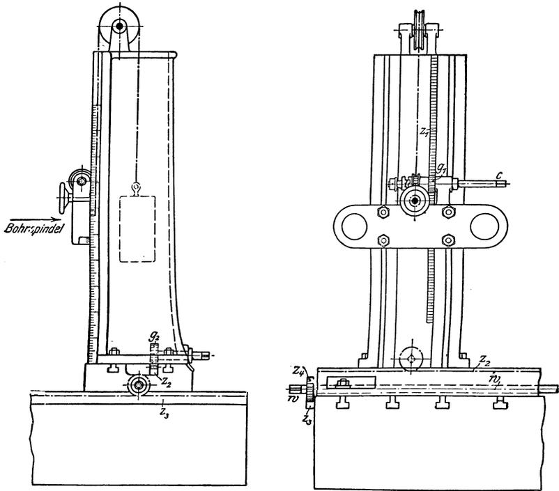
Fig. 341. Setzstock einer Wagerecht-Bohrmaschine (nach Ruppert).
