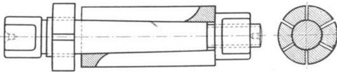
Fig. 205. Expandierender Drehdorn.
