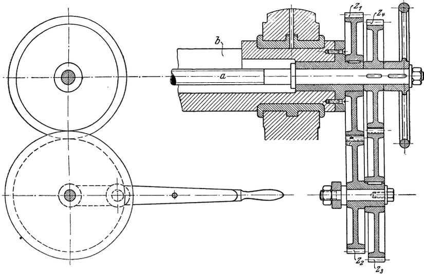
Fig. 251. Differentialrädergetriebe einer Zylinderbohrmaschine.
