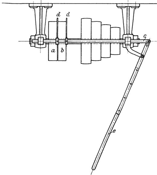
Fig. 281. Deckenvorgelege mit Ausrückhebel.
