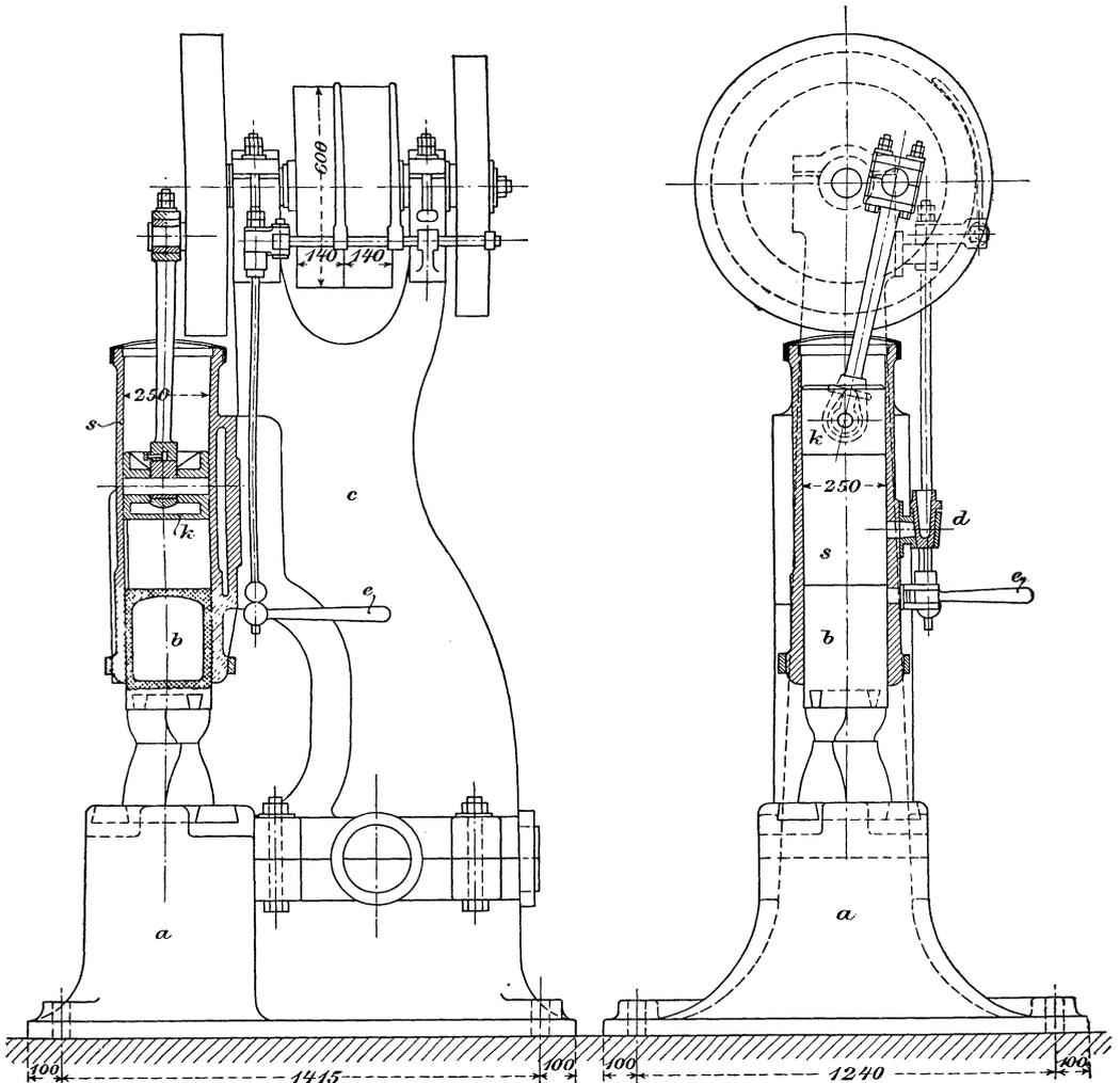
Fig. 120. Luftfederhammer von Breuer, Schumacher & Co. A.-G. in Kalk bei Köln (nach Fischer).
