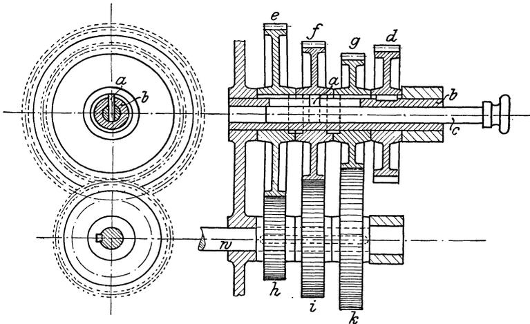
Fig. 244. Stufenrädergetriebe mit Ziehkeil.
