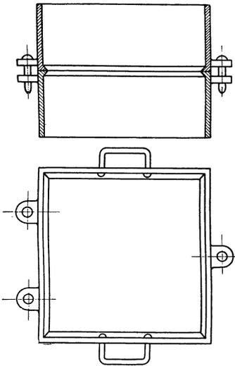
Fig. 33. Kleiner Formkasten.
