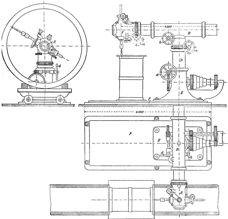
Fig. 329—331. Radial-Bohrmaschine mit runden Führungen (nach Fischer).
