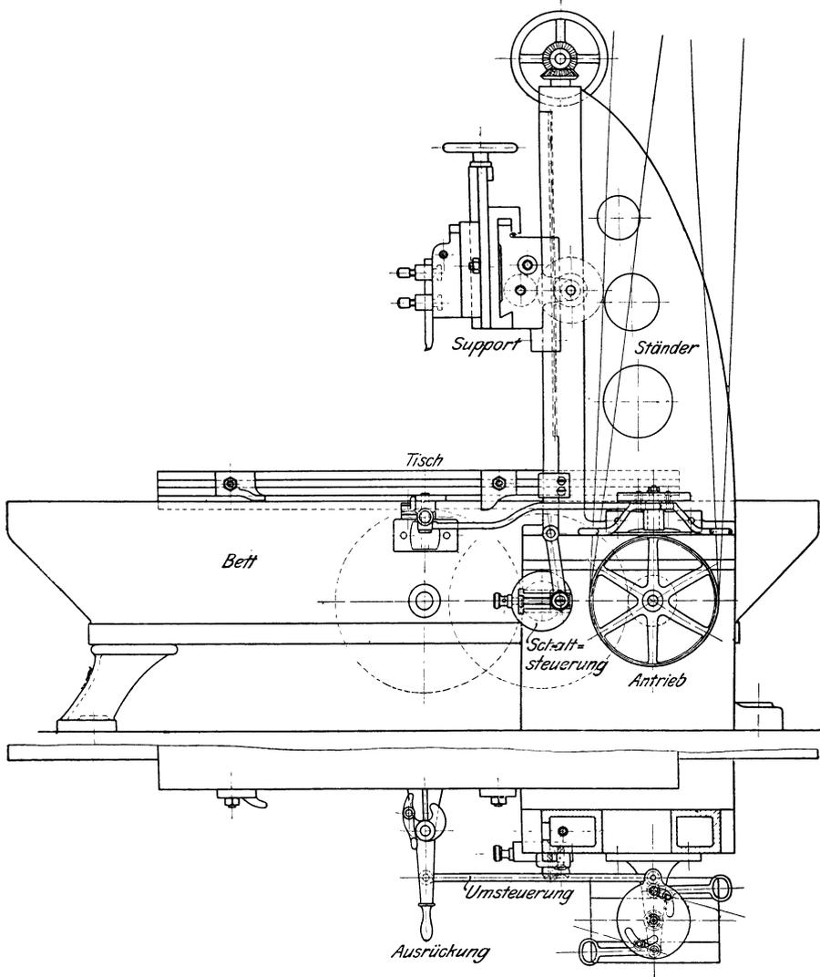
Fig. 373. Tischhobelmaschine (Längensicht).
