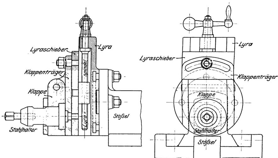
Fig. 381. Support einer Querhobelmaschine.
