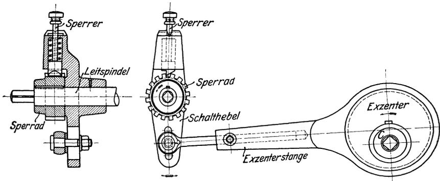
Fig. 383. Zahnschaltewerk einer Querhobelmaschine.
