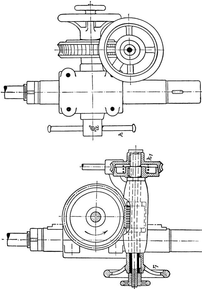
Fig. 325. Bohrspindelschaltung größerer Senkrecht-Bohrmaschinen (nach Ruppert).
