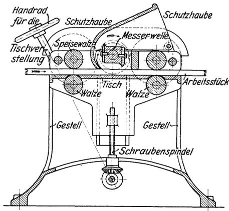
Fig. 408. Dicken- oder Walzenhobelmaschine.
