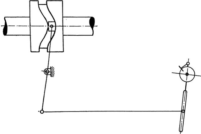
Fig. 241. Nutenwalze und Hebel.
