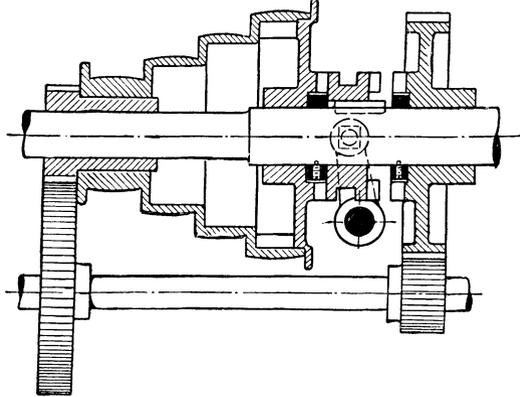
Fig. 287. Rädervorgelege-Ausrückung (nach Ruppert).
