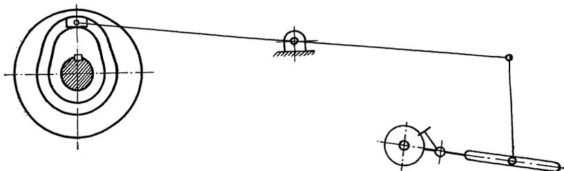
Fig. 239. Nutenscheibe und Hebel.
