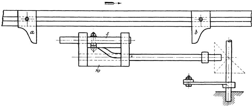
Fig. 274. Umsteuerung mit Nutenwalze.
