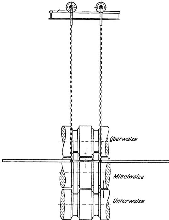
Fig. 137. Heben eines Walzstückes mit Hebeln.
