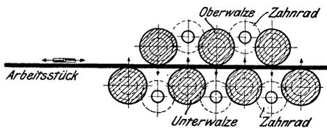
Fig. 142. Schema einer Blechrichtmaschine.
