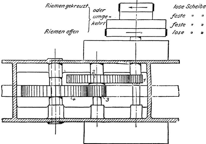
Fig. 377. Hobelmaschinen-Antrieb (nach Ruppert).
