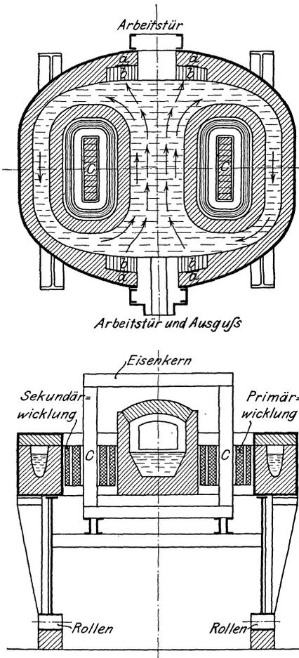
Fig. 87. Röchling-Rodenhauser-Ofen für Wechselstrom.
