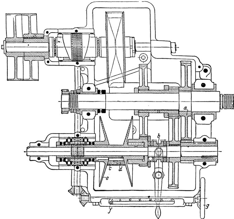
Fig. 216. Keilriemenantrieb einer Drehbank von John Lang & Sons in Jonstone (nach Schlesinger).
