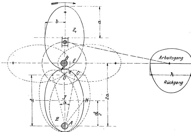
Fig. 231. Schema elliptischer Räder.
