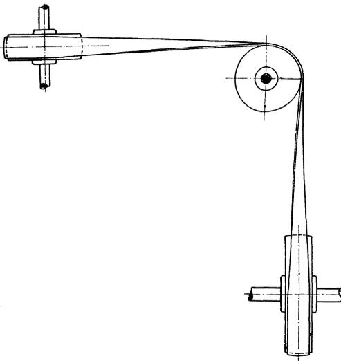
Fig. 218. Riemenantrieb mit Leitrollen.
