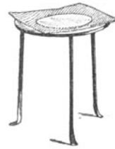
Abb. 82. Dreifuss mit Asbestnetz.
