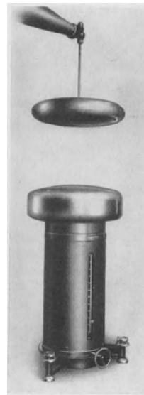
Abb. 210. Elektrostatisches Voltmeter für 1000 kV mit Fernanzeige (Trüb-Tauber) aus ROTH 4 .
