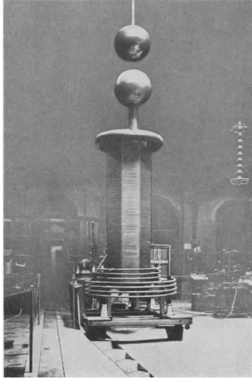
Abb. 23. TESLA-Transformator (nach HOCHHÄUSLER) für 1100 kV und 125 kVA.
