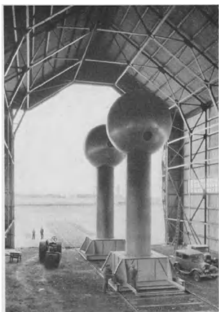
Abb. 53. VAN DE GRAAFF-Generator, aufgestellt in einer Luftschiffhalle (L. C. und C. M. VON ATTA, NORTHRUP, VAN DE GRAAFF). Maximale Spannung zwischen den Kugeln 5 MV, maximale Stromstärke bei nicht angegebener Spannung 2 mA. Die Höhe des Generators beträgt 14 m.
