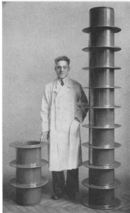
Abb. 157. Aufeinander geschraubte Ringe mit Flanschen aus Philit. Durchmesser des zylindrischen Teils 30 cm, Höhe der einzelnen Zylinder 22 cm.
