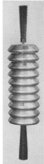
Abb. 165. Reihenschaltung der Widerstände im Metallkörper nach TAYLOR.
