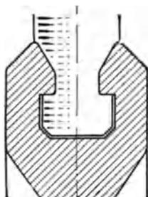
Abb. 117. Der Querschnitt des Radkranzes vor und nach der Zerstörung.
