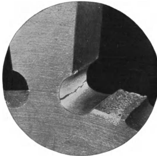
Abb. 33. Bruch eines Belastungszahnes am Modellversuchkörper Nr. 1.
