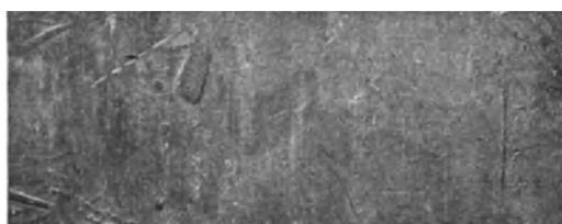
Abb. 285. Das Messingblech nach 800 Stunden
