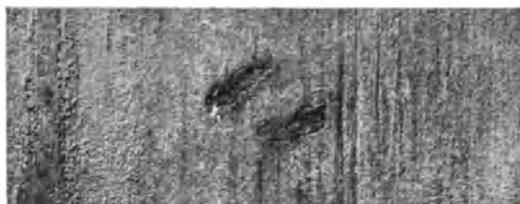
Abb. 284. Das Messingblech nach 800 Stunden
