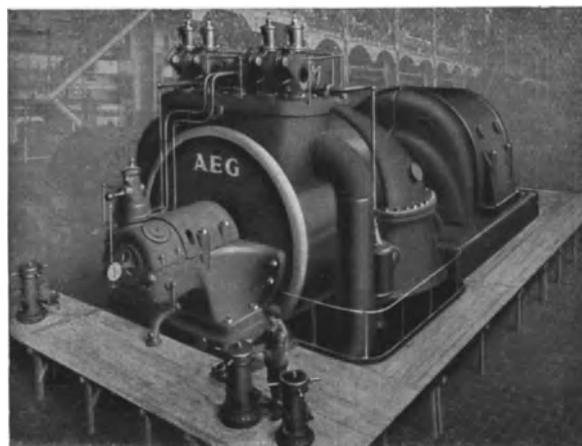
Abb. 370. 50000 kW-Dampfturbine; Ausführung.
