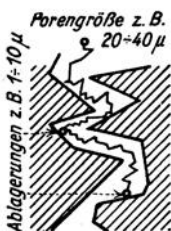
Abb. 570. Adsorptive Wirkung des Filters.
