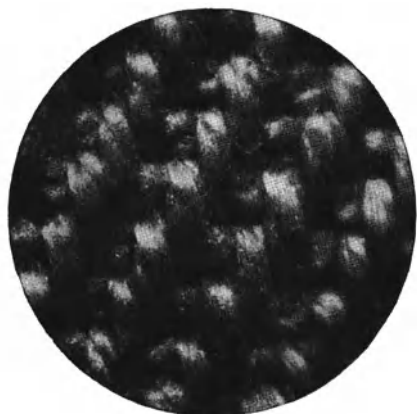
Abb. 575. Dickeres Filtertuch, 40 fach vergr. (Masch.-Fabr. Imperial).
