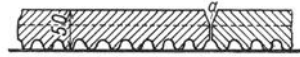
Abb. 690. Filtersteine mit Ablaufrillen auf der Unterseite und Abdichtung durch Säurekitt (a) (Schuler).
