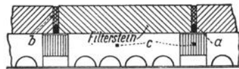
Abb. 692. Abdichtung der Filtersteine mittelst Asbestschnur (a) und Säurekitt (b); c: Unterlagsriegel (Schuler).
