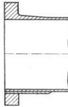
Abb. 825. Mit einer Verstärkung auf- geschweißter Bund.
