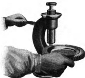
Abb. 86. Französische Kugeldruckpresse für 5-mm-Kugel und 750 kg Druck.
