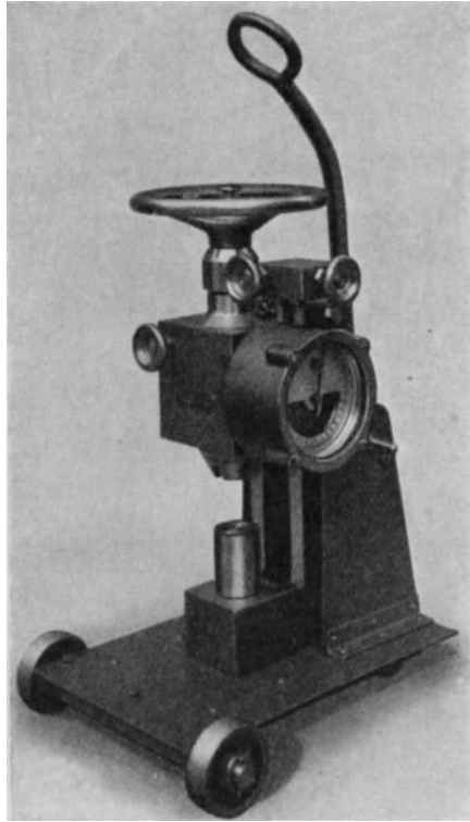
Abb. 114. Transportable Kugeldruckpresse mit Meßdose und Manometer, Bauart Mohr & Federhaff.
