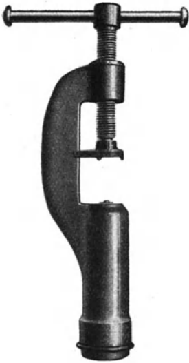
Abb. 93. Leichte französische Brinellpresse für 5 mm Kugeldurchmesser und 750 kg Belastung.
