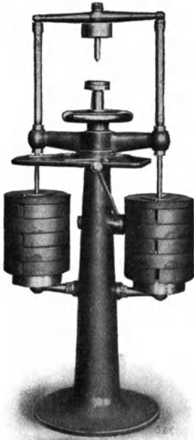
Abb. 67. Kugeldruckpresse für geringe Belastungen von 10–100 kg.
