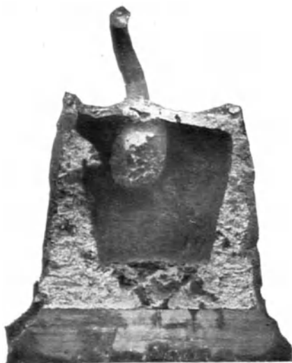
Abb. 46. Verlorener Kopf mit eingesetzten Haken.
