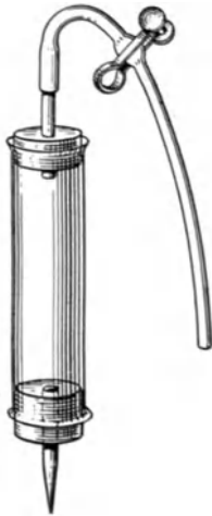
Abb. 14. Vorrichtung zum Gießen von Stearinprobelöckchen.
