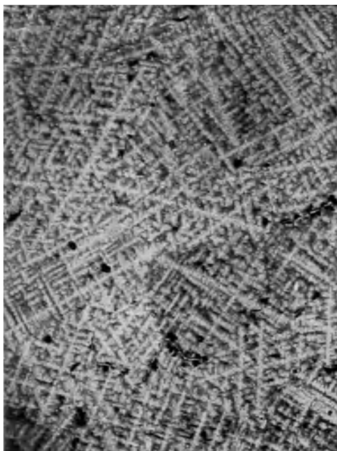
Abb. 54. Ferritstreifen an den Grenzen der Primärkristallite.
