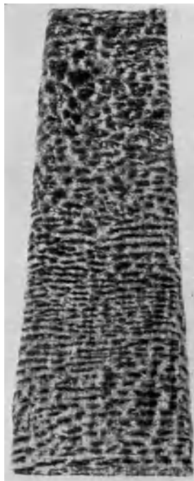
Abb. 11. Oberflächenaussehen eines kaltvergossenen Blockes.
