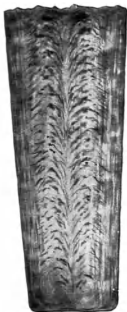
Abb. 43. Schnitt (Zeichnung) durch einen nach Heyn geätzten, verhältnismäßig fehlerfreien Block.
