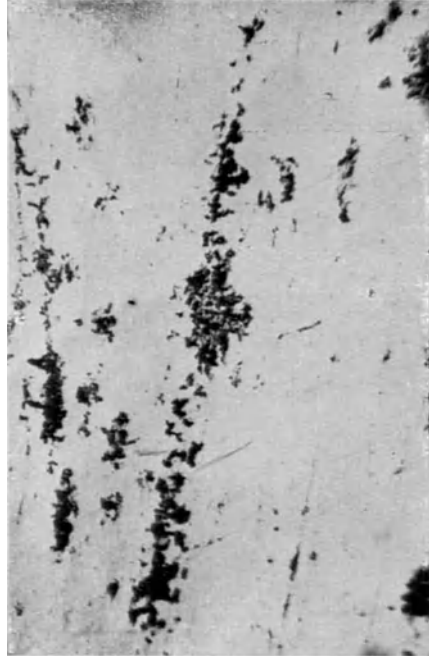
Abb. 53. Tonerdeanhäufungen im Messerstahl.
