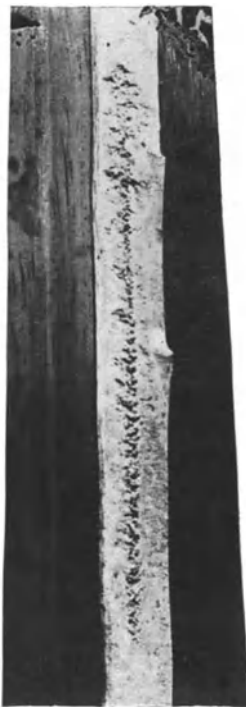
Abb. 40. Lunkerfaden in einem nach Harmet gepreßten Stahlblock.
