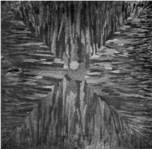
Abb. 1. Geätzter Schnitt durch einen Chromstahlblock.
