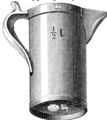
Fig. 6. Flüssigkeitsmaß mit aufgelötetem Boden.
