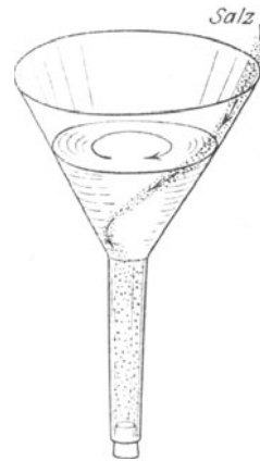
Abb. 14. Salzabscheidung in einem Trichter.
