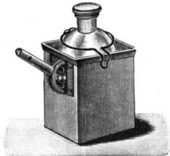
Abb. 25. Entnahmebecher nach J. DINSE.
