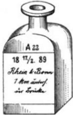
Abb. 3. Glasflasche für Wasserproben.
