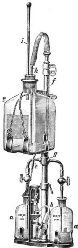
Abb. 20. Wasserentnahmeapparat nach SPITTA-IMHOFF.
