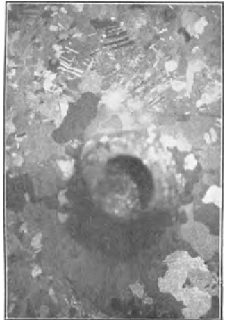
Nr. 3. gegossen, gelocht, auf 175° erhitzt.
