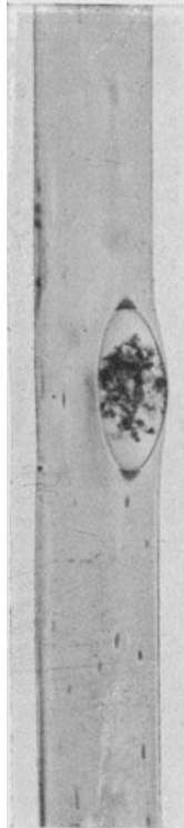
Abb. 98. Fehlerhafte Kupferseide mit fester Einlagerung, die ihrerseits auch Einlagerungen (dunkel, flockig) enthält. Vergr. 400.
