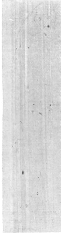
Abb. 44. Dieselbe Faser wie in Abb. 43, Faserachse jedoch senkrecht zur Schwingungsrichtung des Nicols. Infolge der in dieser Lage annähernd gleichen Lichtbrechung mit dem Balsam ist die Faser nahezu unsichtbar. Vergr. 250.
