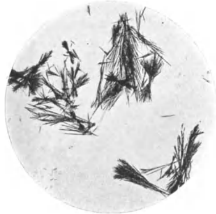
Abb. 89. Mikrochemischer Nachweis von Zucker (Traubenzucker usw.) mit salzsaurem Phenylhydrazin und Natriumazetat-Glyzerin. Osazonreaktion. Vergr. 115.
