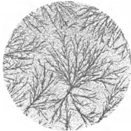
Abb. 92. Indigokristalle aus einem alchinesischen Seidengewebe auf ein Deckglas sublimiert. Bezeichnung wie in Abb. 42. Die großen spießigen Kristalle bestehen aus Indigrubin, die zahlreichen kleinen Kristalle des Untergrundes aus Indigblau. Vgl. auch Abb. 35. Vergr. 130.
