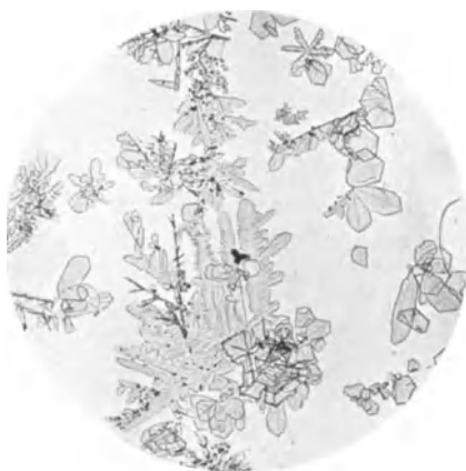
Abb. 76. Mikrochemischer Nachweis von Wolfram als Thallowolframat ( \text{Tl}_2\text{WO}_4 ). Vergr. 115.
