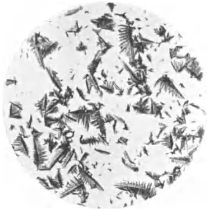
Abb. 77. Mikrochemischer Nachweis von Zink als Merkurithyocyanat [\text{Zn}(\text{CNS})_2\text{Hg}(\text{CNS})_2] . Vergr. 115.
