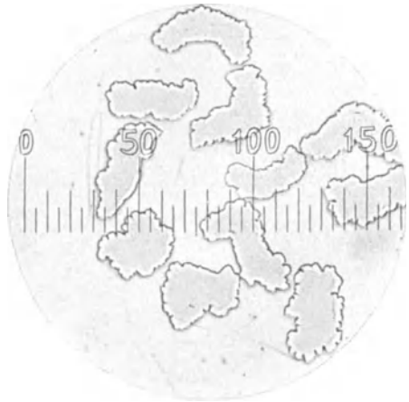
Abb. 22. Viskoseseide, Querschnitte. Vergr. 335.
