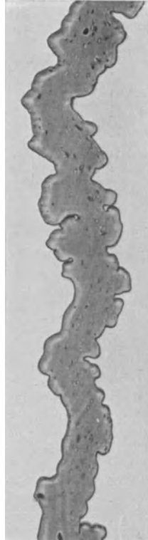
Abb. 56. Querschnitt durch den mittleren Teil eines Viskosebändchens. Mit freiem Auge betrachtet, zeigt dieses Bändchen einen prachtvollen Hochglanz und große Deckkraft. Man beachte die auffallend grobe Kerbung des Schnittes. Vergr. 463.
