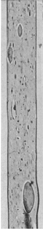
Abb. 97. Fehlerhafte Kupferseide mit feineren und größeren Verunreinigungen fester Art; letztere auffallend in die Länge gezogen. Vergr. 400.
