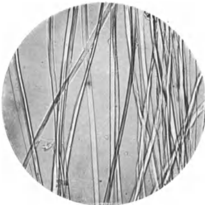
Abb. 72. Echte Seide in Anilin nach Einschaltung eines Nicols. Polarisations-ebene parallel zur Faserlängsrichtung. Infolge des beträchtlichen Unterschiedes in der Lichtbrechung der Faser ( n = 1,54 ) und des Anilins ( n = 1,59 ) tritt die ungefärbte Seidenfaser im mikroskopischen Bilde sehr deutlich hervor. Vergr. 100.
