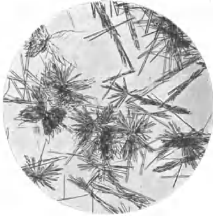
Abb. 78. Mikrochemischer Nachweis von Kalzium bzw. Schwefelsäure als Kalziumsulfat ( \text{Gips}, \text{CaSO}_4 + 2\text{H}_2\text{O} ). Vergr. 115.
