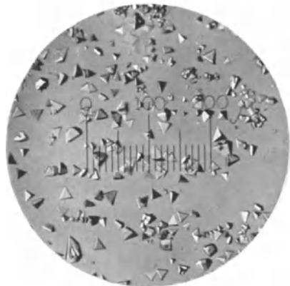
Abb. 88. Mikrochemischer Nachweis von Natrium in der Asche von Kernseife als Natriumuranylazetat [\text{Na}_2\text{C}_2\text{H}_3\text{O}_2 \cdot \text{UO}_2(\text{C}_2\text{H}_3\text{O}_2)_2] . Vergr. 115.
