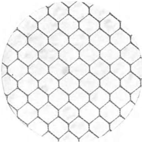
Abb. 54. Künstlicher Tüll mit eingepprägten, unter sich parallelen Rillen, die den sonst unschönen „Speckglanz“ aufheben. Sie wirken optisch im selben Sinn wie die Preßfurchen beim Seidenfinish. Vergr. 10.
