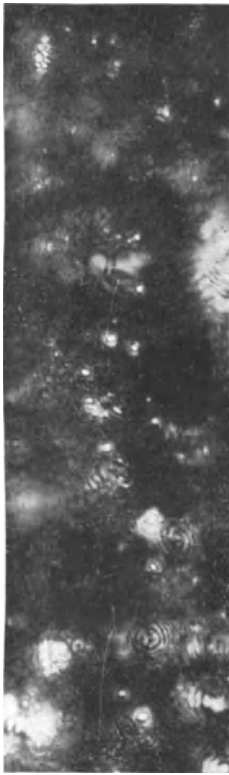
Abb. 64. Ultrastruktur der Nitroseide. Vergr. 2500.
