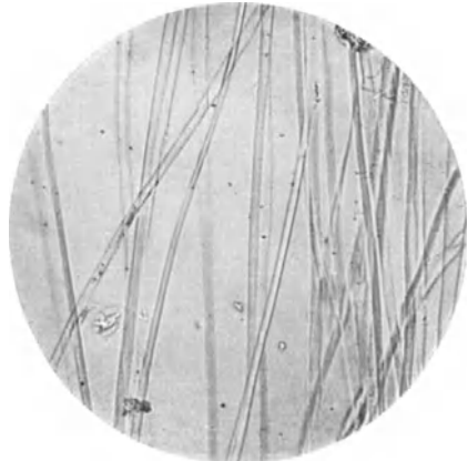
Abb. 73. Dieselbe Stelle wie in Abb. 72, jedoch Polarisationsebene des Nicols senkrecht zur Faserlängsachse. Wegen des in dieser Lage fehlenden Unterschiedes in der Lichtbrechung der Faser und des Anilins hebt sich die Seide fast gar nicht vom Untergrund des mikroskopischen Gesichtsfeldes ab. Vergr. 100.
