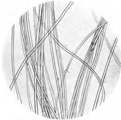
Abb. 71. Kupferseide nach dem Streckspinnverfahren hergestellt. Diese Seide kommt in ihrem mittleren Durchmesser der echten Seide gleich. Die Breite der Faser ist demnach nicht immer ein untrügliches Merkmal zur Unterscheidung von natürlicher und künstlicher Seide. Vergr. 100.
