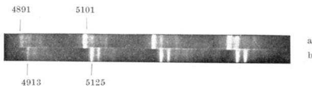
Fig. 27. a) Fluoreszenzspektrum des Uranyl-natriumsulfats } bei 80°.
