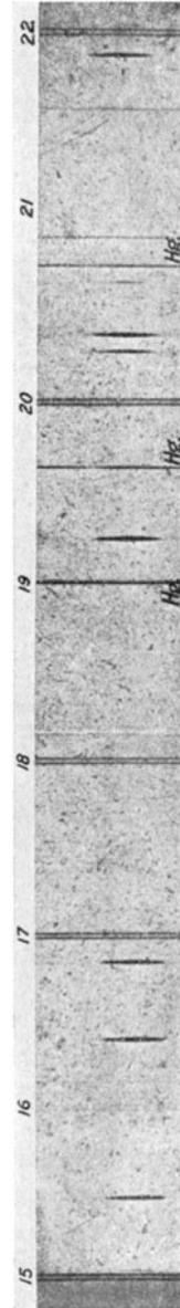
Fig. 6. 15.—22. Ordnung im Resonanzspektrum des Joddampfes bei Erregung mit der Linie 5461.
