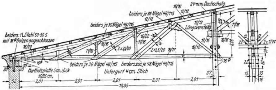
Abb. 98. Binderkonstruktion des Seitenschiffs einer Messehalle.
