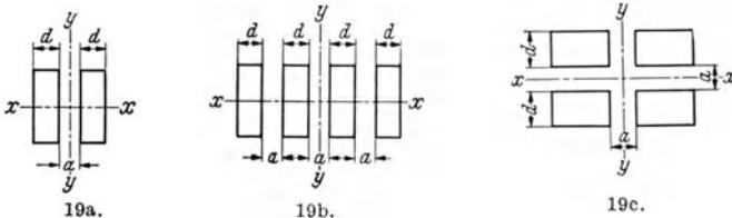
Abb. 19a, 19b und 19c. Mehrteiliger Druckquerschnitt.
