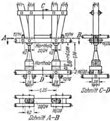
Abb. 131. Anschluß der Pfosten und Streben an eine zweiteilige Schwelle.
