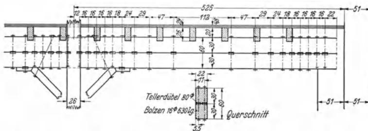
Abb. 63. Verdübelter Balken als Deckenunterzug. Sackspeicher eines Kaliwerkes.
