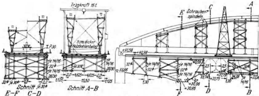
Abb. 151. Aufstellgerüst für eine Reichsautobahnbrücke.
