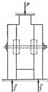
Abb. 21. Probekörper zu Druckversuchen mit Holzverbindungen.
