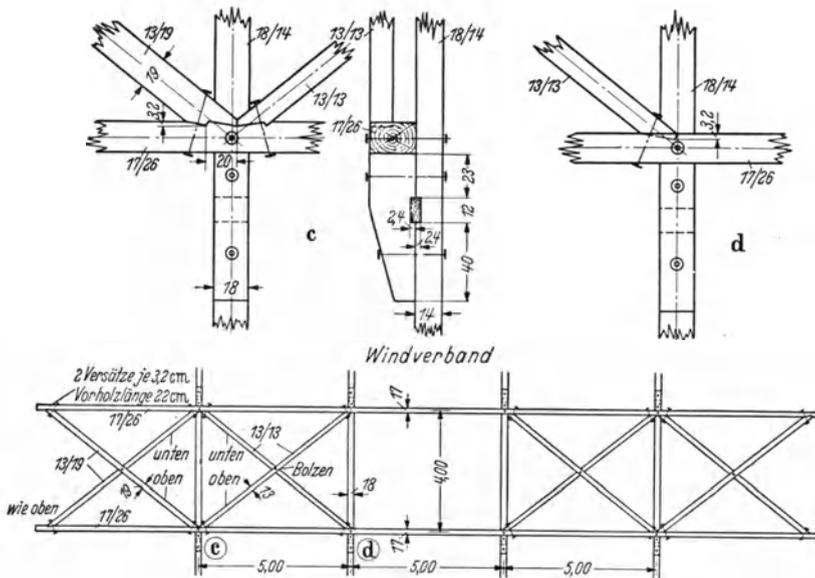
Abb. 82a. Windverband zu Abb. 82.
