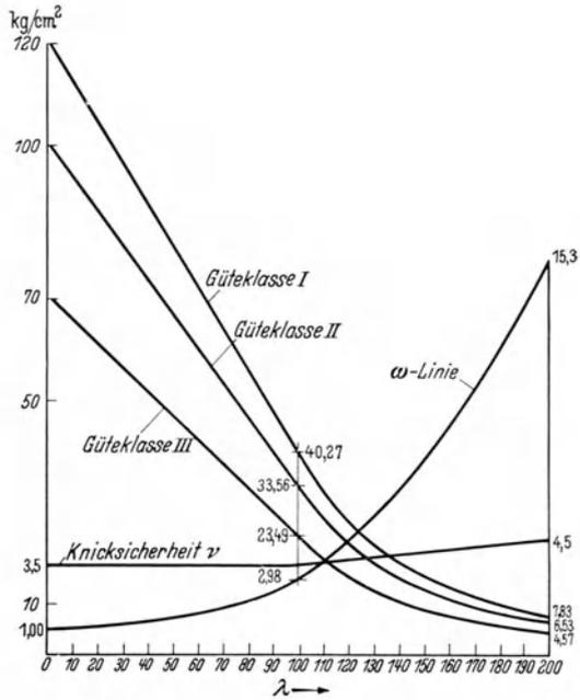
Abb. 18. Linien der zulässigen Druckspannung  $\sigma_{d\text{zul}}$ , der Knicksicherheit  $\nu$  und der Knickzahl  $\omega$  für Eiche und Buche.
