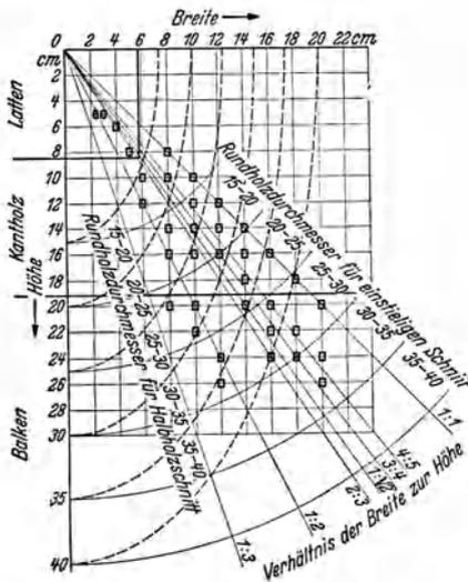
Abb. 1. Zeichnerische Darstellung der in DIN 4070 genormten Querschnitte.
