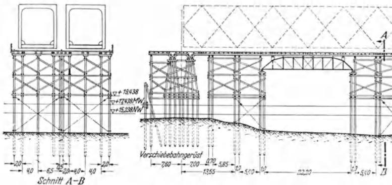
Abb. 149. Aufstellgerüst der Eisenbahnbrücke über einen breiten Strom.
