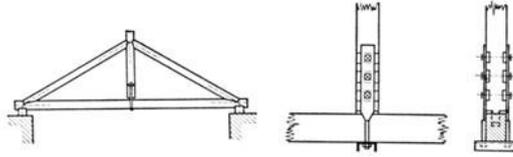
Abb. 64. Einfaches Hängewerk. Abb. 64a. Anschluß der Hängesäule an den Streckbalken.
