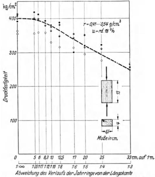
Abb.7. Druckfestigkeit von Fichtenholz in Abhängigkeit vom Faserverlauf.
