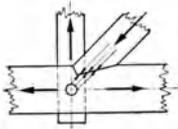
Abb. 11. Scheinbare Zugwirkung senkrecht zur Faser (nach Seitz).
