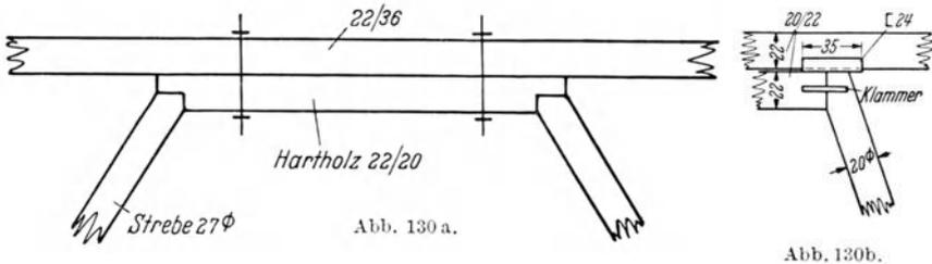
Abb. 130a u. 130b. Verschiedenartige Ausbaumöglichkeiten des Anschlusses einer Strebe an ein einteiliges Kranzholz.
