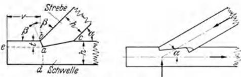
Abb. 54a. Einfacher Versatz. Abb. 54b. Doppelter Versatz
