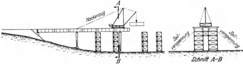
Abb. 150. Schematische Darstellung eines Freivorbaugerüsts.
