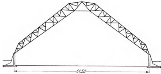
Abb. 107. Bindersystem einer Salzlagerhalle.
