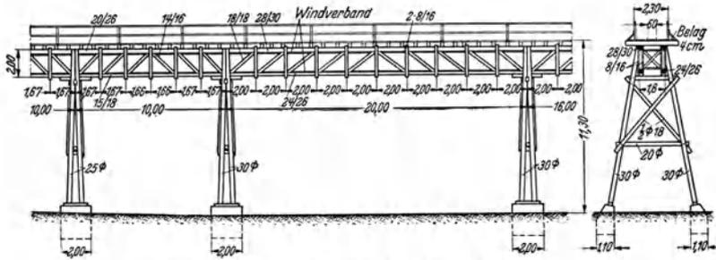
Abb. 125. Transportbrücke einer Zementfabrik.
