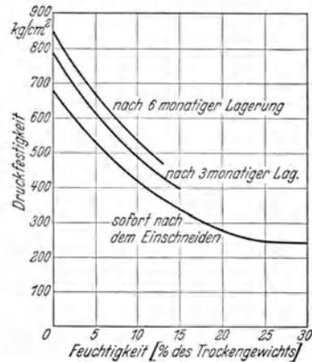
Abb. 5 Druckfestigkeit von Fichtenholz in Abhängigkeit von der Zeit nach dem Einschneiden.
