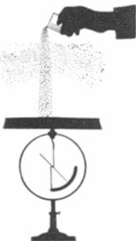
Abb. 423. Trennung von Elektrizitätsträgern durch verschiedene Fallgeschwindigkeit (feines Bleischrot und Schwefelstaub). Ein seitlicher oder aufwärts gerichteter Luftstrom verbessert die Trennung erheblich.
