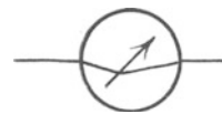
Abb. 22. Zeichenschema eines Hitzdrahtstrommessers. Wird späterhin auch bei solchen Hitzdrahtstrommessern angewandt, die als Spannungsmesser oder Voltmeter umgeichtet sind.
