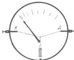
Abb. 21. Schema eines Hitzdrahtstrommessers. Man denke sich den Faden zwischen der gespannten Spiralfeder und dem Hitzdraht KA um die Achse des Zeigers herumgeschlungen.
