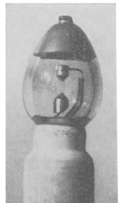
Abb. 1. Osram-Lampe Hg B 500 W.
