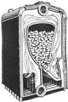
Fig. 154. Vollarkessel der Buderus'schen Eisenwerke, Wezlar, für Brikettfeuerungen mit unterem Abbrand.
