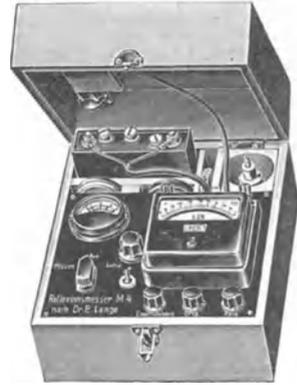
Abb. 34. Apparatur für Hautreflektionsmessungen. (Nach IANGE.)
