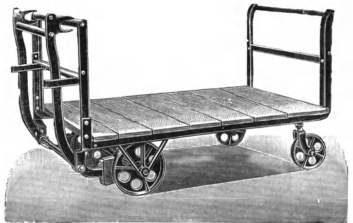
Bei der für Lagerhäuser üblichen Bauart derartiger Wagen fehlt meist eine Kopfwand, Fig. 11, bzw. es ist selbst die vorhandene abnehmbar. Besonders beliebt sind für 1500 kg Tragkraft als Abmessungen für die Länge der Beladefläche 1600 mm, für deren Breite 1100 mm und für die Höhe der Kopfwand 700 mm. Auch mit Bremsen sind solche Wagen oft ausgerüstet, beim Vorschieben wird die Hebelbremse des Fahrzeuges selbsttätig gelöst, Fig. 12, beim Stillstand tritt
