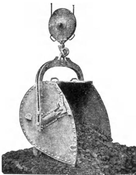
beweglichen Abschluß und im Innern eine leicht auswechselbare, 25 mm starke gewalzte Stahl- oder Panzerguß-Platte, welche allein dem Verschleiß unterliegt und rasch ersetzt werden kann. Bei Verwendung dieser Klappe werden besondere Hartguß-Bogenstücke nicht erforderlich, Fig. 4. — Fig. 7 A zeigt ein Bogenstück aus Gußeisen (vergl. Fig. 5) mit einge-
