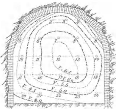
Abb. 442. Kurven gleicher Wettergeschwindigkeit in einem Streckenquerschnitt.
