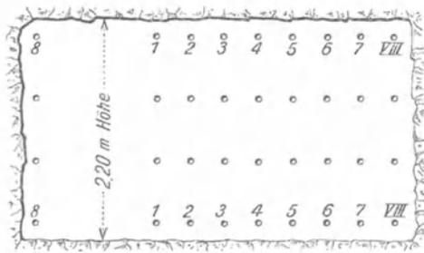
Abb. 267. Schießverfahren beim Streckenbetrieb auf Kalisalzgruben.
