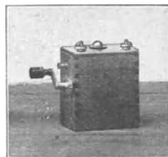
Abb. 218. Magnetelektrische Kurbelmaschine.
