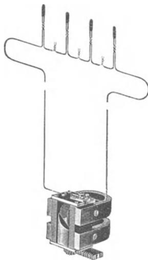
Abb. 217. Magnetelektrische Zündmaschine ohne Gehäuse.
