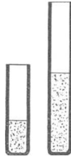
Abb. 212. Sprengkapseln Nr. 3 und 8.
