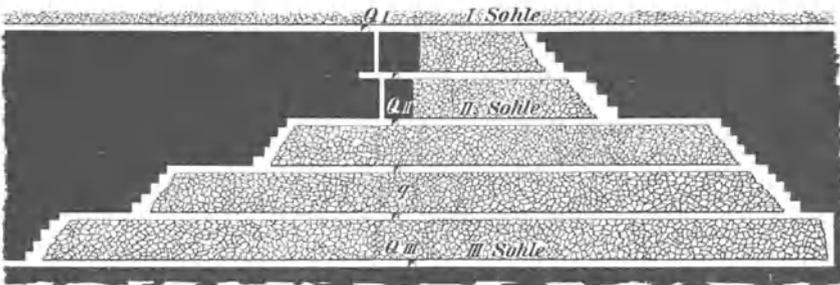
Abb. 336<sup>1)</sup>. Strebbau mit fremden Bergen bei steilem Einfallen.
