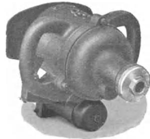
Abb. 164. Ansicht der Freihand-Drehbohrmaschine der Siemens-Schuckertwerke.
