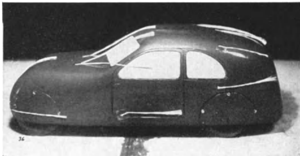
Abb. 103. Strömungsuntersuchung mit Fadensonden.
