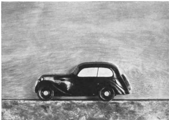
Abb. 102. Aufnahme von Strömungsbildern in Wasser.
