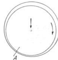
Abb. 57. Gegenseitige Lage von Welle und Lagerschale; kleinste Dicke des Ölfilmes an der Stelle A .
