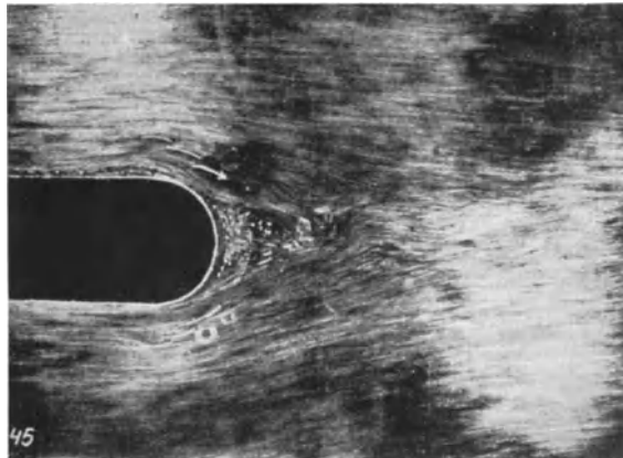
Abb. 111. Verkleinerung des Wirbelgebietes durch Hilfsleitflächen.
