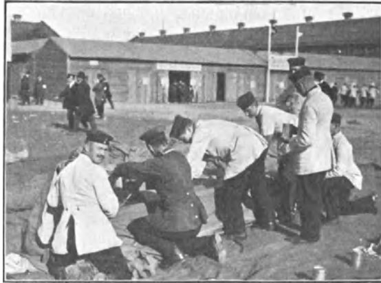
Abb. 82. Vorbereitungen zur Füllung. Leben der Reißbahn. (*)
