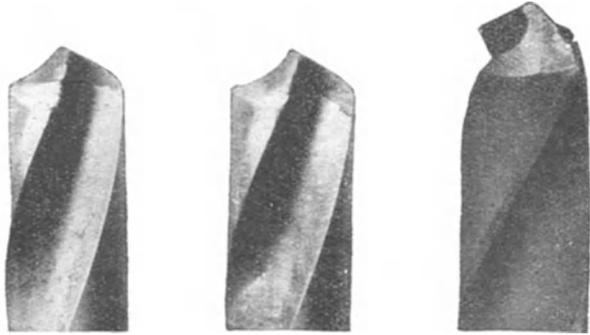
Fig. 49. Beschädigte Bohrer.
