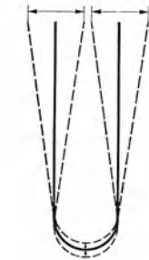
Abb. 212. Schema der Stimmgabelschwingung.
