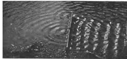
Abb. 207. Beugung von Wasserwellen an einem Loch. (Nach GRIMSEHL.)
