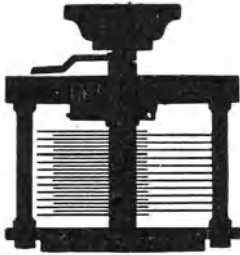
Abb. 269. Drehkondensator. (Aus POHL: Elektrizitätslehre.)
