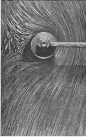
Abb. 161. Strömung um einen rotierenden Zylinder. (Nach PRANDTL.)
