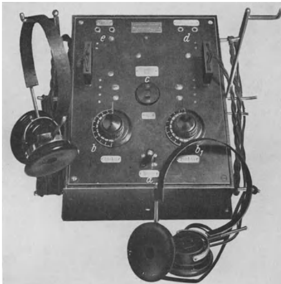
Abb. 10. Gerät zur HINSBERGSchen Modifikation II des BLOCH-STENGERschen Versuches. a Hebel zur Beschickung der beiden linken, der beiden rechten und aller Kopfhörer mit Sprechstrom; b , b , Rheostaten zur Regelung der Tonstärke in den linken bzw. rechten Kopfhörern; c Hebel zur Einschaltung des Summers; d Stechkontakte zur Einschaltung von Otoaudion oder Telephon unter Ausschaltung des Summers; e Stechkontakte zur Einschaltung eines Akkumulators an Stelle des Netzstromes. (Aus HINSBERG: Z. Hals- usw. Heilk. 32.)
