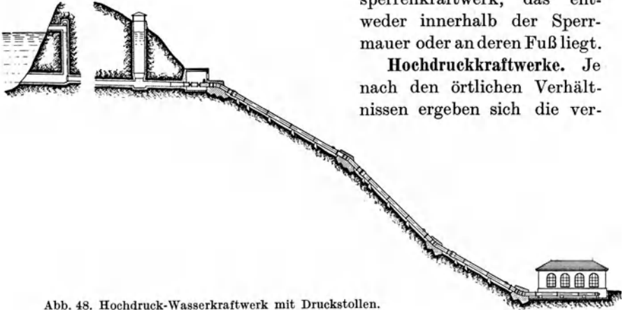
Abb. 48. Hochdruck-Wasserkraftwerk mit Druckstollen.
