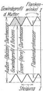
Abb. 136. Bestimmungsgrößen der Gewinde.
