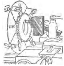
Abb. 86. Ausrichten eines Zahnrades auf der Planscheibe.
